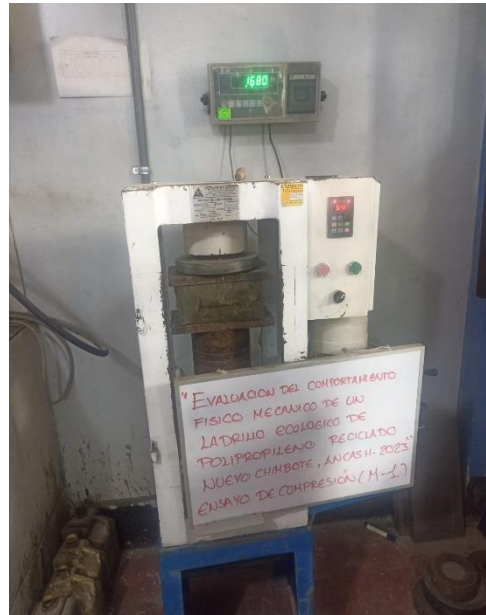
Foto 07, 08, 09 y 10: Realización de ensayo de compresión a muestras de ladrillo de polipropileno empleando máquina de compresión axial.
