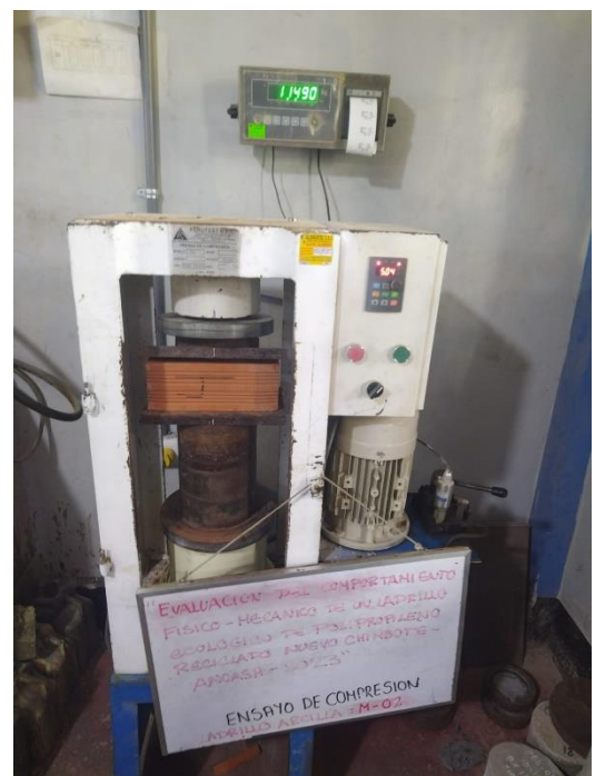
Foto 17, 18, 19 y 20: Realización de ensayo de compresión a muestras de ladrillo de polipropileno empleando máquina de compresión axial.
