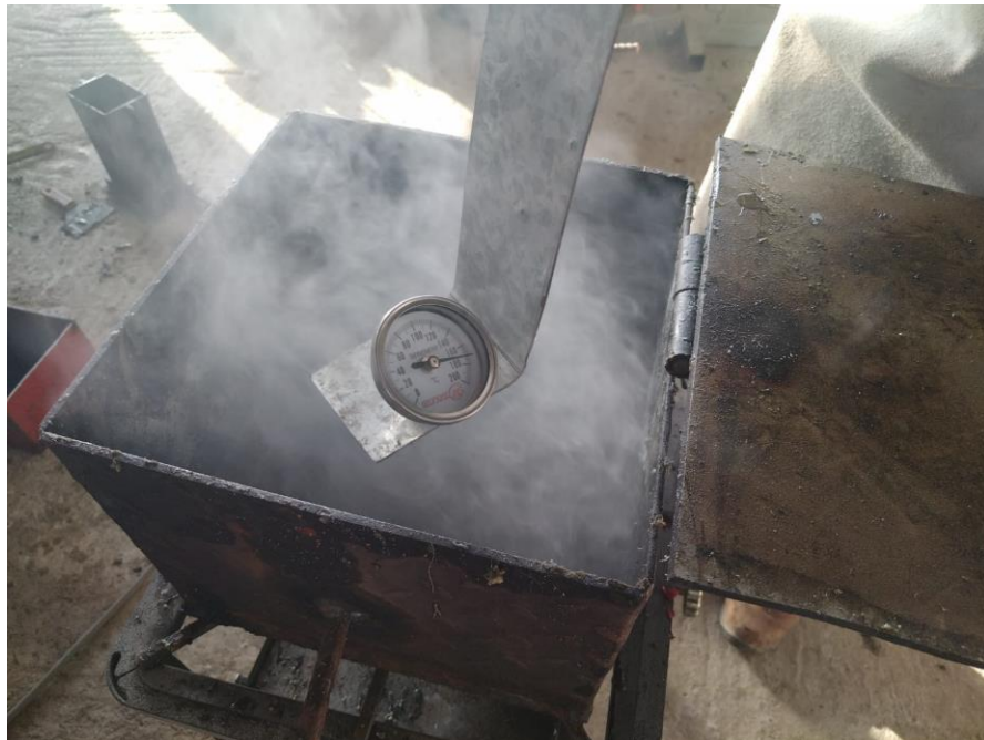
Foto 28, 29 y 30: se observa el proceso de armado de los moldes para fundir, así mismo vertimiento de aceite dentro de la olla para la mezcla, también con apoyo del termómetro se controla la temperatura alrededor de 170 a 200 grados para fundir el plástico.
