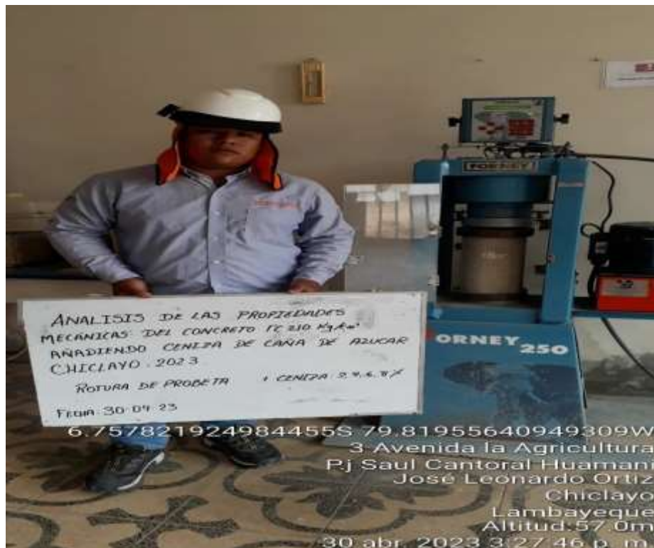
Rotura de muestras a los 7 días de curado
