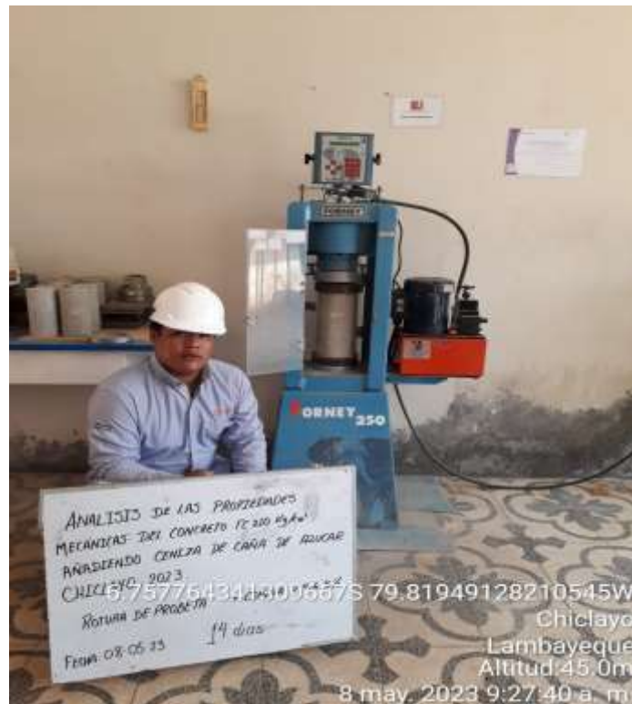
Rotura de muestras a los 14 días de curado
