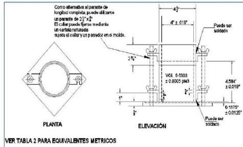
Figura 1: Molde cilíndrico de 4,0 pulg
