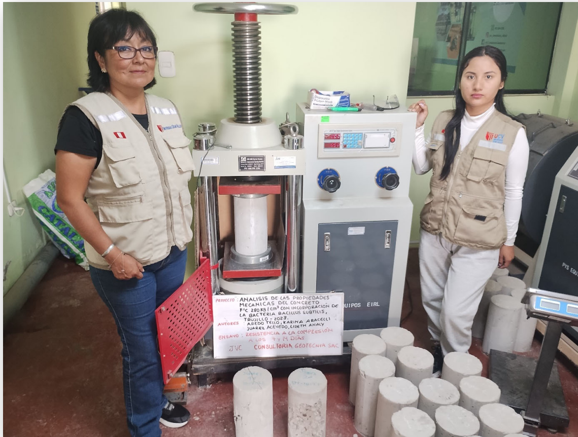
Imagen 17. Rotura de cilindros de concreto
