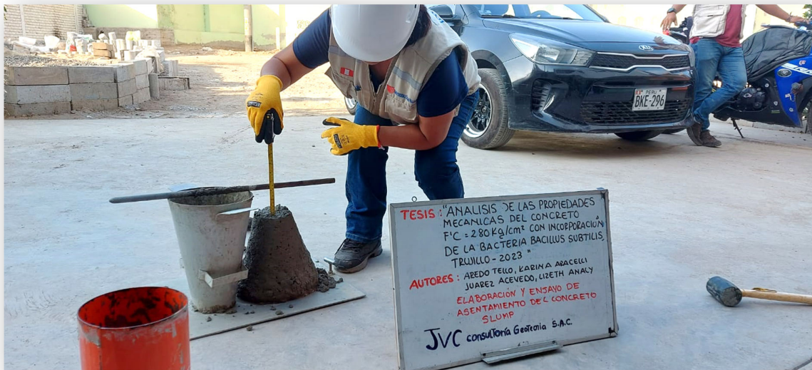
Imagen 15. Compactando el concreto
