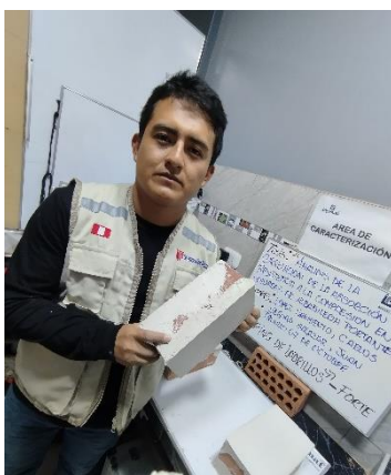
Figura 15. Capping del ladrillo Fortes.
