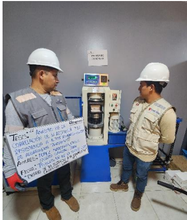
Figura 17. Resistencia a la compresión del ladrillo Lark.
