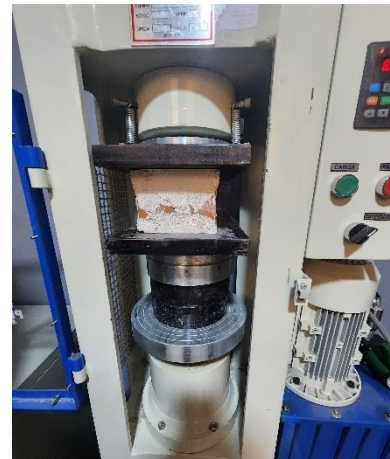
Figura 18. Ladrillo sometido a una carga en la prensa de concreto.
