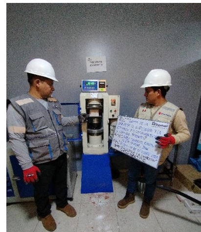
Figura 20. R.C del ladrillo Huanchaco.
