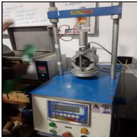
**Figura 5.** Prensa para ensayos Marshall.
