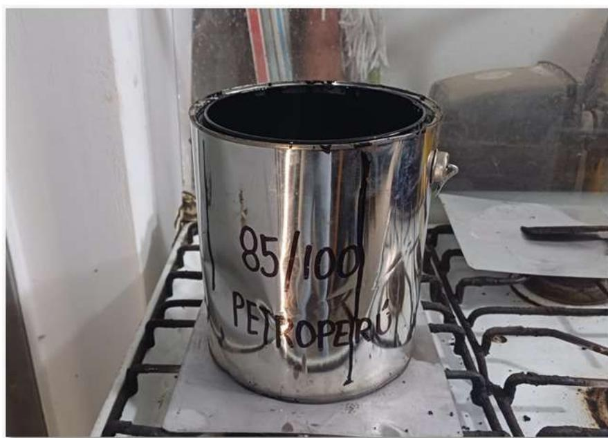
**Figura 4.** Cemento Asfáltico PEN 85/100.
