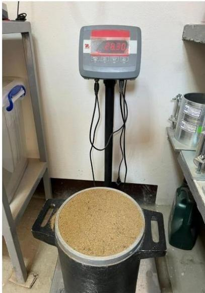
Y luego de obtener el peso del agregado sin compactar se realiza el mismo procedimiento, pero esta vez se compacta, para esto agregamos material en 3 partes iguales y se compacta 25 veces por norma. Una vez realizado eso, se pesa y debe ser mayor al peso sin compactar.
