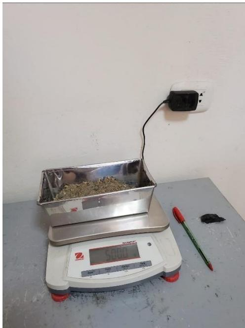
Para el agregado fino se utilizan 500g de muestra
