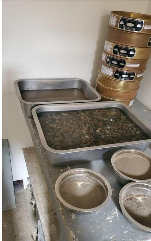
Para el ensayo del agregado grueso, se deja reposar por 24 horas bajo agua la muestra.
