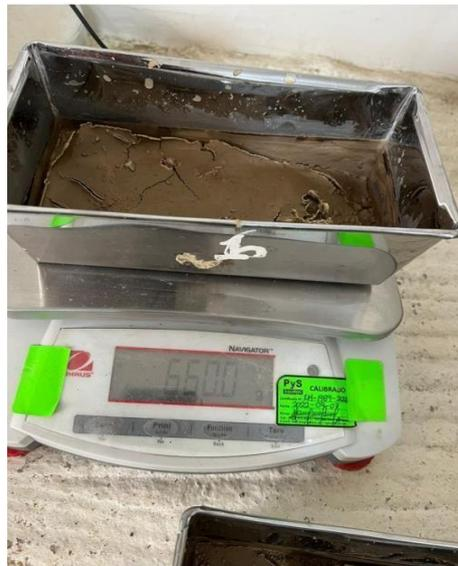
Pesamos y así se termina el ensayo de **ABSORCIÓN DEL AGREGADO FINO.**
