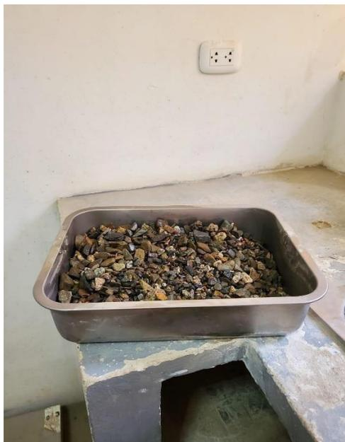
Pasadas las 24 horas, se bota la mayor parte de agua sin desperdiciar muestra y se seca y se pesa 2kg y medio.
