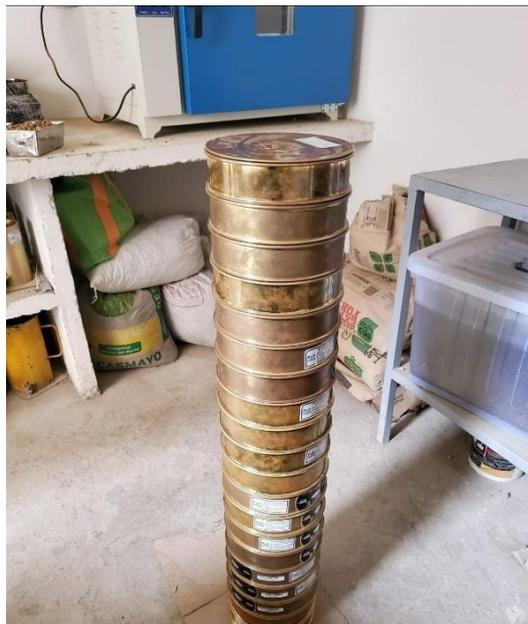
Luego seleccionamos los tamices daos por la norma, para el agregado fino y grueso.
