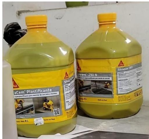
Aditivos que vamos a utilizar Sikament-290N (Superplastificante) y SikaCem Plastificante
