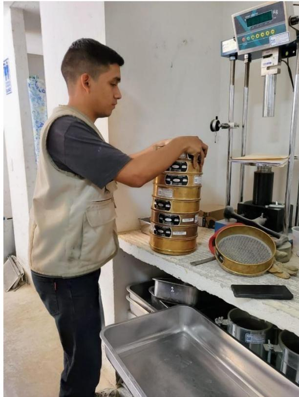
Luego vertemos la muestra seleccionada, se empieza a dar un movimiento circular a los tamices y lo que sobra se junta en un recipiente, y se toma nota.
