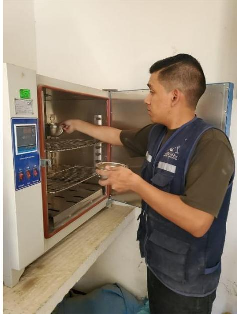
Introducir muestra al horno por 24 horas para poder realizar el ensayo de Granulometría de los agregados finos y gruesos.
