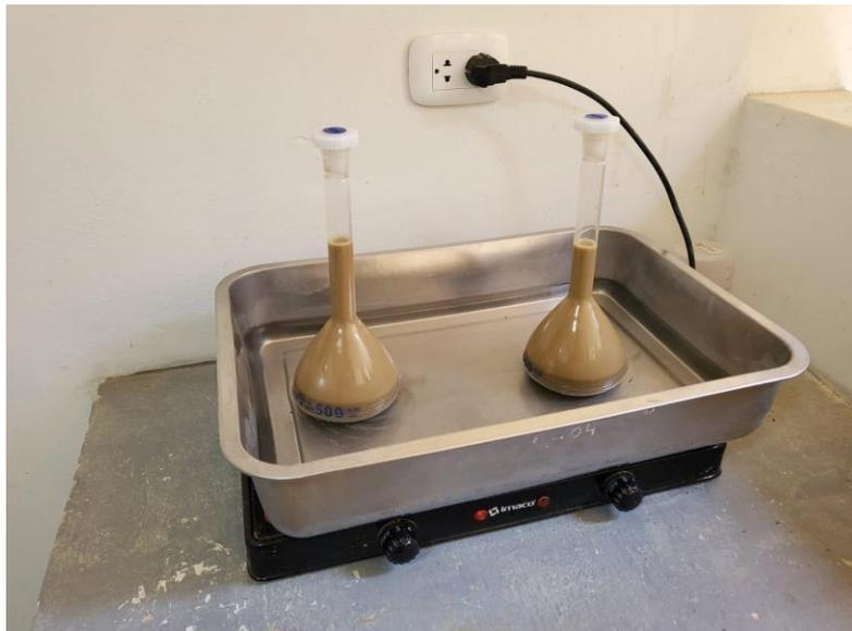
Luego colocamos 500g en cada fiola y se deja en la estufa hasta q desaparezca el agregado de vacíos.
