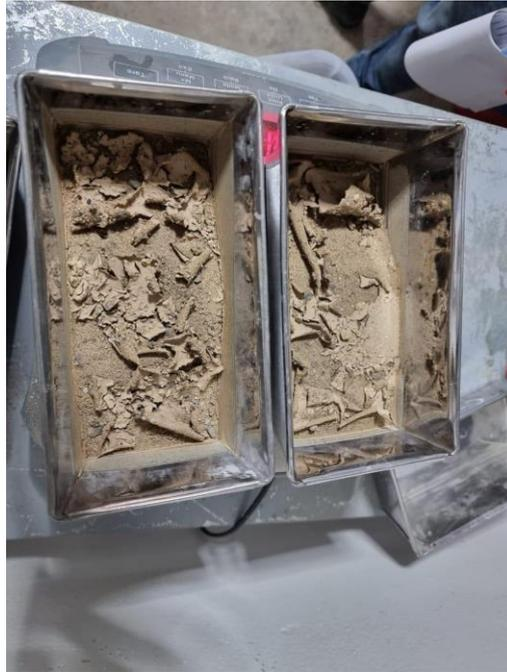
Esto se obtiene una vez pasadas las 24 horas de secado en el horno, se deja reposar a temperatura ambiente para ser pesado.
