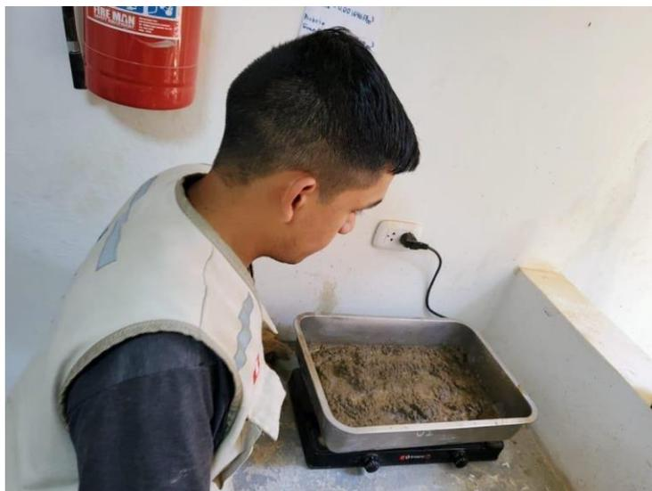
El agregado fino se deja reposar 24 horas en agua, luego se bota la mayor parte de agua sin desperdiciar muestra y para continuar con el secado, la muestra se calienta en la estufa, al aire libre o algún horno.
