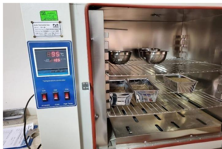
Luego se retira del agua, para ser secada por 24 horas en el horno, se pesa y así termina el ensayo de **ABSORCIÓN DEL AGREGADO GRUESO**.
