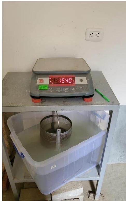
Luego se introduce en agua para ver el peso sumergido de la muestra
