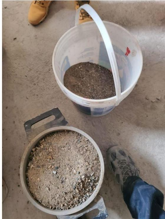
Para la realización de este ensayo es el mismo método para ambos agregados, se vierte el agregado en un depósito, con el volumen ya calculado, sin compactar y se pesa.
