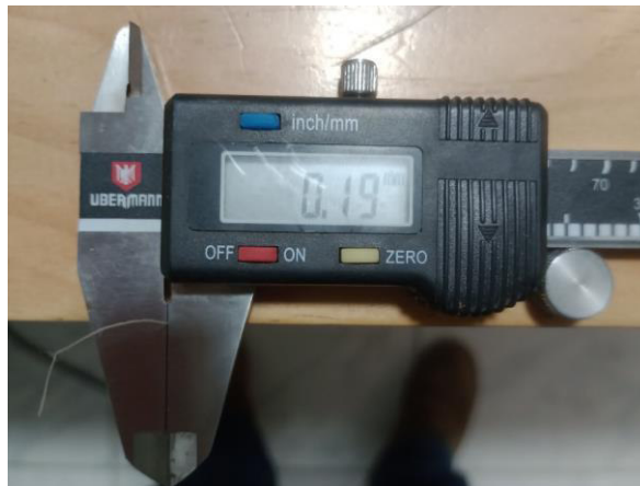
Figura 17. Medición del espesor de la fibra de hoja de piña.
