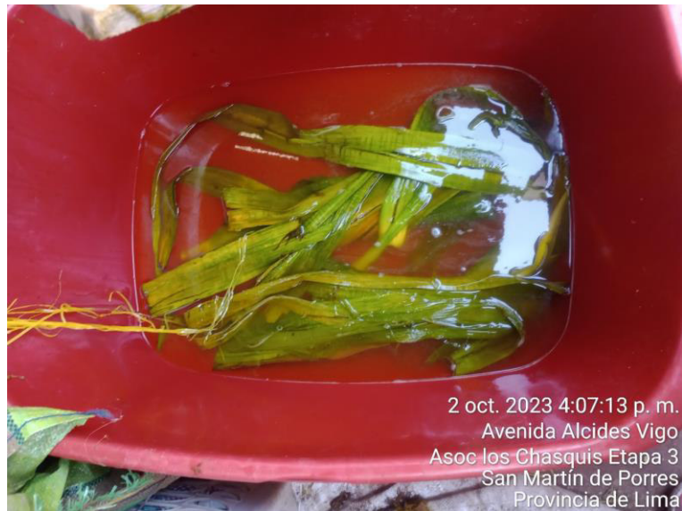
Figura 11. Reposo de la hoja de piña en solución química.
