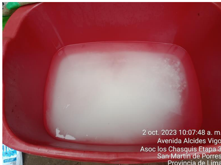
Figura 10. Disolución del hidróxido de sodio para desfibrado químico de la hoja.
