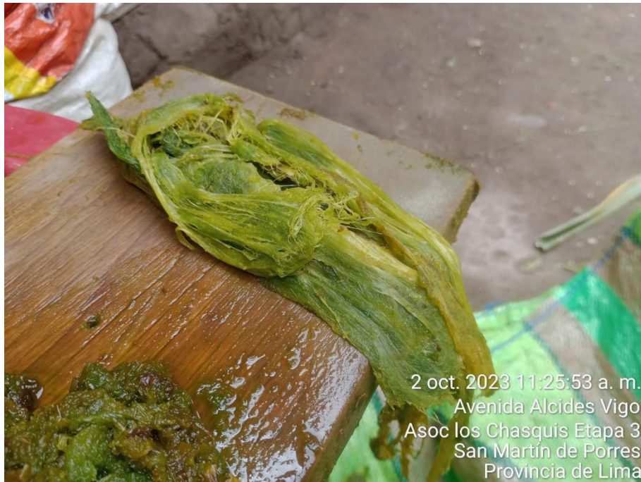
Figura 1. Fotografía de la fibra de la hoja de piña con primer tratamiento químico.
