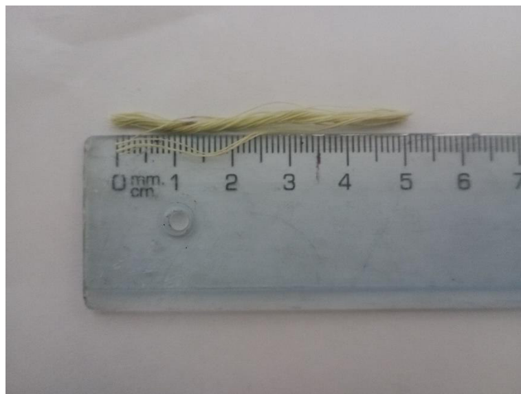
Figura 15. Longitud de corte de la fibra (5 cm)
