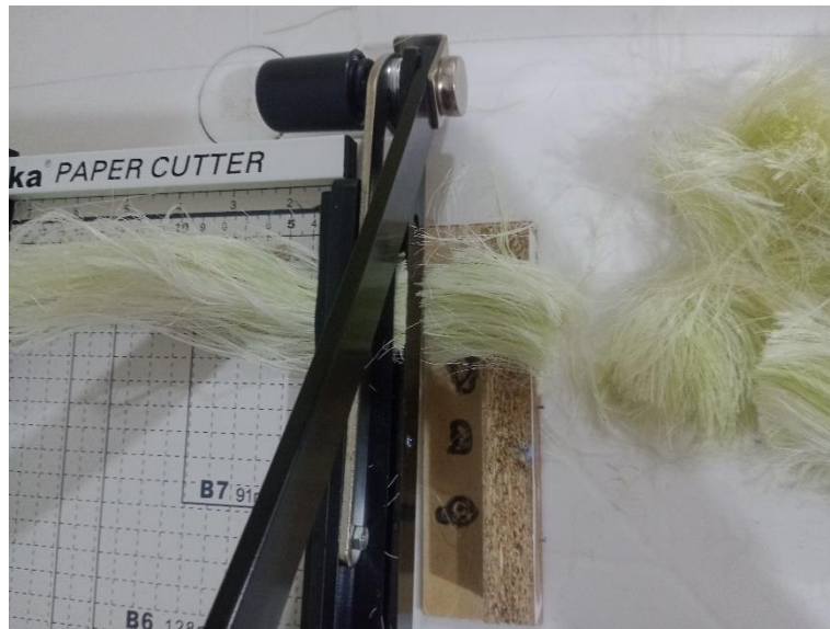
Figura 14. Corte de la fibra en tramos de 5 cm.
