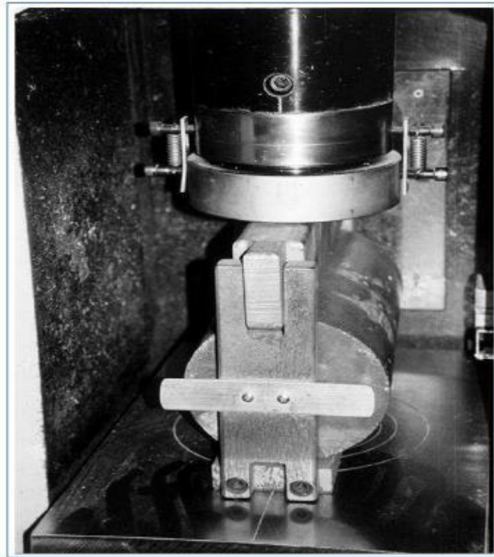
Figura 3. Ensayo de tracción indirecta de probetas cilíndricas.
