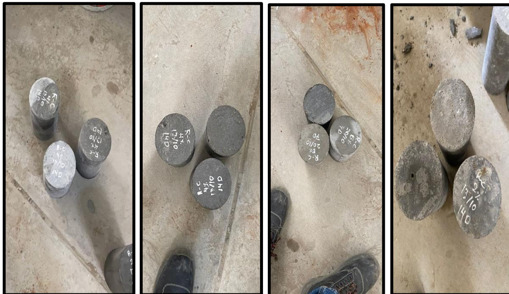
Fotografía 18: Probetas para los especímenes (0%, 2%, 4%, 6%) según los días de curado (7, 14 y 28 días)
