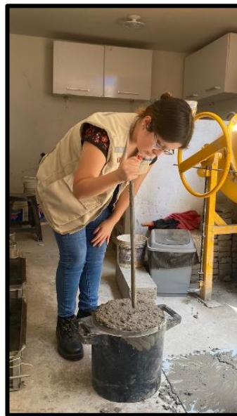
Fotografía 14: Realizamos el proceso para el Peso Unitario de la Mezcla (0%, 2%, 4%, 6%)
