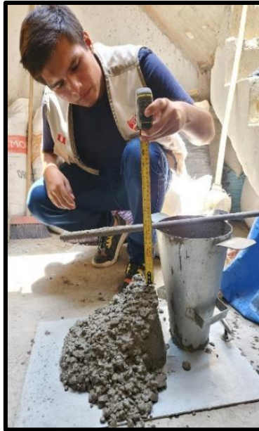
Fotografía 13: Realizamos la prueba de Slump (0%, 2%, 4%, 6%)
