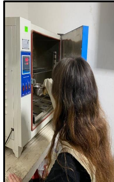
Fotografía 10: Realizamos el secado del agregado en Horno a 110°C
