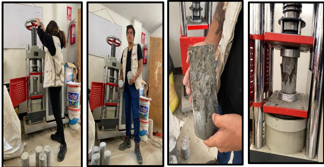
Fotografía 20: Realizamos la rotura de Probetas para Ensayo de Resistencia a la Compresión (0%, 2%, 4%, 6%) según los días de curado (7, 14 y 28 días)
