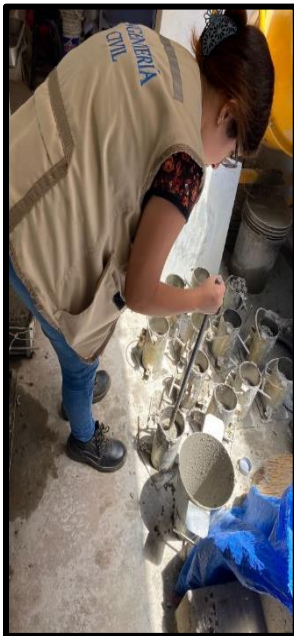
Fotografía 16: Realizamos el llenado de Probetas con la mezcla (0%, 2%, 4%, 6%)
