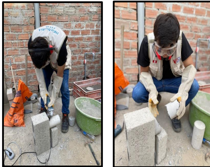
Fotografía 22: Realizamos el corte de Probetas en cuatro partes para Ensayo de Método Normalizado (Densidad, Absorción y % de Vacíos) según los especímenes (0%, 2%, 4%, 6%)
