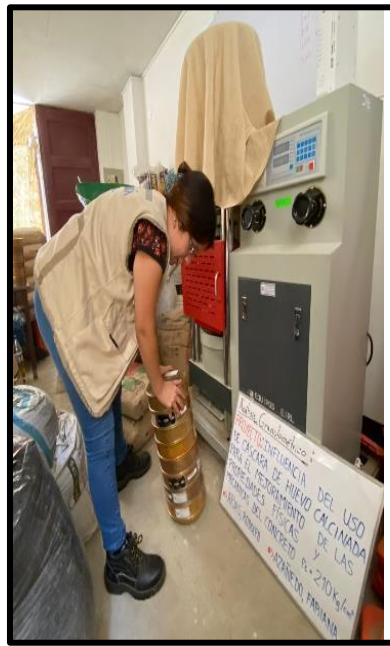
Fotografía 11: Tamizamos el agregado fino y grueso, durante 1 min respectivamente
