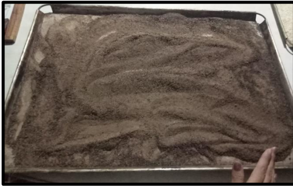
Fotografía 05: Apreciación del proceso de calcinación de Cascara de Huevo.
