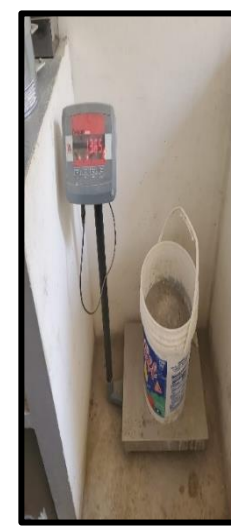
Fotografía 12: Realizamos el pesaje de Materiales: Cemento, Agua, Agregados
