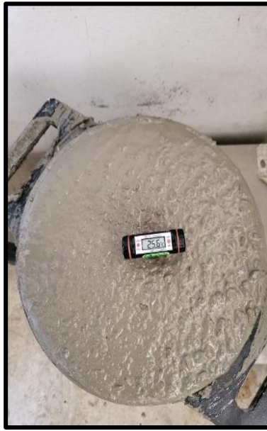
Fotografía 15: Tomamos nota de la temperatura y Peso Unitario de la Mezcla (0%, 2%, 4%, 6%)
