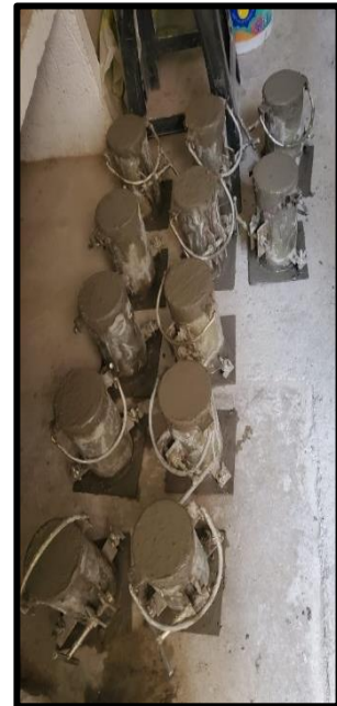
Fotografía 16: Realizamos el llenado de Probetas con la mezcla (0%, 2%, 4%, 6%)
