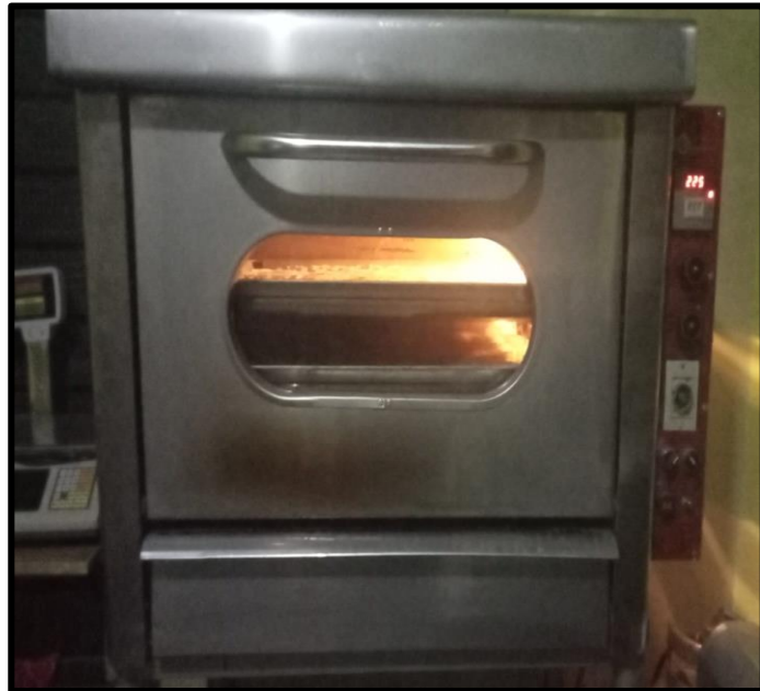
Fotografía 04: Iniciamos la calcinación del Aditivo (Casca de huevo triturada) 20Kg.
