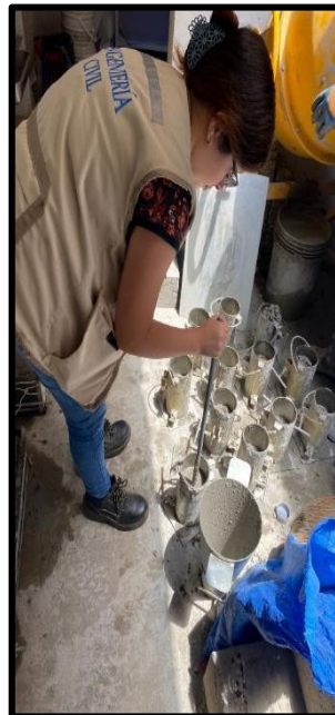
Fotografía 16: Realizamos el llenado de Probetas con la mezcla (0%, 2%, 4%, 6%)
