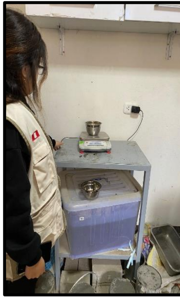
Fotografía 09: Realizamos el pesaje de los Agregados (Arena y Grava)
