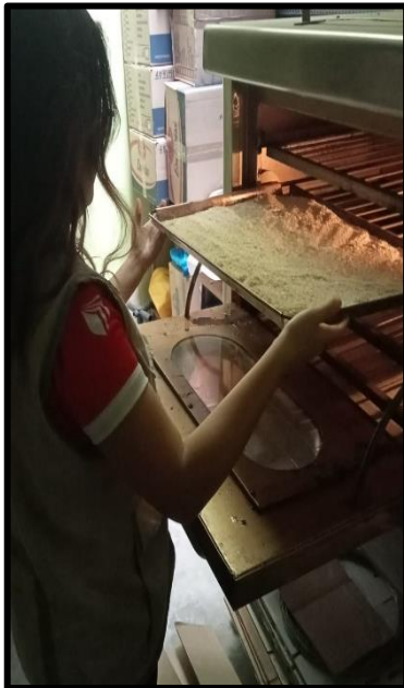
Fotografía 04: Iniciamos la calcinación del Aditivo (Casca de huevo triturada) 20Kg.
