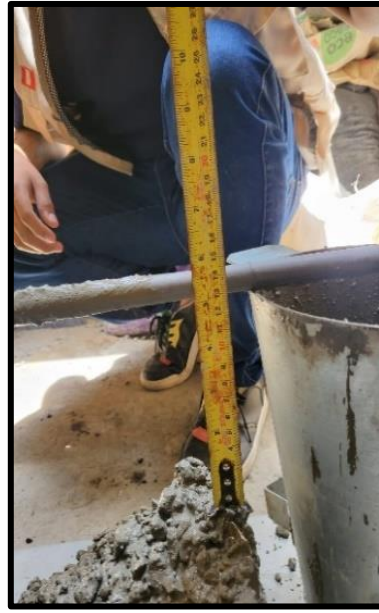
Fotografía 13: Realizamos la prueba de Slump (0%, 2%, 4%, 6%)
