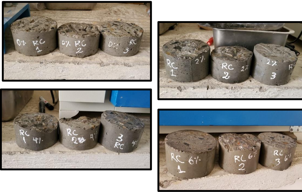
Fotografía 25: Dejamos secar superficialmente los cortes de las probetas antes sumergidos para el proceso de hervido
