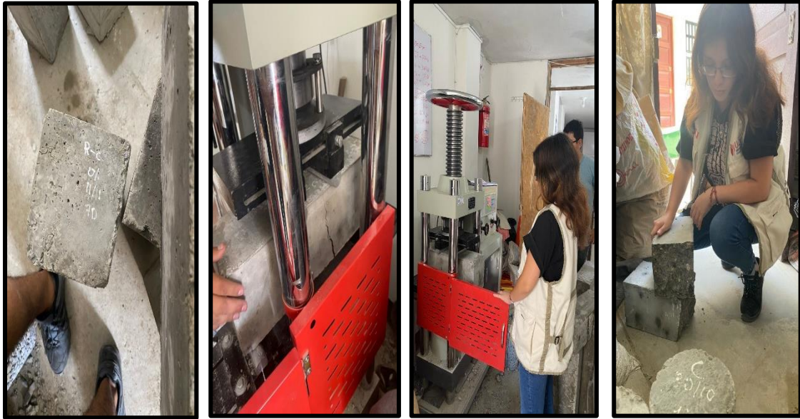
Fotografía 21: Realizamos la rotura de Viguetas para Ensayo de Resistencia a la Flexión (0%, 2%, 4%, 6%) según los días de curado (7, 14 y 28 días)
