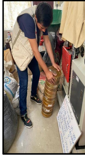
Fotografía 11: Tamizamos el agregado fino y grueso, durante 1 min respectivamente
