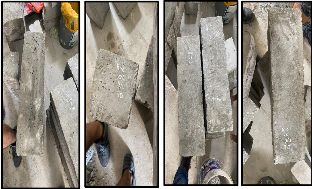
Fotografía 19: Viguetas para los especímenes (0%, 2%, 4%, 6%) según los días de curado (7, 14 y 28 días)
