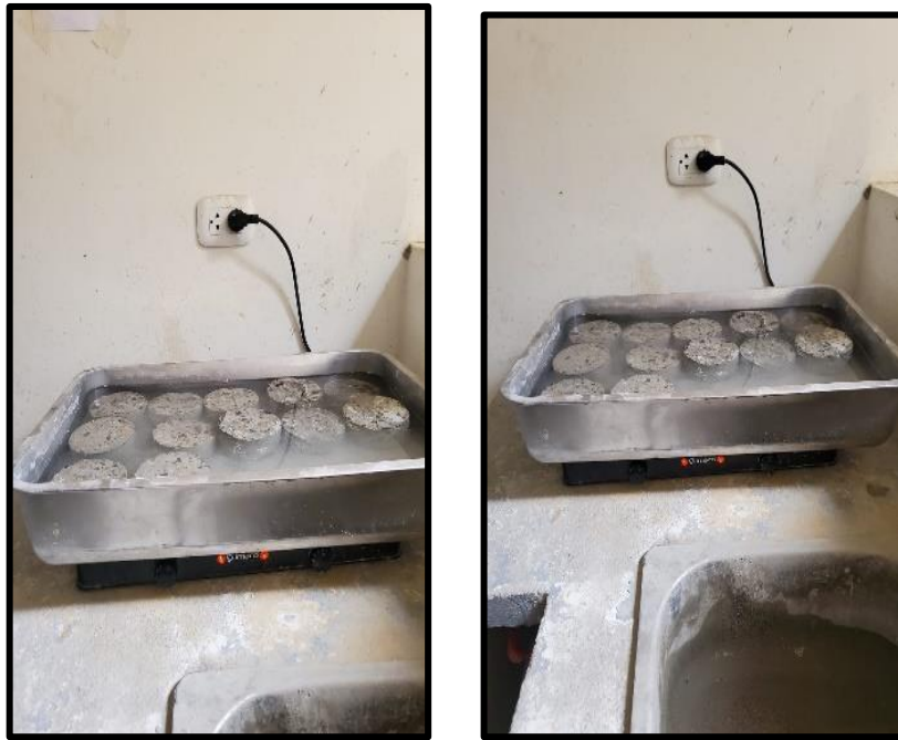
Fotografía 27: Colocamos los cortes de las probetas en una bandeja con agua y se coloca en una cocina eléctrica de laboratorio a hervir por 5 hrs.
