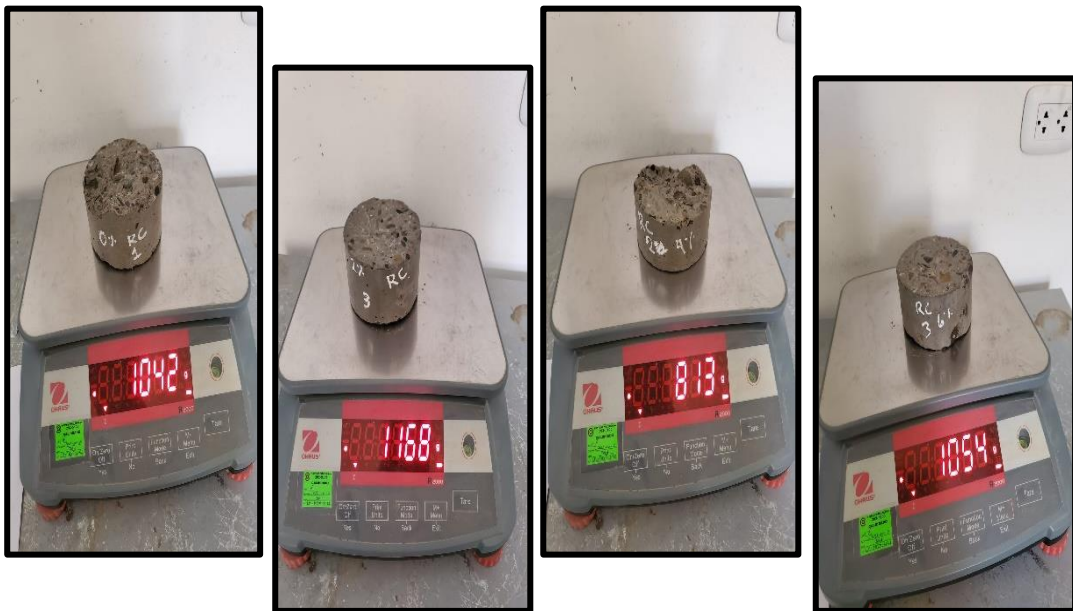
Fotografía 26: Procedemos a pesar los cortes de las probetas antes sumergidos y se toma nota
