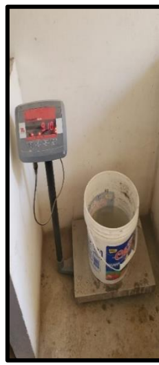
Fotografía 12: Realizamos el pesaje de Materiales: Cemento, Agua, Agregados
