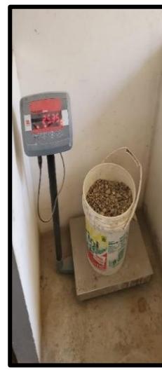
Fotografía 12: Realizamos el pesaje de Materiales: Cemento, Agua, Agregados
