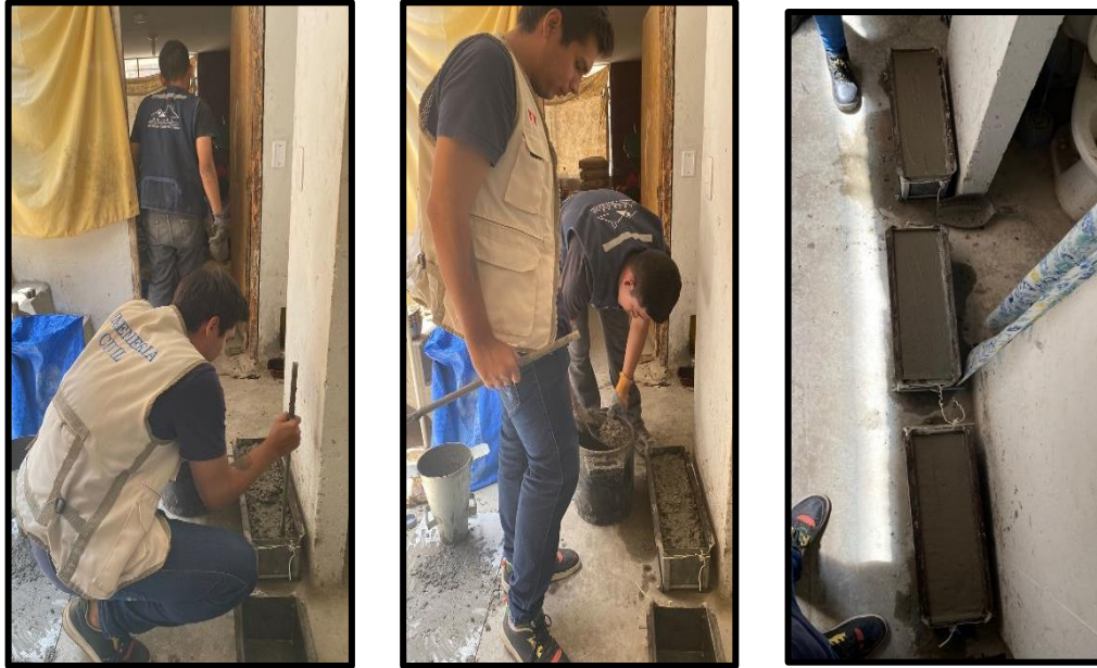
Fotografía 17: Realizamos el llenado de Viguetas con la mezcla (0%, 2%, 4%, 6%)
