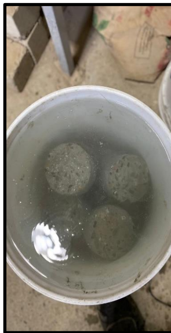
Fotografía 24: Procedemos a sumergir los cortes de las probetas por 48 hrs.
