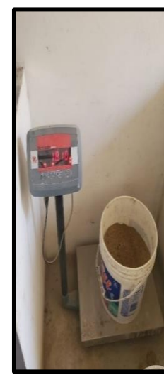
Fotografía 12: Realizamos el pesaje de Materiales: Cemento, Agua, Agregados
