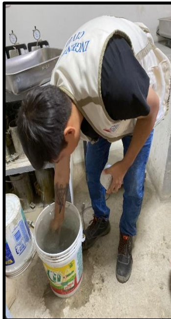
Fotografía 24: Procedemos a sumergir los cortes de las probetas por 48 hrs.
