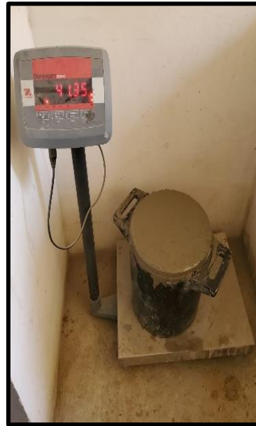
Fotografía 15: Tomamos nota de la temperatura y Peso Unitario de la Mezcla (0%, 2%, 4%, 6%)
