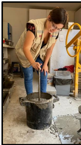
Fotografía 14: Realizamos el proceso para el Peso Unitario de la Mezcla (0%, 2%, 4%, 6%)
