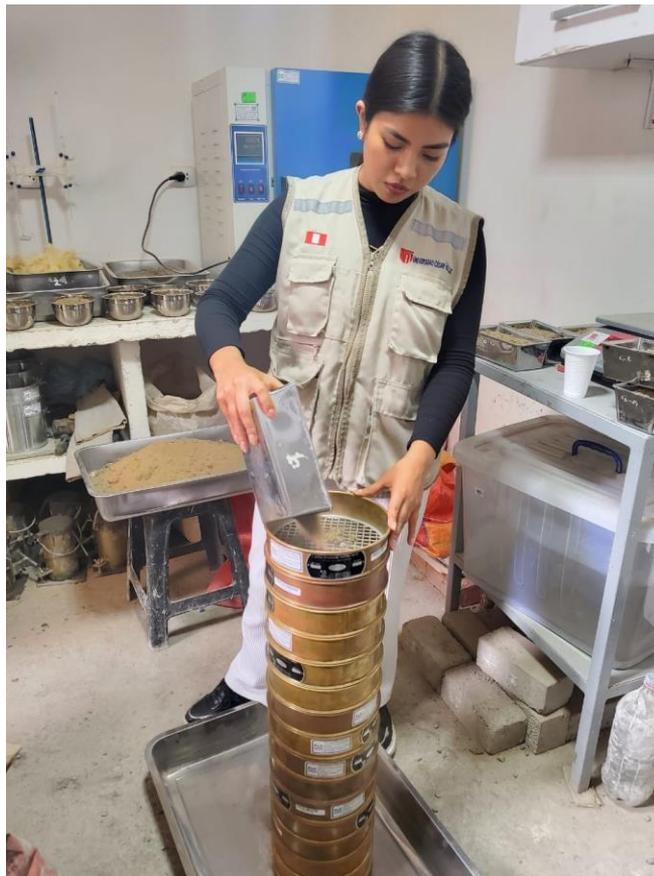
IMAGEN 10: CONTINUAMOS CON ENSAYOS DE GRANULOMETRIA, SE VIERTE LA MUESTRA EN LOS TAMICES
