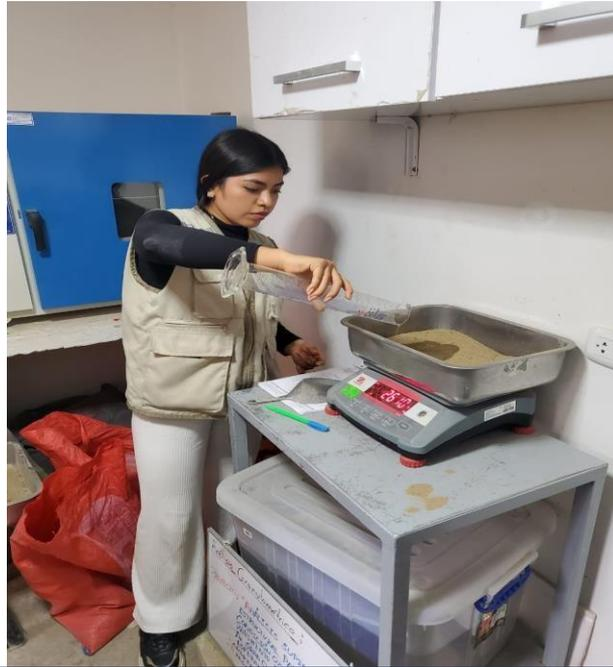
IMAGEN 15: INICIAMOS COLOCANDO 5% DE AGUA EN LA MUESTRA
