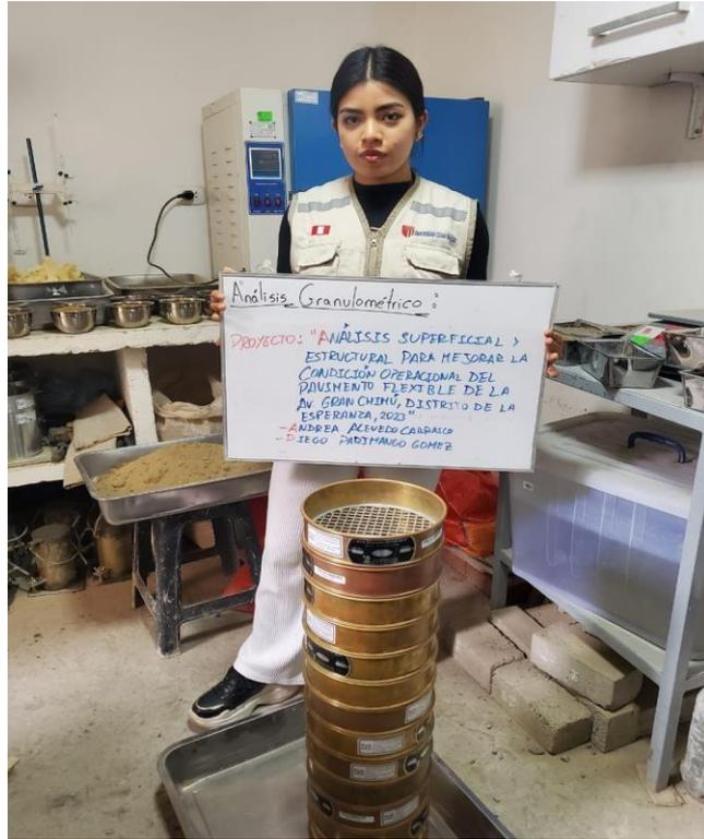
IMAGEN 11: TERMINAMOS DE SEPARAR LAS PARTICULAS EN LOS TAMICES
