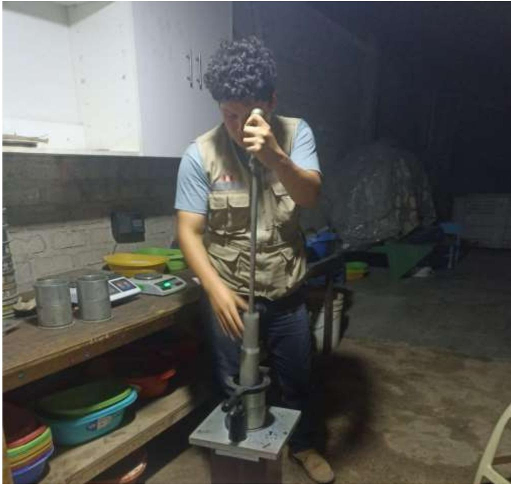
**Imagen 3.** Estudiante realizando el ensayo Marshall.
