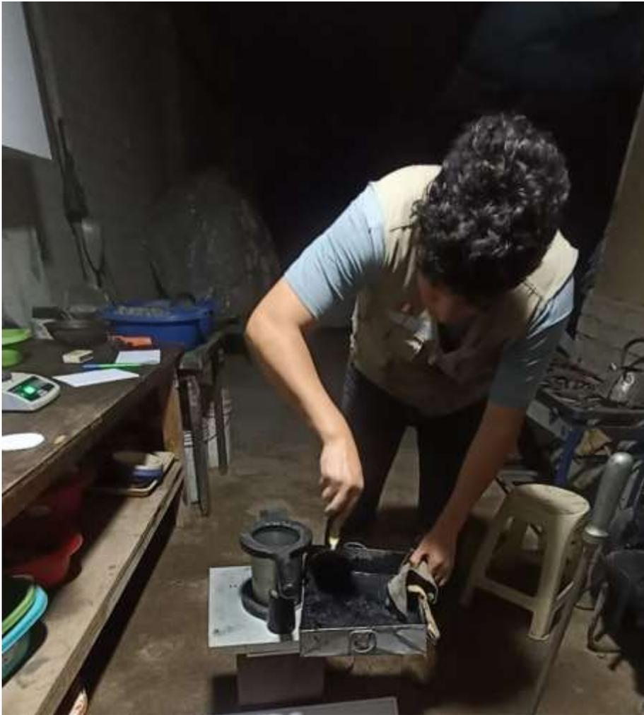
**Imagen 4.** Estudiante midiendo la temperatura de la mezcla asfáltica.
