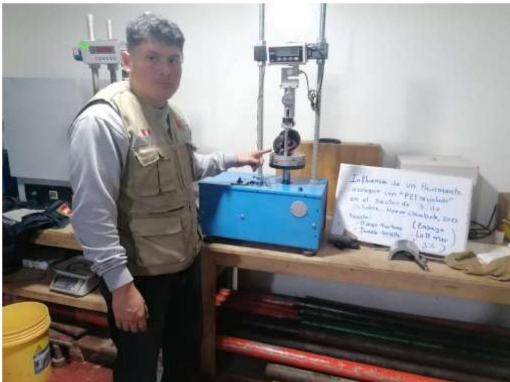
**Imagen 11.** Estudiante en el laboratorio junto a la prensa Marshall y las briquetas.
