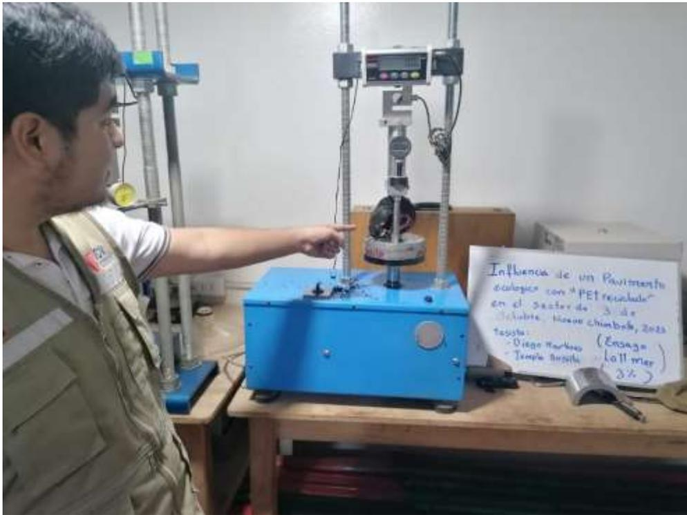
**Imagen 10.** Estudiante en el laboratorio junto a la prensa Marshall.
