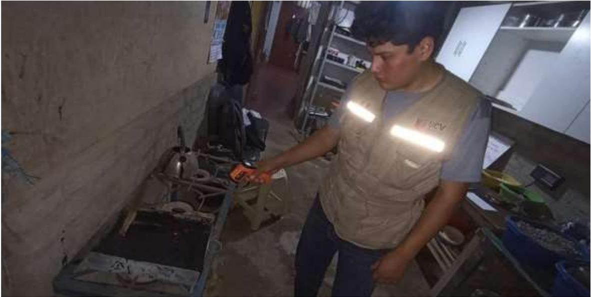
**Imagen 5.** Estudiante midiendo la temperatura de la mezcla asfáltica.
