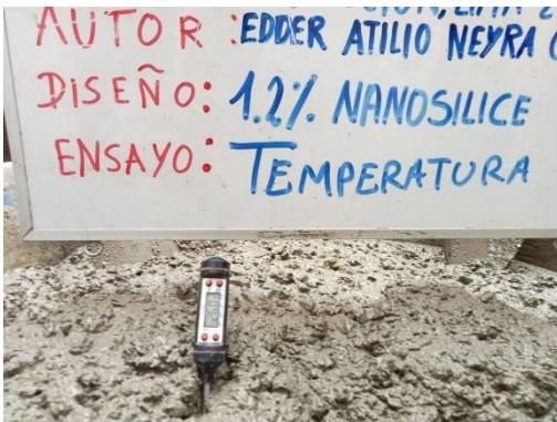
Foto 6: Temperatura del concreto con 1.2% de nanosílice
