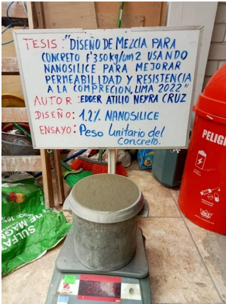
Foto 8: Peso unitario del concreto fresco patrón con 1.2% de nanosílice
