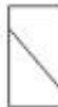
Tipo 4 Fractura diagonal sin flange a través de los extremos, golpes suavemente con un martillo para distinguirlo del Tipo 1
