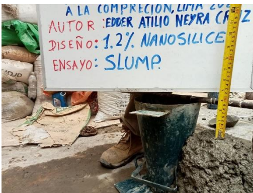
Foto 7: Slump del concreto con 1.2% de nanosílice
