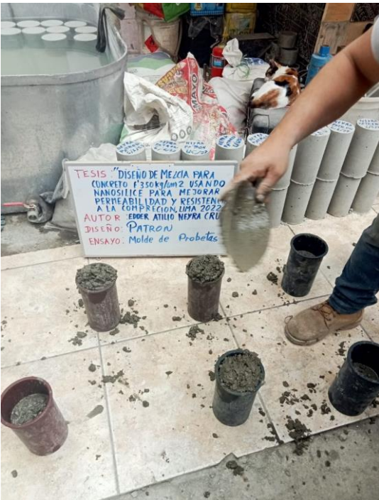
Foto2: Elaboración de probetas para el concreto patrón
