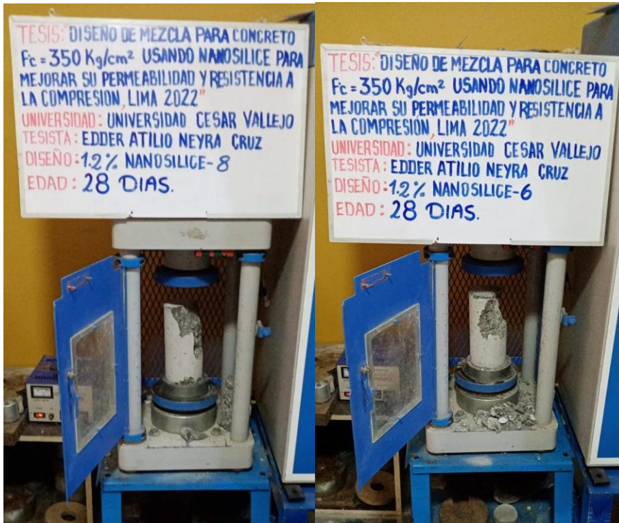
Foto 20: Resistencia a la compresión de concreto patrón con 1.2% de NS a 28 días
