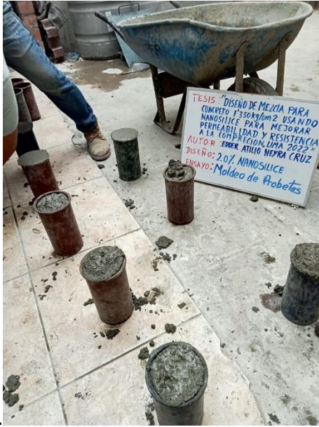
Foto 14: Elaboración de probetas para el concreto patrón con 2% de nanosílice
