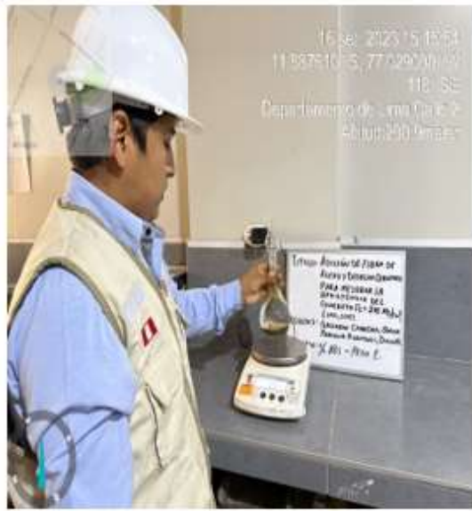
FOTO N°05: DESCRIPCION: Peso Especifico del Agregado Fino
