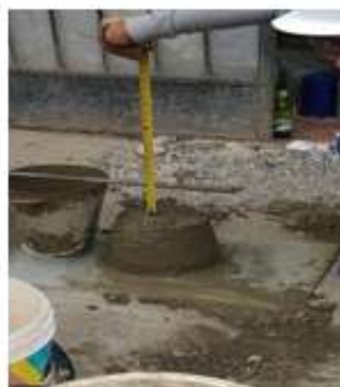
FOTO N°10: DESCRIPCION: Prueba de Slump
