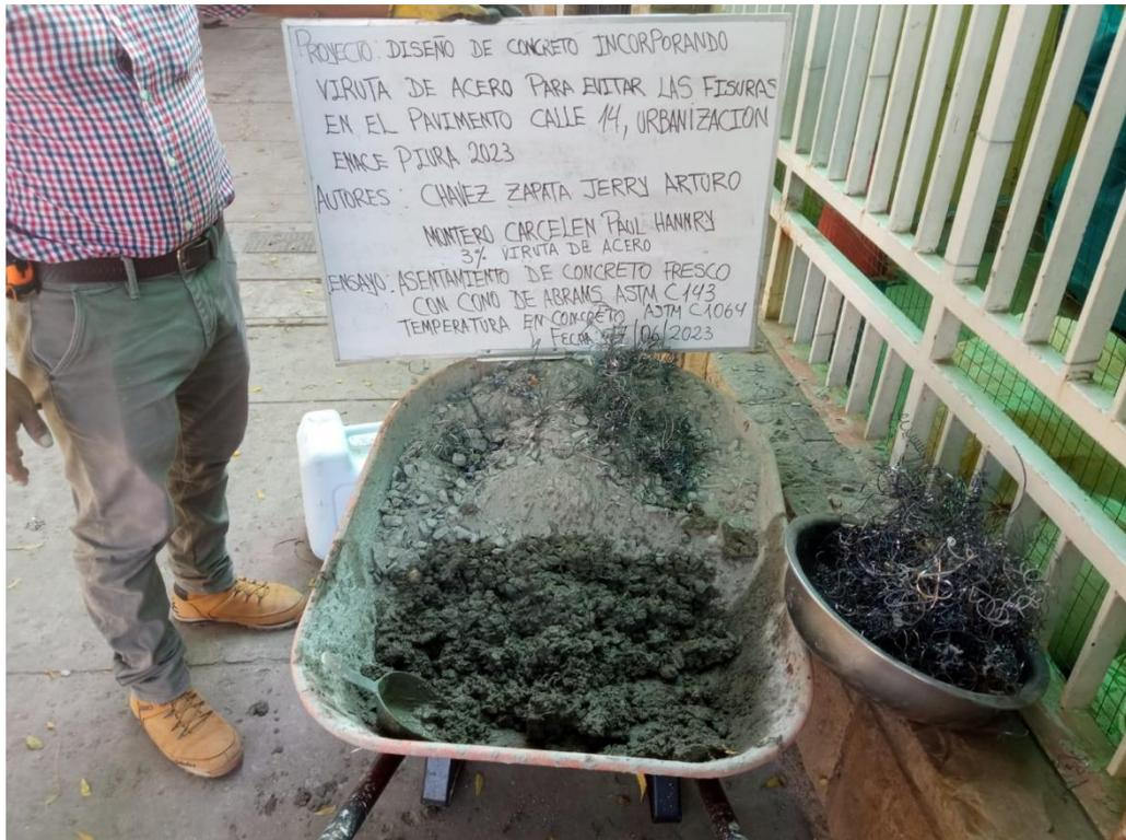
**MEZCLA DE CONCRETO CON VIRUTA DE ACERO**
