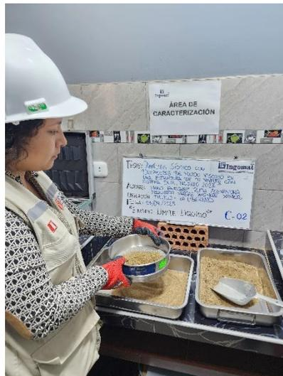
Figura 72. Tamizado de muestra a utilizar en el ensayo límite líquido.
