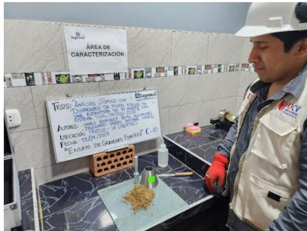
Figura 67. Apisonado del material dentro del molde con 25 golpes
