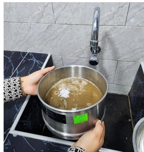
Figura 65 y 66. Lavado de la muestra
