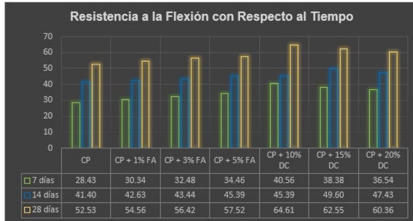
Figura 17. Resumen de los valores promedio de la Resistencia a la Flexión Fuente: Propia
