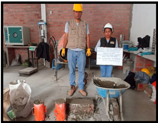
FOTOGRAFIA 45: Elaboración de las probetas 6"12 y vigas(15x15x50)
