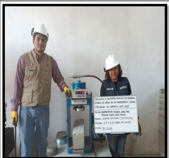
FOTOGRAFIA 54: Ensayo Flexión en vigas ( 15x15x50) 14 días
