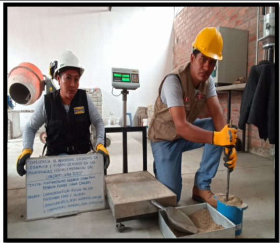
FOTOGRAFIA 24: compactando la arena
