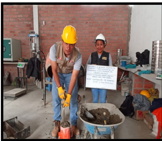
FOTOGRAFIA 43: compactando la última capa de la probeta cilíndrica
