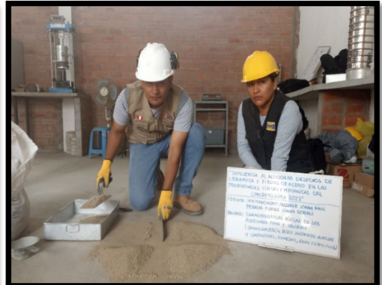
FOTOGRAFIA 2: Muestra del agregado fino por el método del cuarteo
