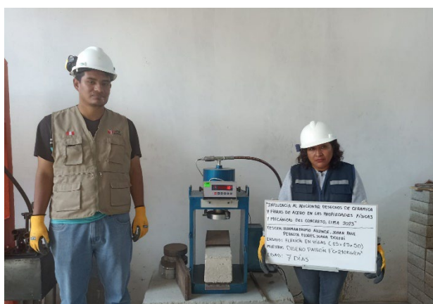
Figura 16. Ensayo de Resistencia a la Flexión Fuente: Propia
