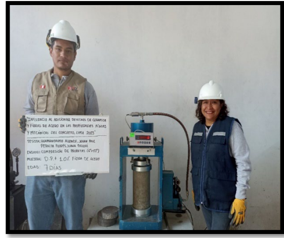
FOTOGRAFIA 48: Ensayo de Compresión de Dp +10% Fibra de acero
