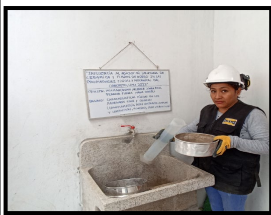
FOTOGRAFIA 7: Llenando de agua el agregado fino
