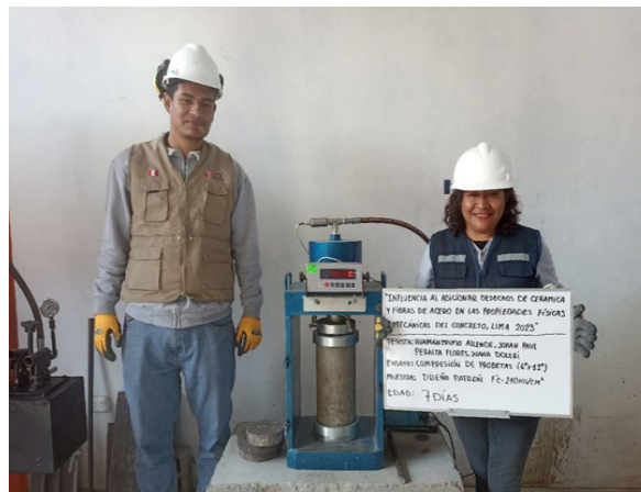
Figura 14. Ensayo de Resistencia a la Compresión
