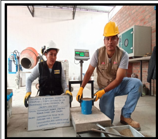
FOTOGRAFIA 27: Ensayo de compactación
