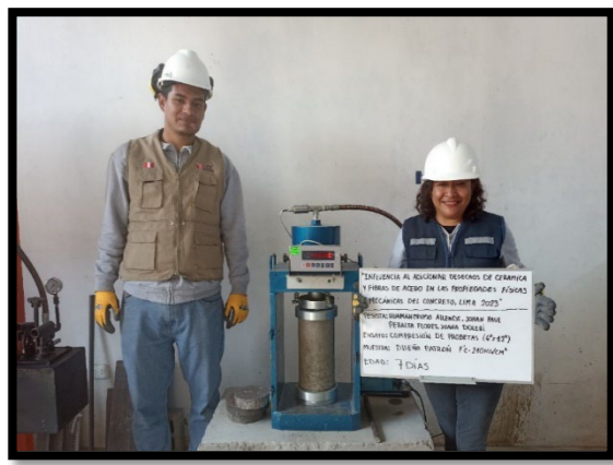
FOTOGRAFIA 46: Ensayo de compresión del Diseño de patrón ( 6" X12")
