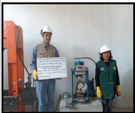
FOTOGRAFIA 58: Ensayo de Tracción por Compresión Diamétrico de desecho de cerámico 28 días
