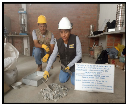
FOTOGRAFIA 3: Muestra del agregado grueso por el método del cuarteo
