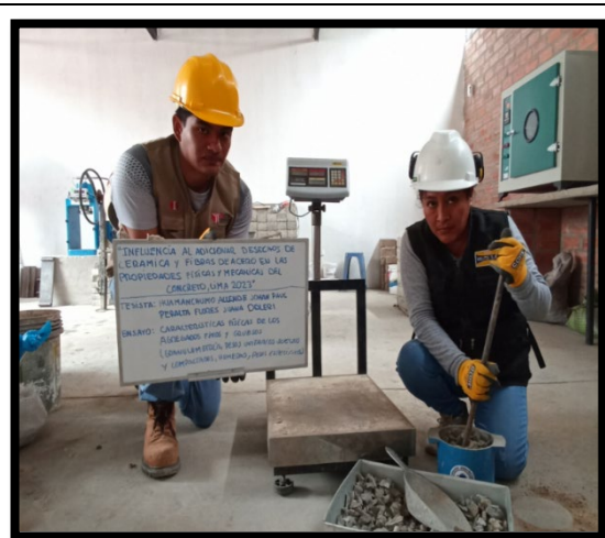
FOTOGRAFIA 26: Compactando la piedra
