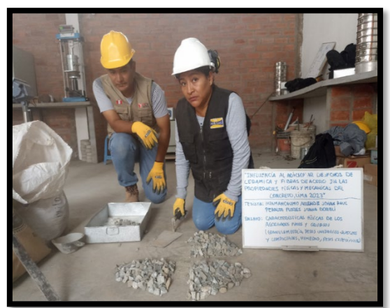
FOTOGRAFIA 4: Muestra del agregado grueso por el método del cuarteo
