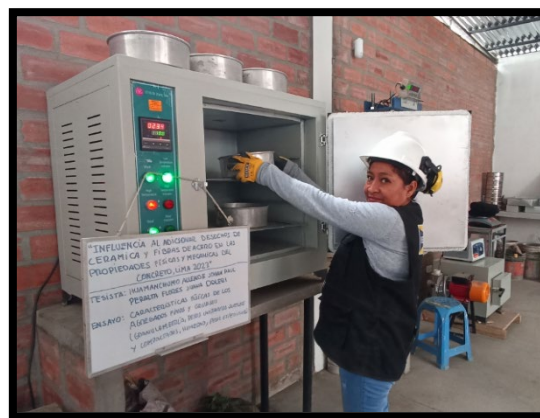
FOTOGRAFIA 10: Colocando el agregado grueso al horno
