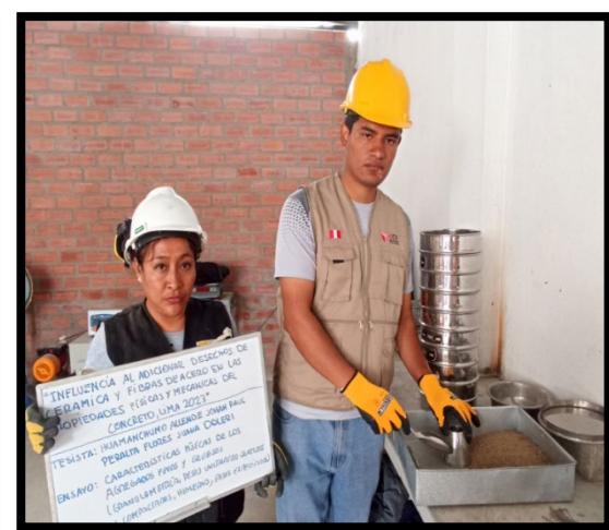
FOTOGRAFIA 16: Ensayo de la densidad de la arena
