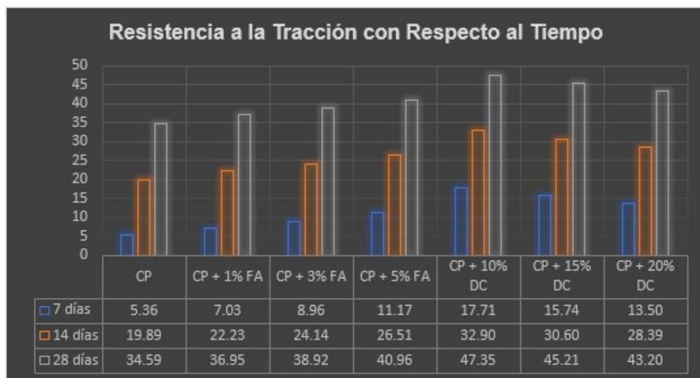
Figura 19. Resumen de los valores promedios de la Resistencia a la Tracción Fuente: Propia
