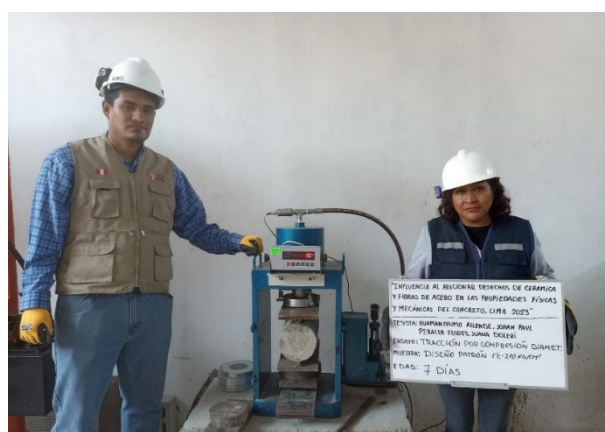
Figura 18. Ensayo de Resistencia a la Tracción Fuente: Propia
