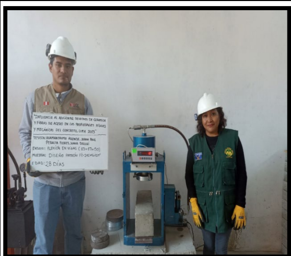
FOTOGRAFIA 50: Ensayo Flexión en vigas ( 15x15x50)
