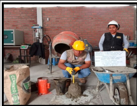
FOTOGRAFIA 41: Medición del asentamiento
