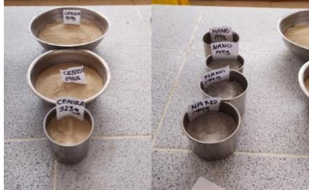
*Figura 21. Dosificación en % de Ns y CFA*
