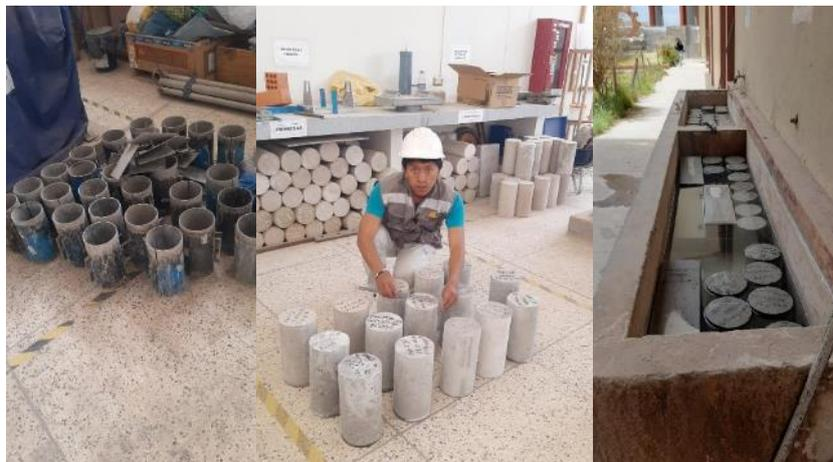
*Figura 24.* Desmolde y curado de probetas
