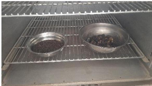
*Figura 20.* Muestras colocadas en el horno
