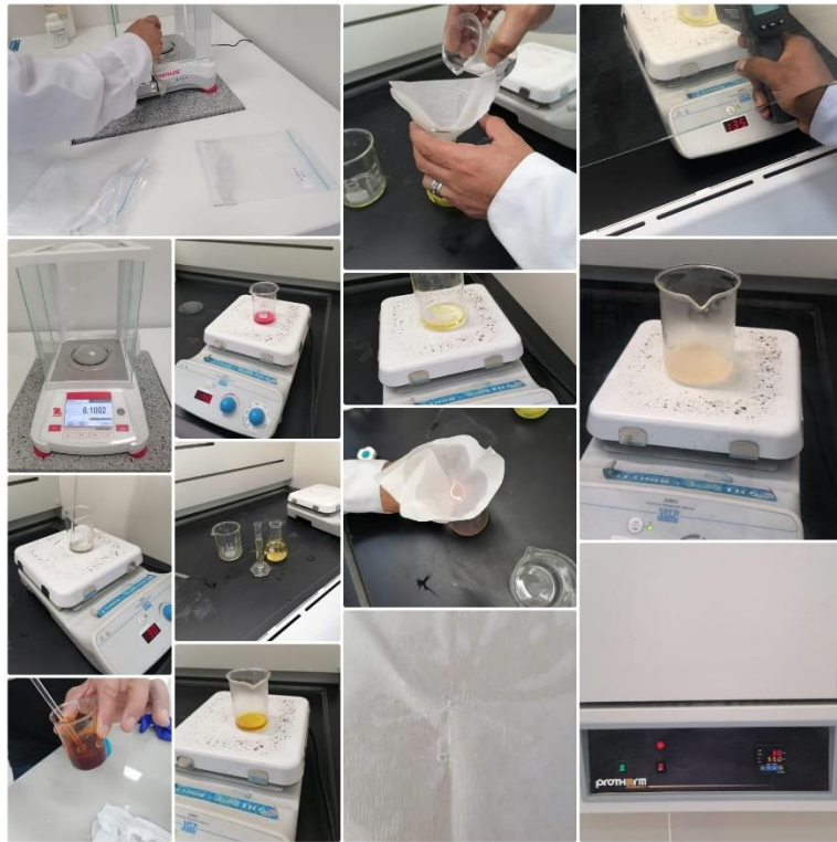
Análisis gravimétrico por precipitación para determinar pureza de CaO.
