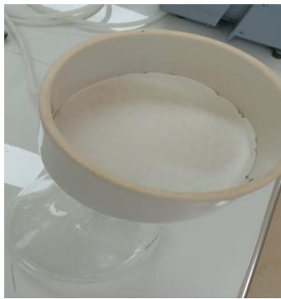
Filtrado de muestras tratadas con cáscara de huevo de gallina calcinada con 49.78% de pureza óxido de calcio.
