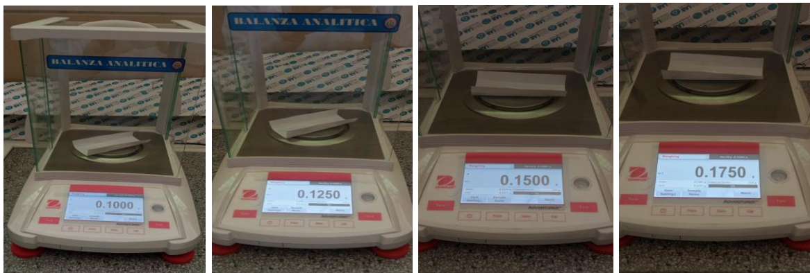
Pesaje de cáscara de huevo de gallina calcinada con 49.78 % de pureza de óxido de calcio.
