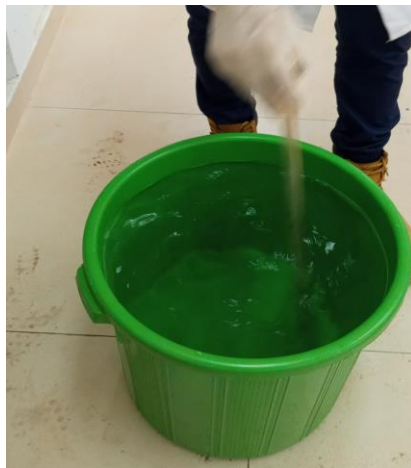
Preparación de la solución (agua contaminada por inducción propia).
