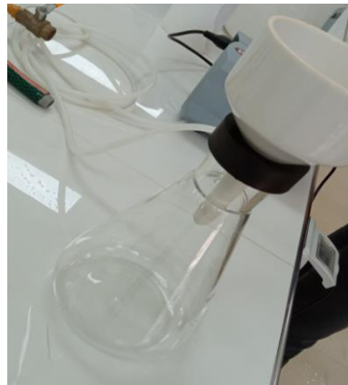
Filtrado de muestras tratadas con cáscara de huevo de gallina calcinada con 49.78% de pureza óxido de calcio.
