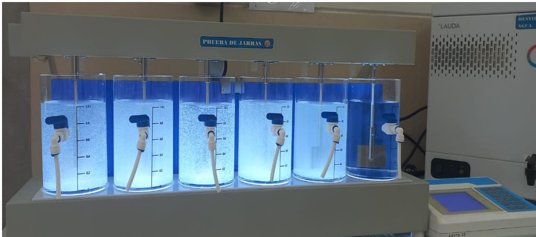
Prueba de jarras utilizando cáscara de huevo de gallina calcinada con 49.78 % de pureza óxido de calcio.
