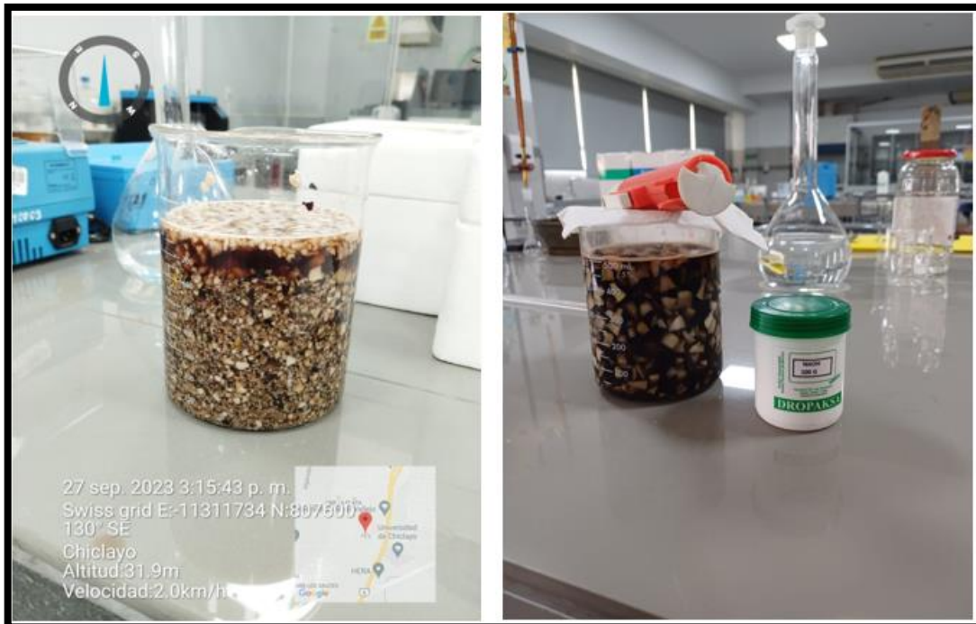
Fotografía 05. Limpieza en \text{NaOH}_3 de la materia prima
