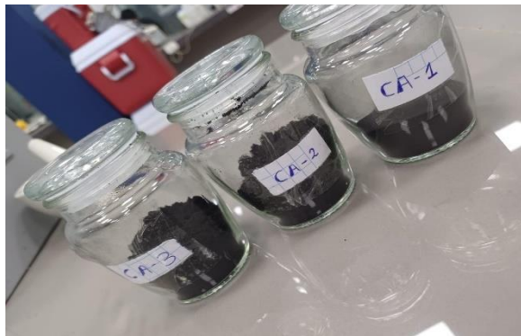
Figura 21. Almacenamiento del carbón activado
