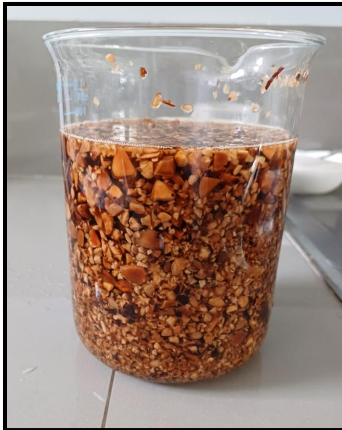
Fotografía 07. Impregnación con ácido fosfórico
