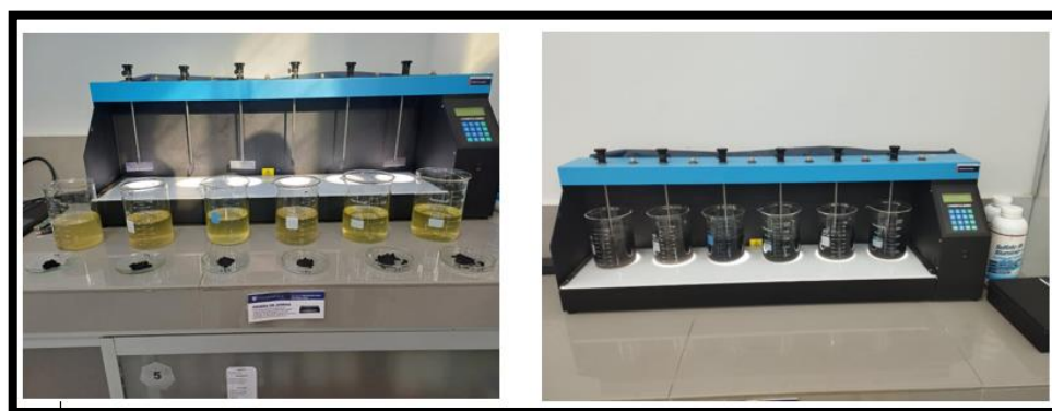
Figura 06. Dosificación del carbón y proceso de adsorción mediante prueba de jarras
