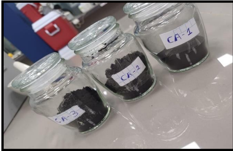
Fotografía 10. Obtención y almacenamiento del carbón activado a base de semilla de Mauritia flexuosa
