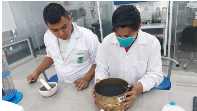
Figura 20. Molienda y tamizado del carbón activado
