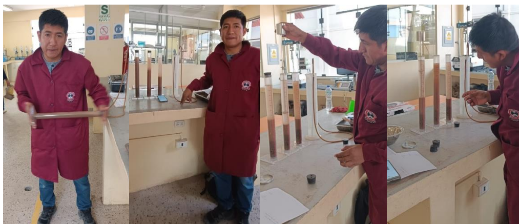
Figura 32. Obtención de la Lectura de Arena y Arcilla
