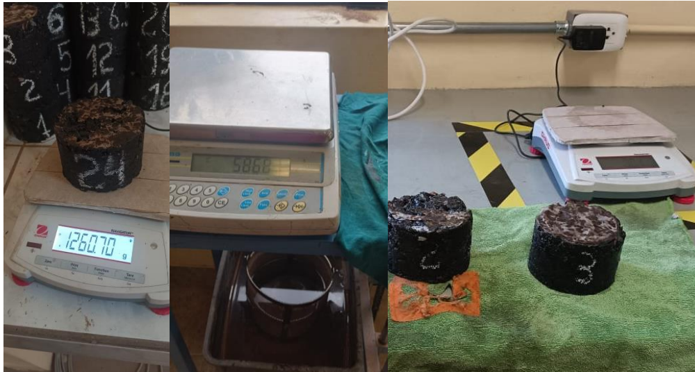
Figura 55 Determinación de Peso Específico Bulk
