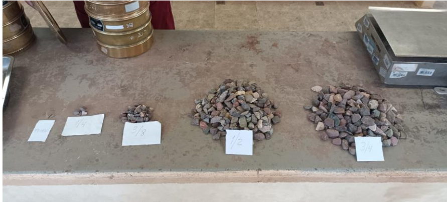
Figura 15. Cantidades retenidas de agregado grueso en cada tamiz
