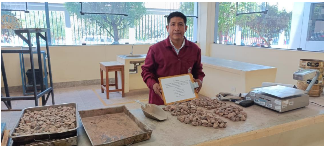
Figura 11. Cuarteo Manual del Agregado Grueso
