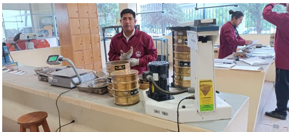
Figura 14. Ejecución del tamizado por medio de un tamizador mecánico
