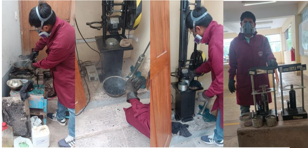
Figura 49 Preparación de la SMA Mezcla Patrón
