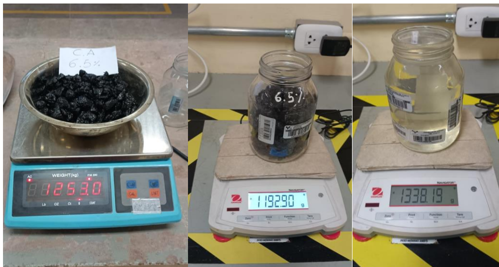
Figura 56 Determinación del Peso Específico Rice
