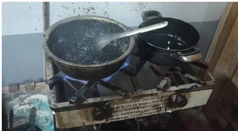
Figura 48 Preparación de la SMA Hasta Lograr una Mezcla Homogénea
