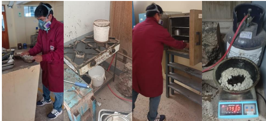
Figura 47 Preparación de Especímenes de SMA
