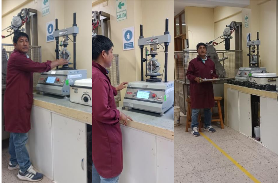
Figura 51 Ensayo Marshall para la Obtención de la Estabilidad
