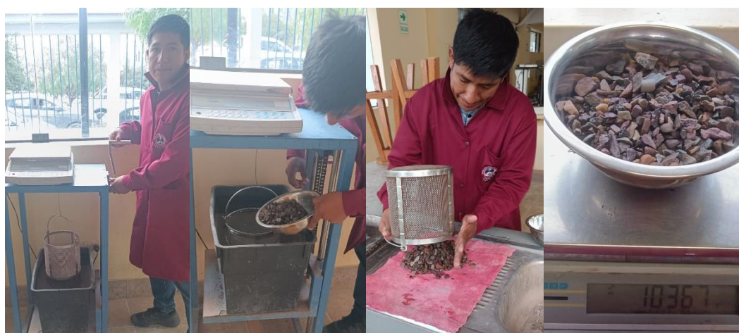
Figura 28. Procedimiento para Ensayo Peso Específico.
