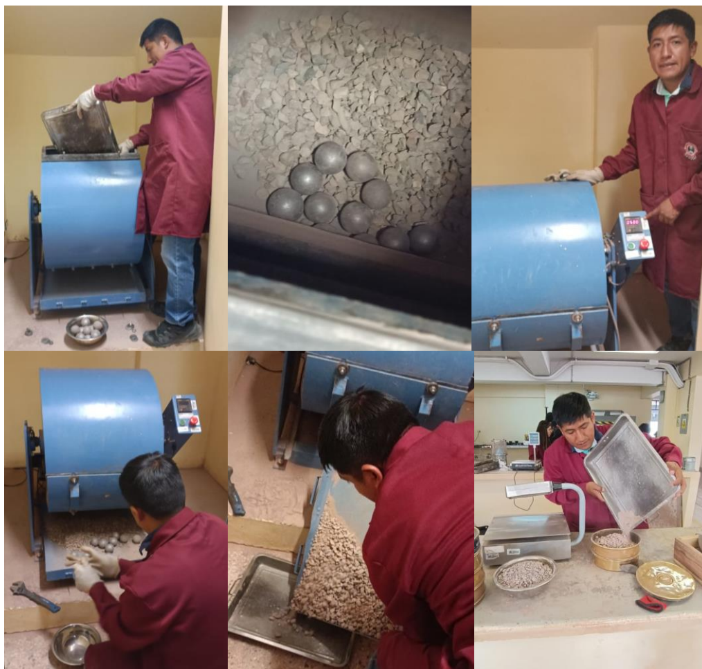
Figura 25. Procedimiento para el Ensayo Abrasión los Ángeles
