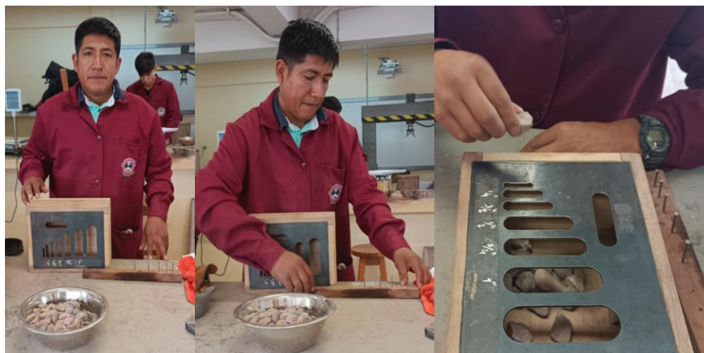
Figura 27. Procedimiento para Determinar el Índice de Aplanamiento y Alargamiento.
