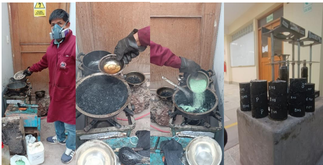
Figura 52 Elaboración de Briquetas para la Obtención del Flujo Marshall
