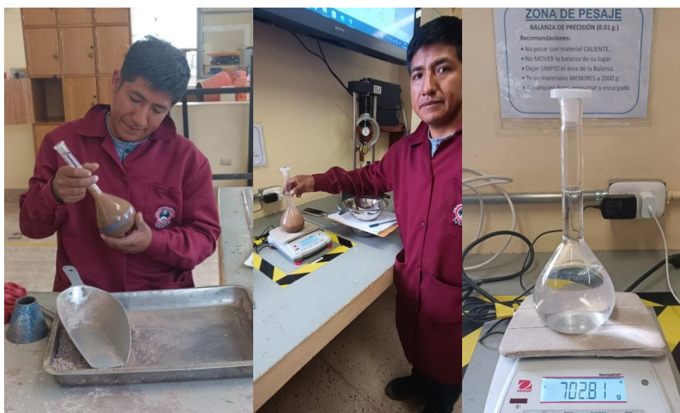
Figura 30. Obtención de la Gravedad Específica.
