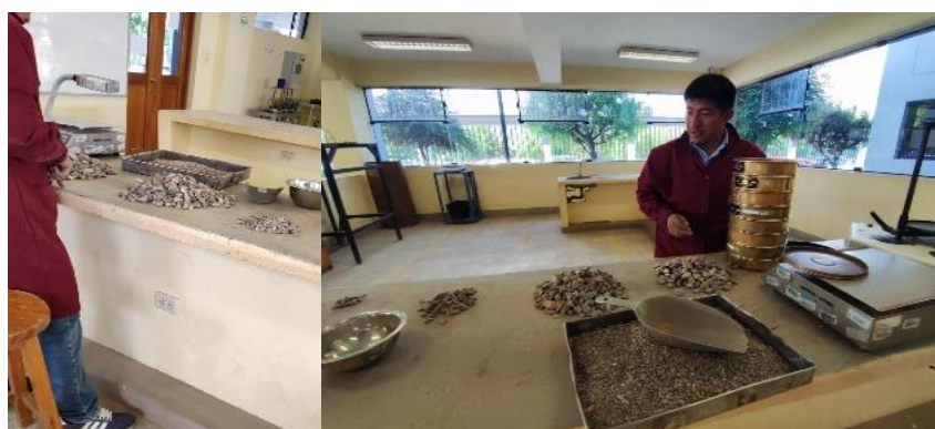
Figura 39. Obtención de Pesos de los Agregados Pétreos.
