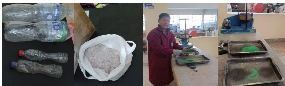
Figura 23. Procedimiento para la elaboración y obtención del aditivo PET Nota. Elaboración propia 2023
