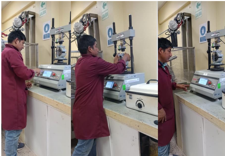
Figura 53 Ensayo Resistencia de Mezclas Bituminosas Flujo Marshall
