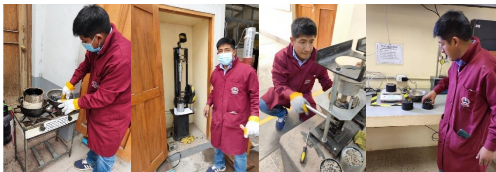
Figura 40. Procedimiento para la Elaboración de Probetas de Asfalto
