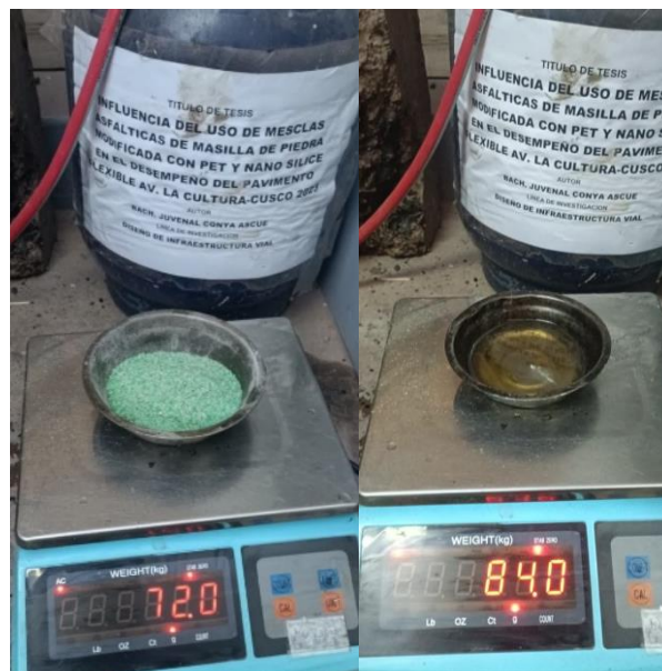
Figura 50 Pesos de los Aditivos Como Adición a la SMA
