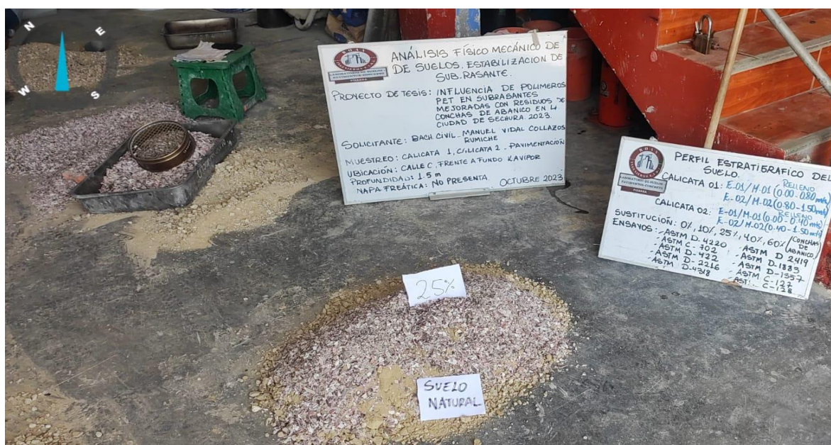
Figura 19. Preparación de muestra con adición de 25% de RCA
