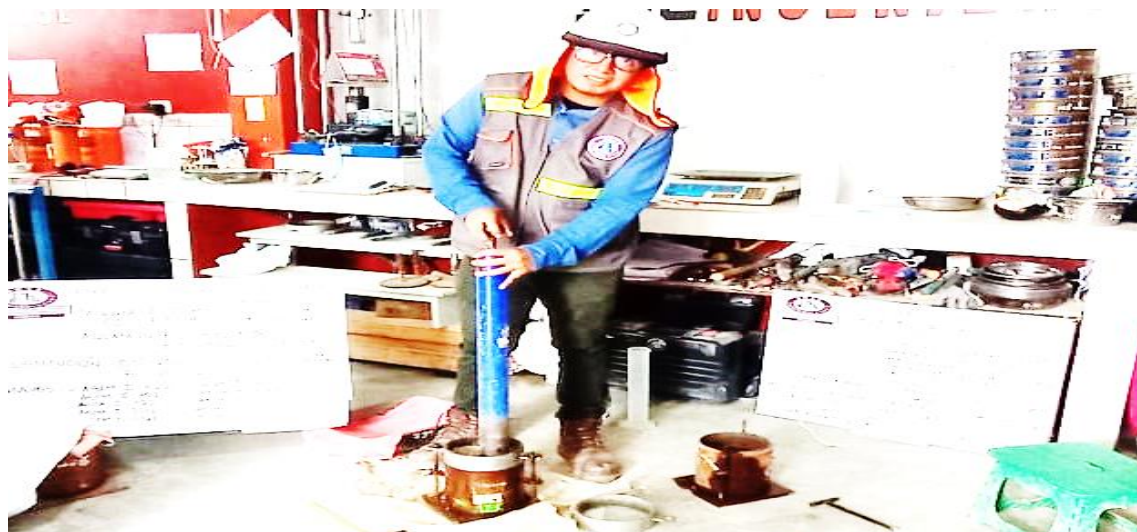
Figura 9. Ensayo de proctor modificado
