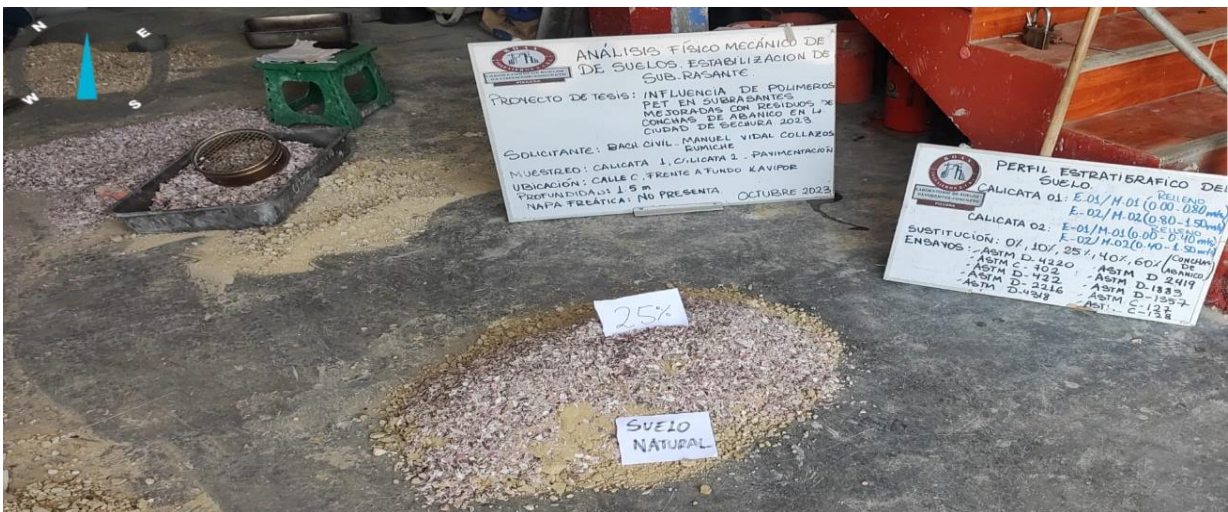
Suelo natural con adición del 25% de RCA
