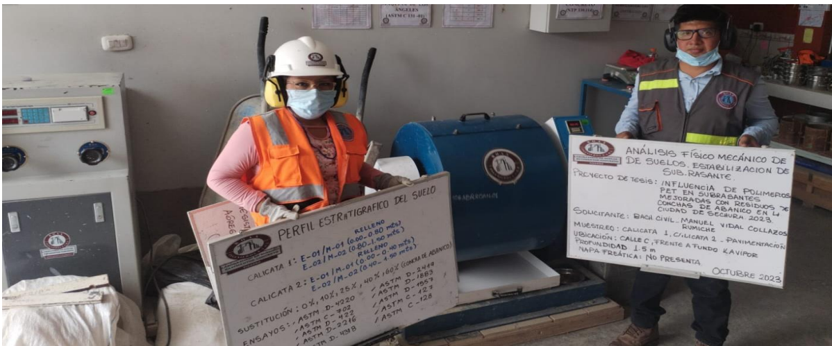
Ensayo de Abrasión los Ángeles
