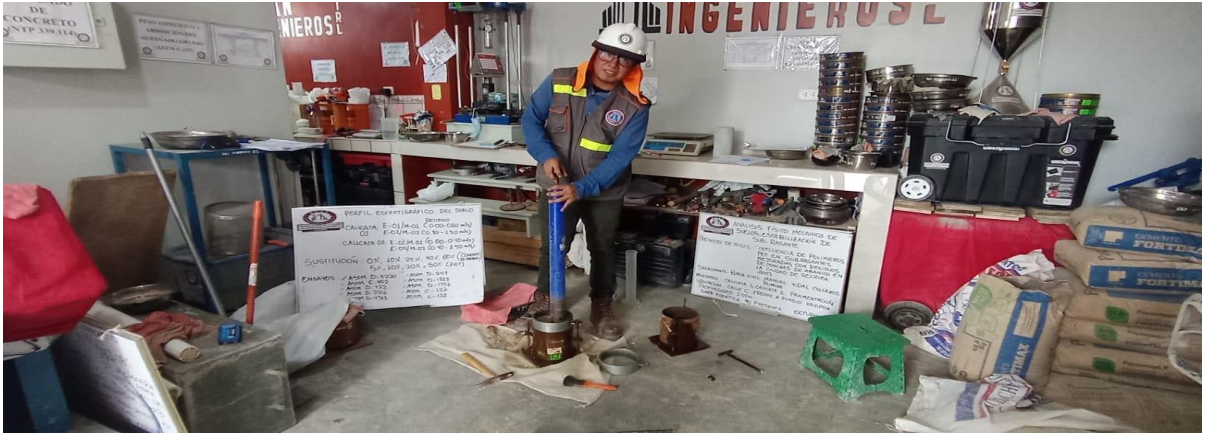
Ensayo de proctor modificado en Laboratorio Roan Ingenieros
