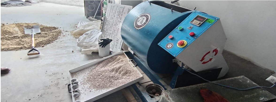
Figura 15. Ensayo de Abrasión Los Ángeles
