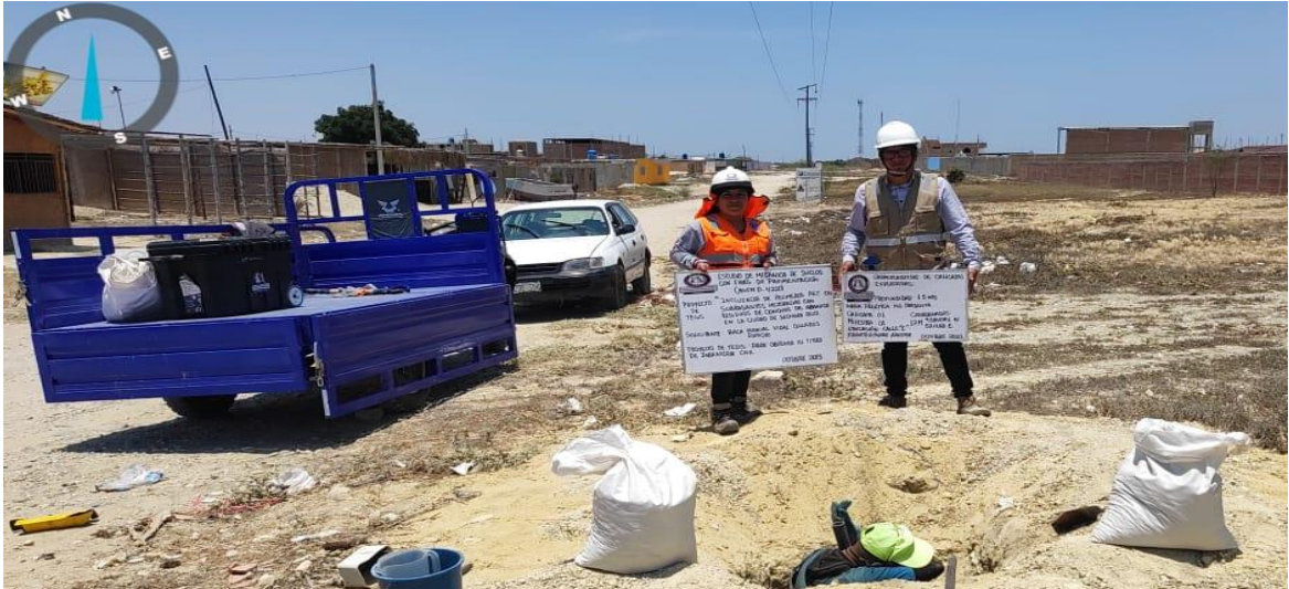
Figura 7. Extracción de muestras de calicata 01
