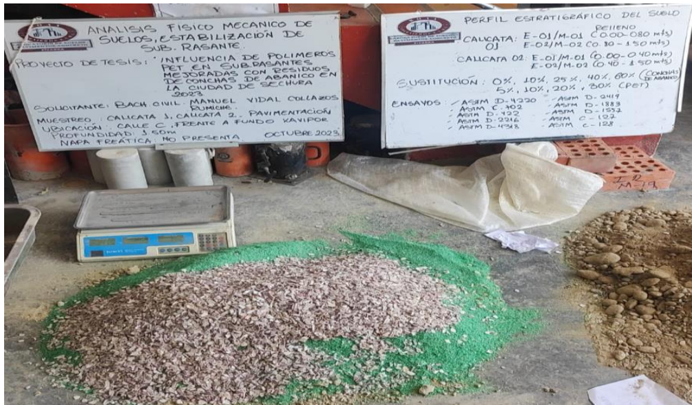
Figura 23. Preparación de muestra con adición de 25% de RCA (más óptimo) + 10% PET
