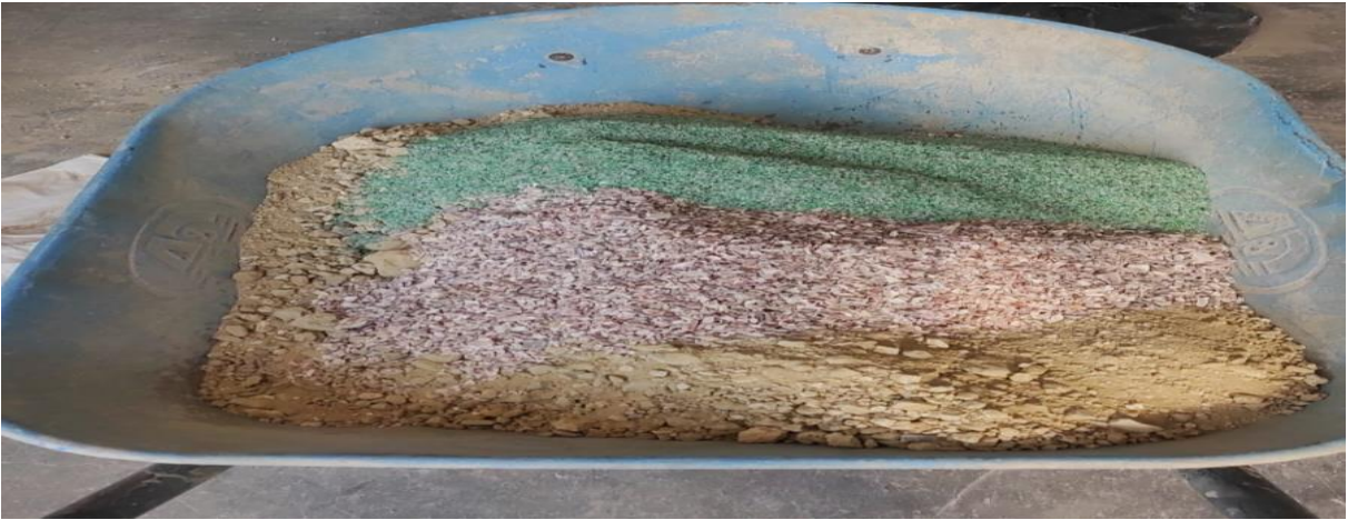
Incorporación de 10 % de PET a la muestra optima (25% RCA)
