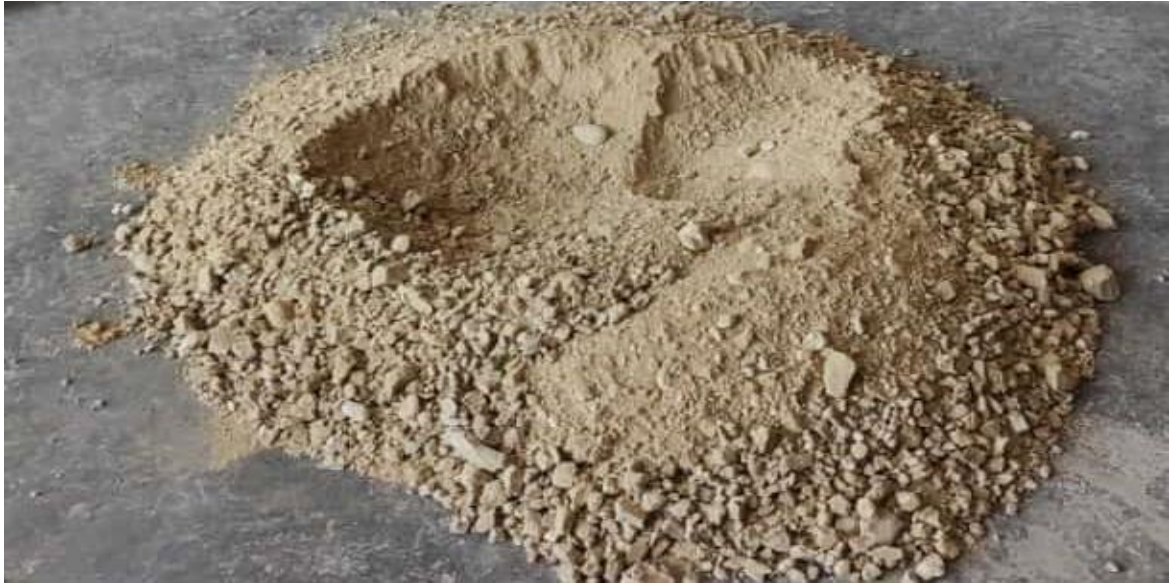
Figura 12. Muestreo por cuarteo del suelo natural
