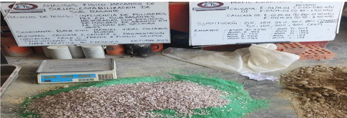
Incorporación de 20% de PET a la muestra optima (25% RCA)
