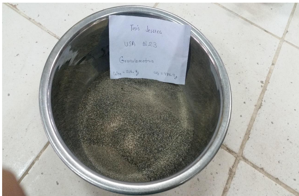
Figura 3. 5. Muestra del agregado fino para el análisis granulométrico
