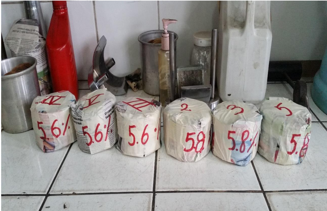
Figura 3. 8. Briquetas expuestas a condiciones normales por 24 H
