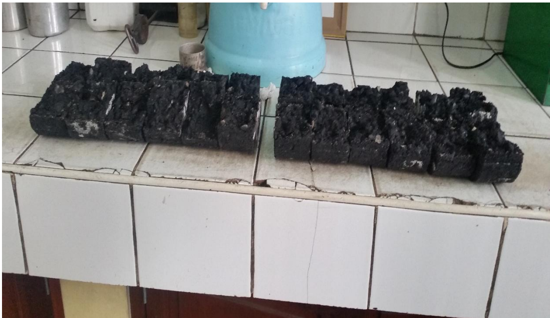
Figura 3. 11. Vista de briquetas después de la rotura
