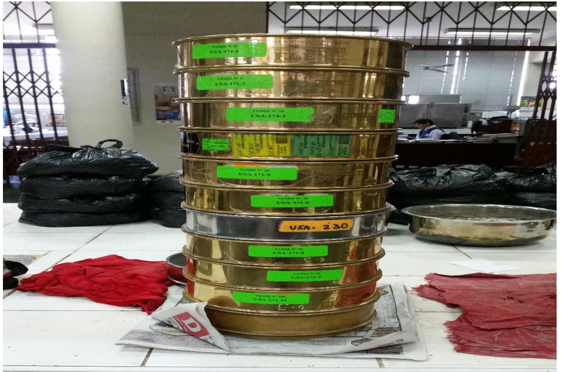
Figura 3. 6. Tamizado del agregado fino
