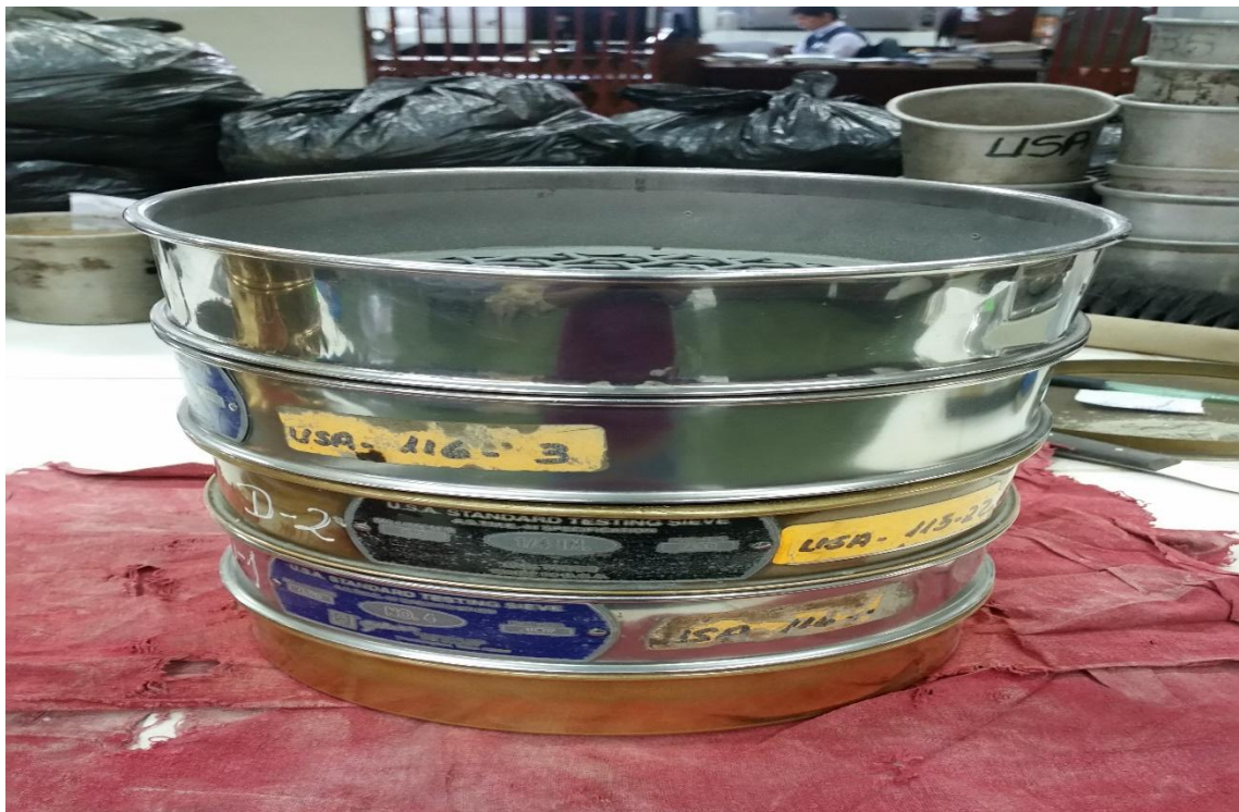
Figura 3. 4. Tamizado del agregado grueso
