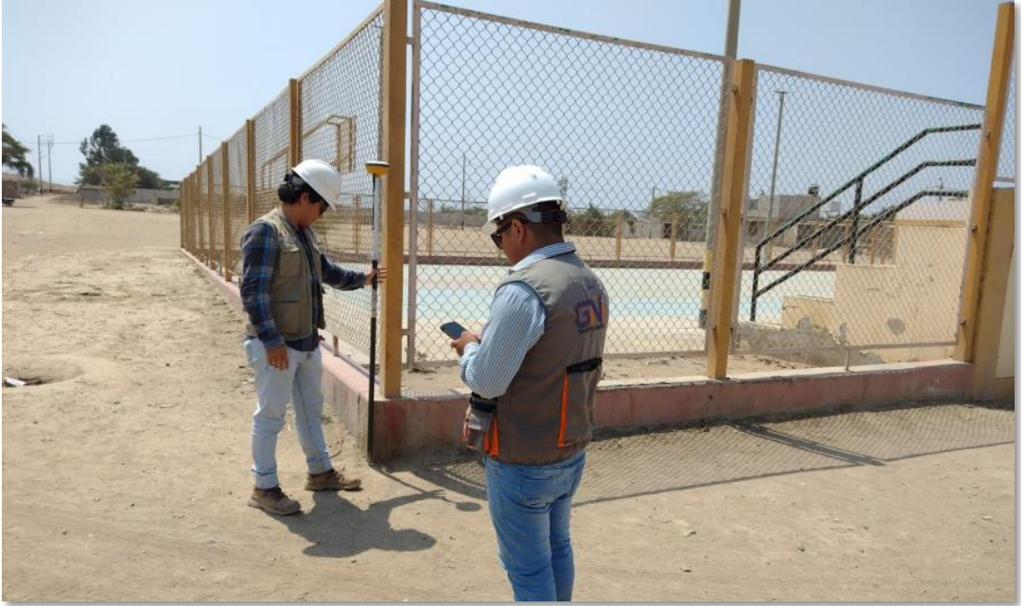
Figura 11. levantamiento topográfico de la losa deportiva.
