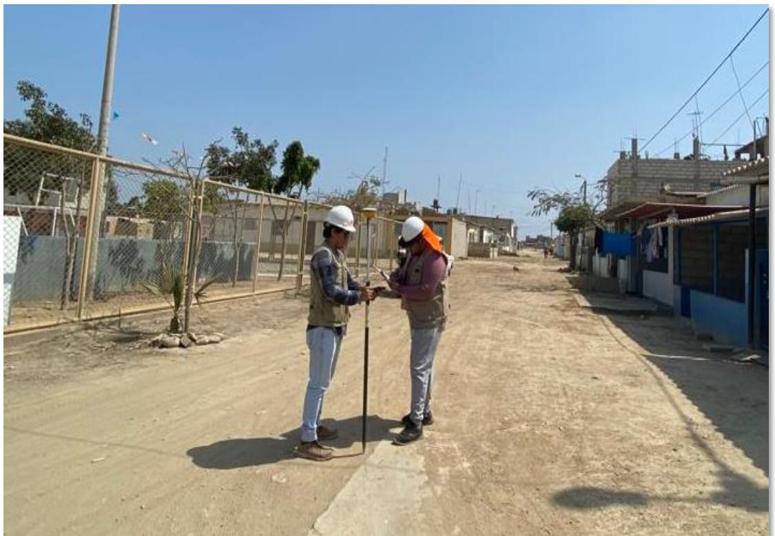
Figura 12. Toma de puntos con sus respectivas coordenadas UTM.
