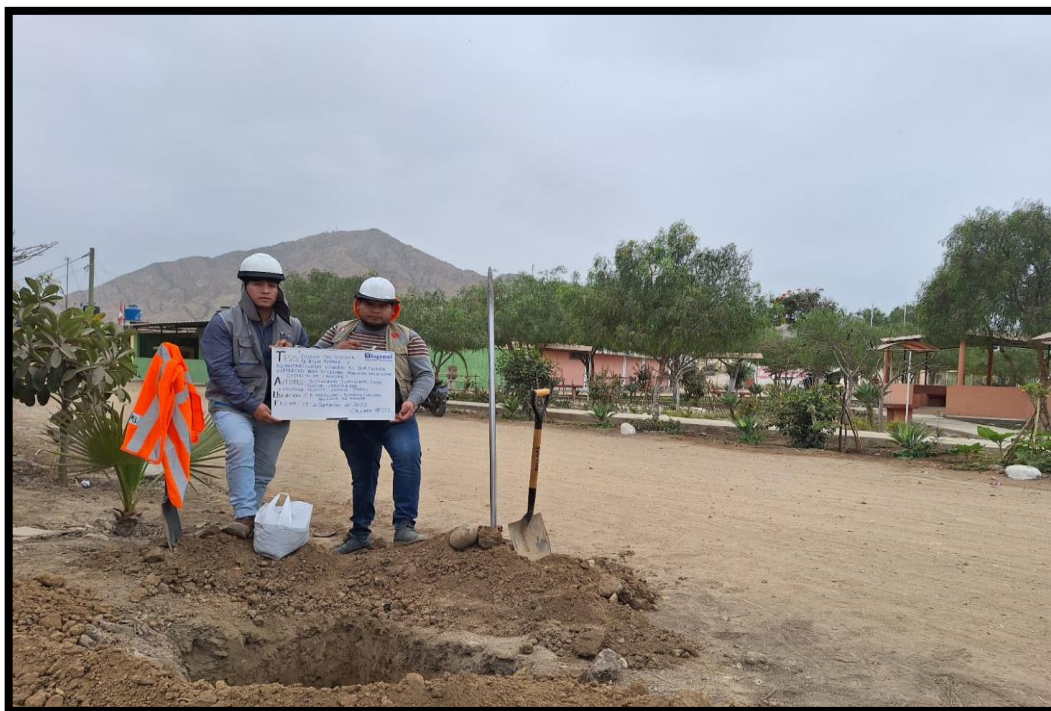
Figura 14: Realización de calicatas con profundidad de 1.50 m, con fin de obtener una visión directa del terreno.
