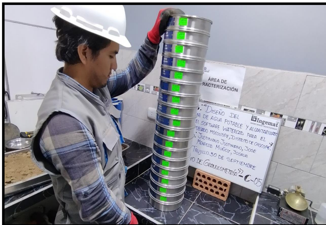
Figura 15: Toma de pesos y desarrollo de tamizado con fines de obtener en porcentajes su contenido de grava, arena y finos.
