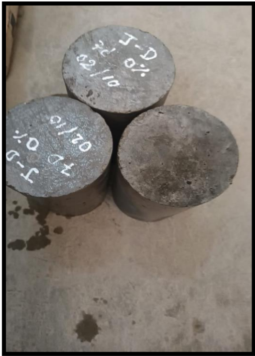
Fotografía 21. Testigos de concretos listos para ser sometidos a ensayo de resistencia a la compresión.
