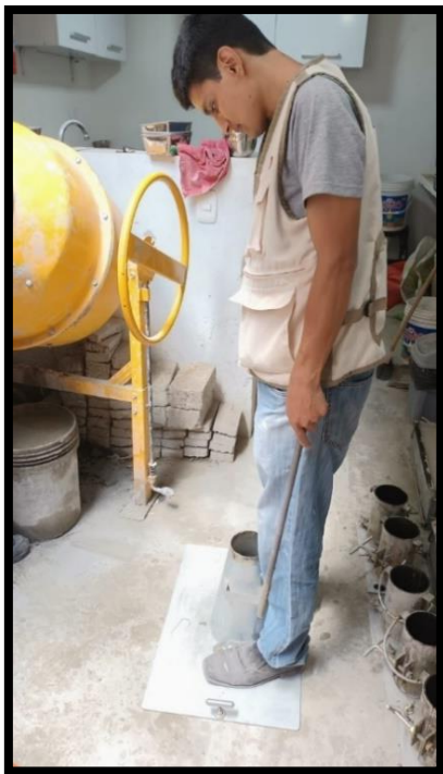
Fotografía 13. Preparando el cono de Abrams para la prueba de Slump.
