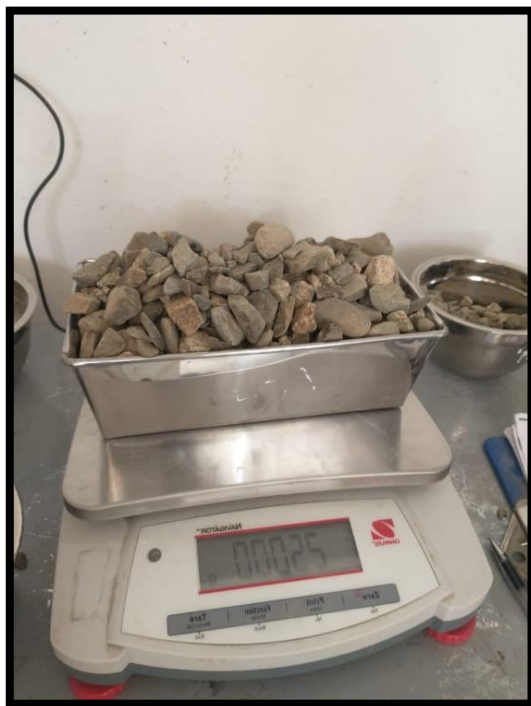
Fotografía 4. Proceso de pesado del agregado grueso
