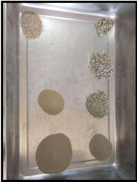
Fotografía 7. Proceso de cuarteo del agregado fino
