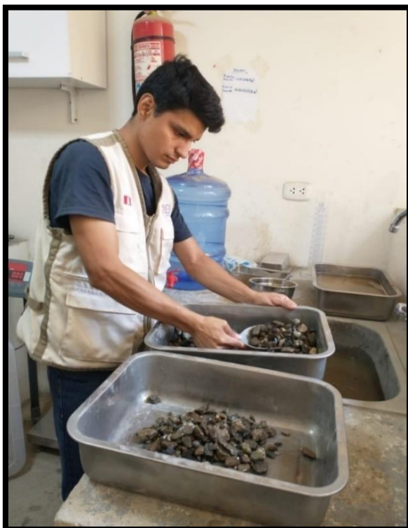
Fotografía 8. Preparando para el ensayo granulométrico del agregado grueso
