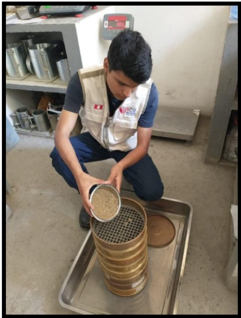
Fotografía 11. Ensayo granulométrico del agregado fino.
