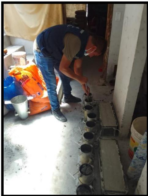
Fotografía 16. Proceso de chuseado de los testigos de concreto con adición de arcilla y vidrio reciclado.
