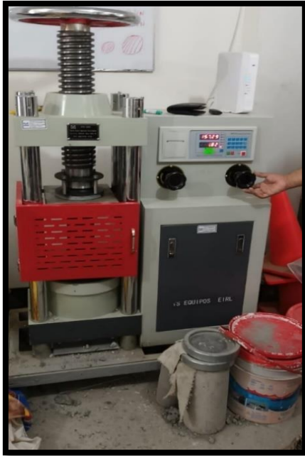
Fotografía 23. Prensa para hallar la resistencia a la compresión de los testigos de concreto.
