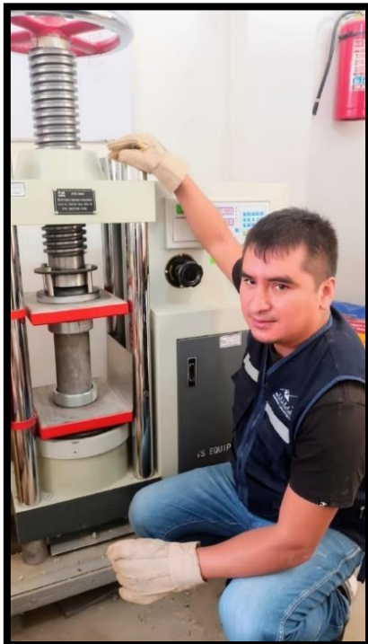
Fotografía 24. Sometiendo al ensayo de resistencia a la compresión de testigo de concreto.
