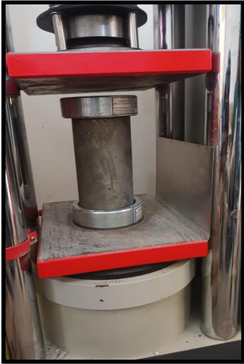
Fotografía 25. Se evidencia la probeta sometida a compresión.
