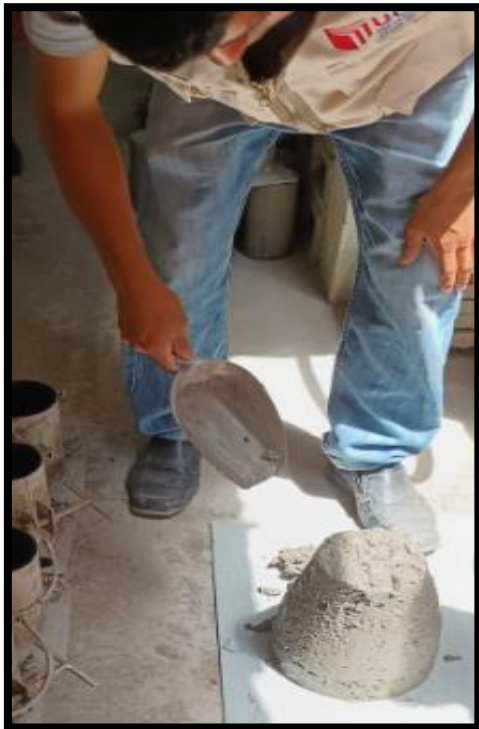
Fotografía 15. Tomando medida de la prueba Slump.
