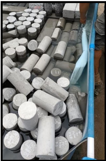
Fotografía 20. Proceso de curado de los testigos de concreto.
