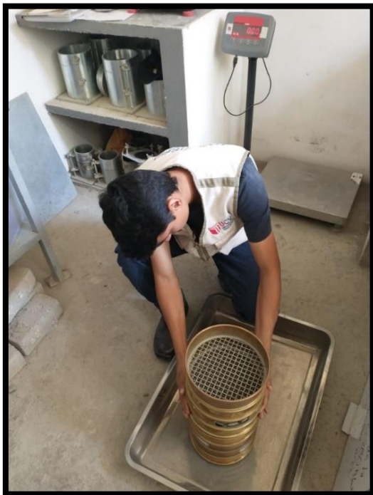
Fotografía 10. Preparando los tamices para el ensayo granulométrico.
