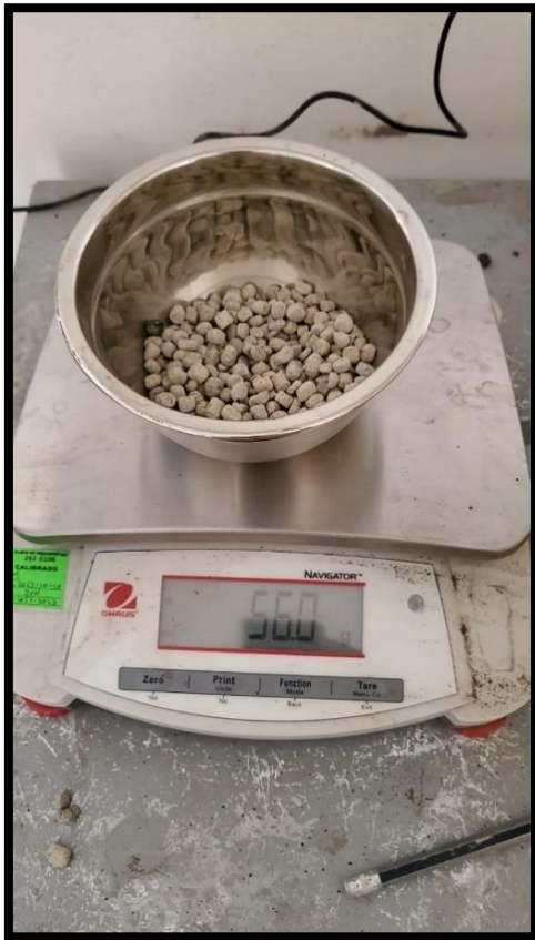
Fotografía 5. Proceso de pesado de la arcilla expandida
