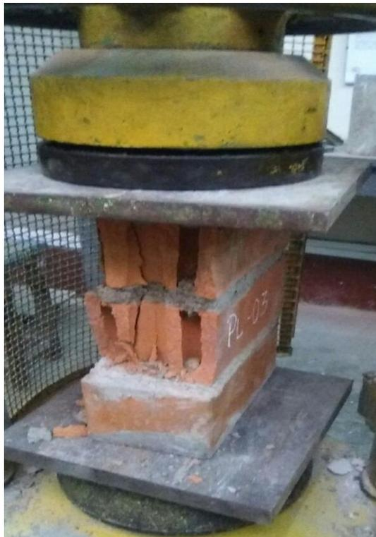
*Figura 3.6. La pila con ladrillo King Kong 30% cuando falla por la carga aplicada.*
