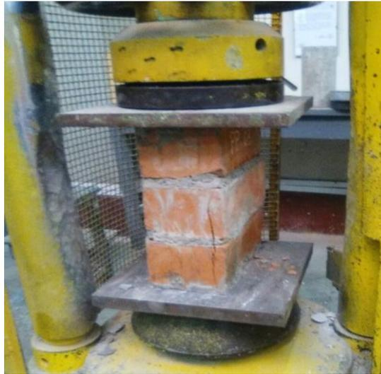
*Figura 3.5. Pila con ladrillo king kong 18 H en la máquina de compresión.*
