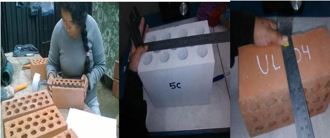
**Figura 3.1.** Realizando el ensayo de variación dimensional de los tres tipos de unidades de albañilería.
