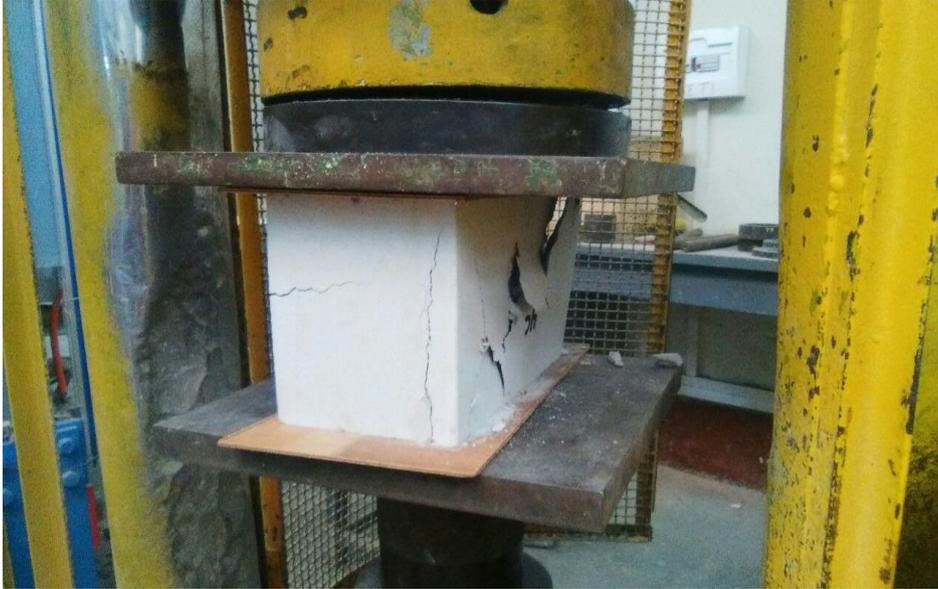
**Figura 3.2.** El Ladrillo sílico calcáreo KK 11 Huecos en la máquina de compresión.
