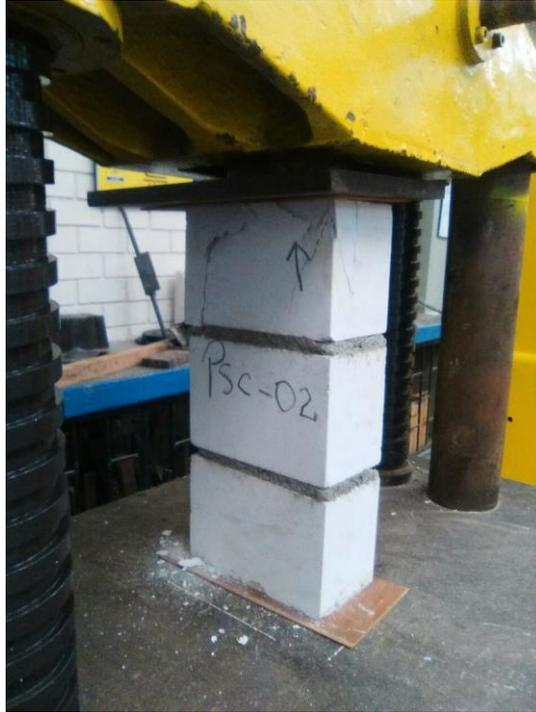
**Figura 3.7.** Pila con ladrillo sílico calcáreo en el ensayo de resistencia axial.
