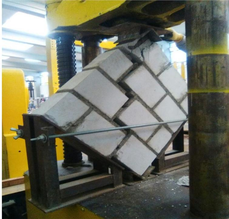
**Figura 3.11.** Murete con ladrillo kk 30% donde se observa la falla por la junta por la falta de adherencia.
