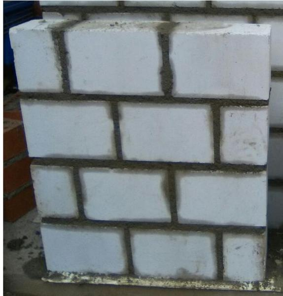
**Figura 3.8.** Murete con ladrillo sílico calcáreo.
