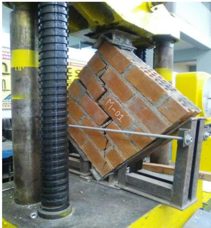
**Figura 3.10.** Murete con ladrillo kk 30% donde se observa la falla diagonal en las juntas.
