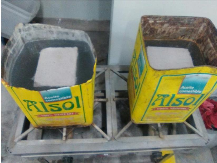
**Figura 3.17.** Se está haciendo hervir las unidades KK 11h para el ensayo de Absorción
