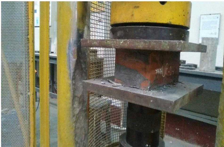
**Figura 3.3.** Aplicando la carga axial a la Unidades de arcilla K K 18 Huecos.
