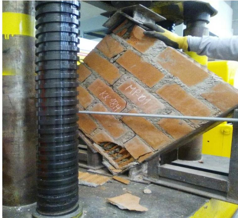
**Figura 3.9.** Murete con ladrillo kk18 H en la máquina de Compresión Diagonal.
