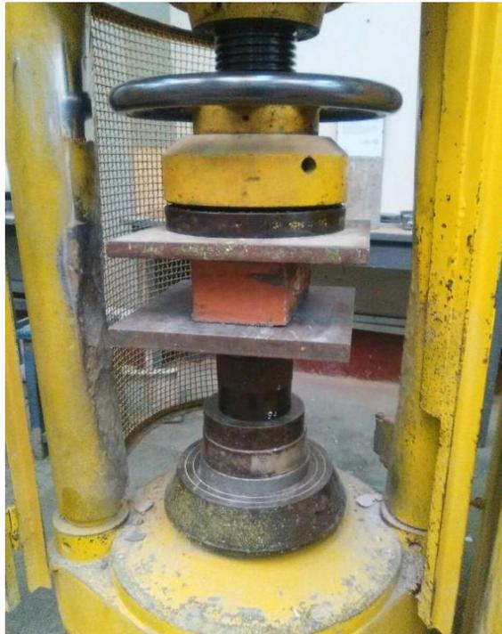
**Figura 3.4.** La Unidades de arcilla King Kong 30% en la máquina de compresión axial.
