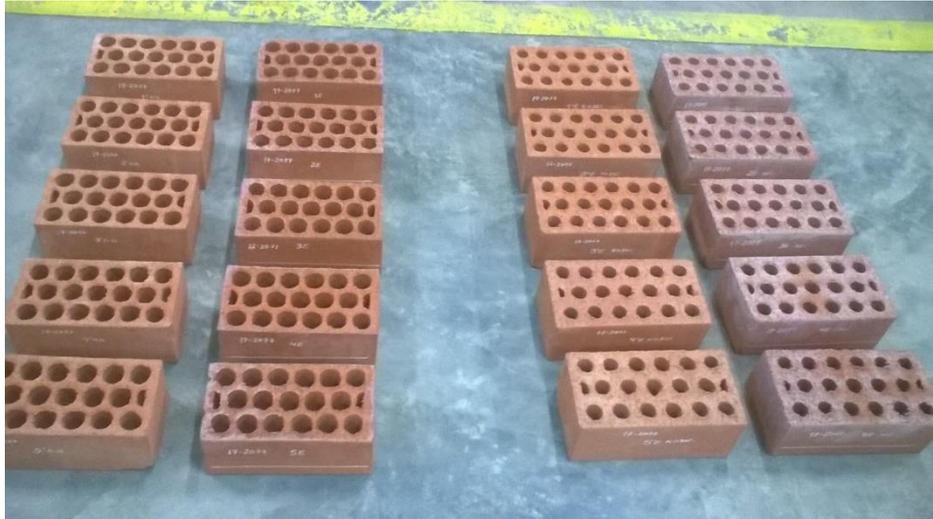
**Figura 3.18.** Ladrillos de arcilla normales vs eflorescencia.
