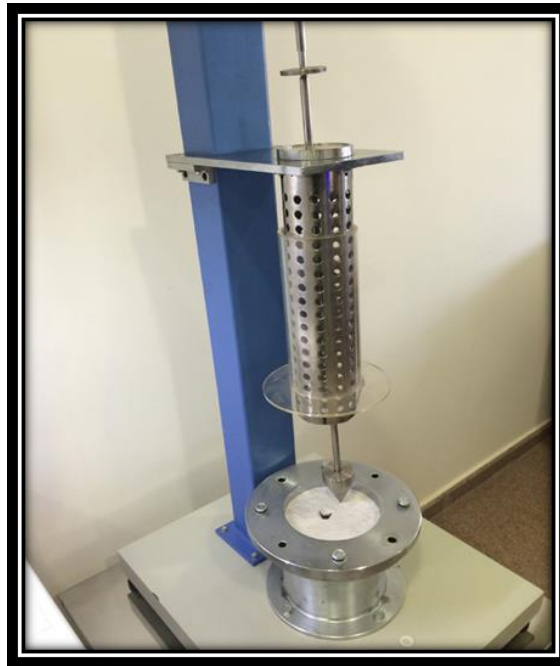
Figura N° 17 http://www.pavco.com.pe/ensayo de perforación
