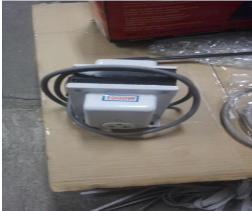
Figura 23. Transformador de Energía
