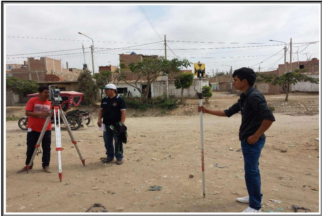
Foto N° 12: Levantamiento topográfico con Estación Total de las Calles del Sector La Tina.
