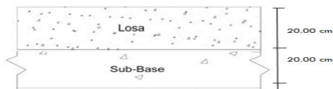
Sección de Pavimentos Rígidos
