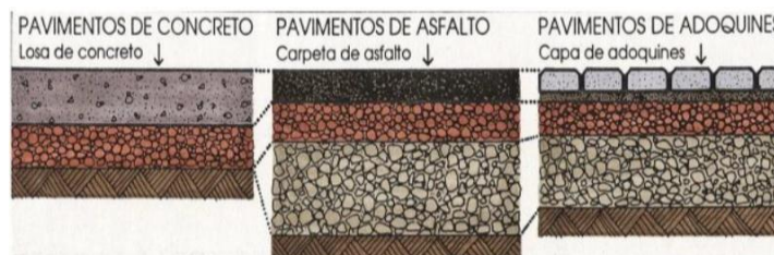
Figura N° 7.01: Tipos de pavimentos
