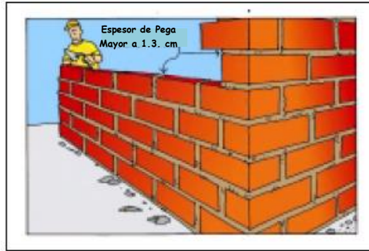
Figura 3.13. Calidad de las Juntas de pega en mortero - Chavarría (2001)
