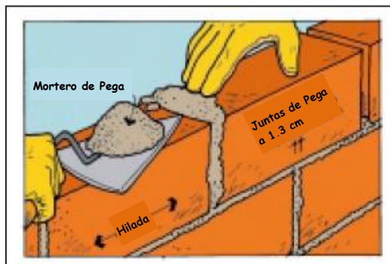
Figura 3.12 Calidad de las juntas de pega en mortero - Chavarría (2001)
