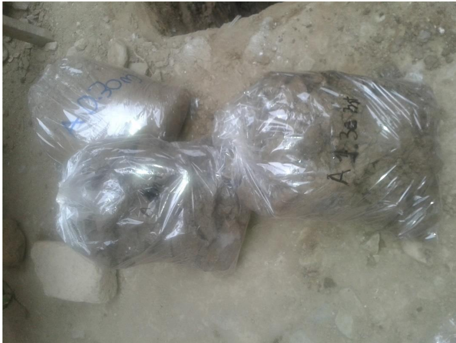
Foto 4: muestras de Calicata C-01 listas para llevar al laboratorio.
