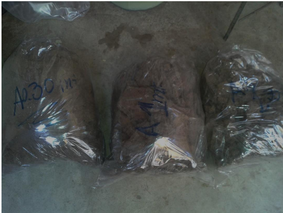
Foto 8: Muestras de Calicata C-02 listas para llevar al laboratorio.
