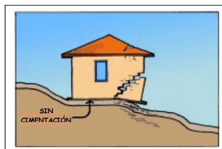
Figura 3.41 Vulnerabilidad alta: cimentación - Chavarría (2001)
