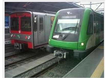
Figura 1.1 tipo de trenes: La unidad de la derecha es un Alstom Metrópolis 9000 y la unidad de la izquierda es un AnsaldoBreda MB300.
