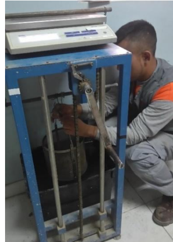
Figura 4.26. Colocación de la canastilla en el equipo de Peso
