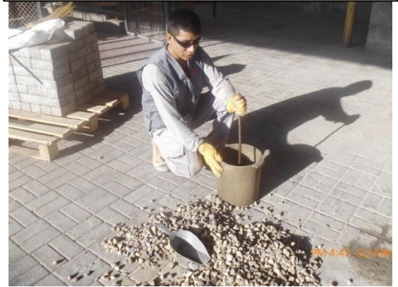
Figura 4.46. Varillado de la última capa
