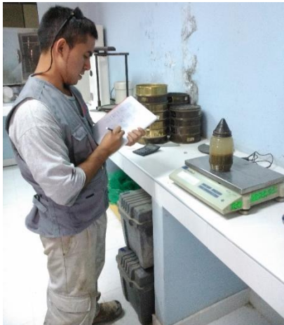
Figura 4.39. Obtenemos la masa de la muestra SSS + agua + recipiente.
