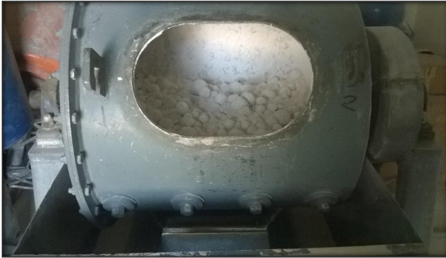
Figura 3.10. Vista del molino de bolas con muestra en su interior
