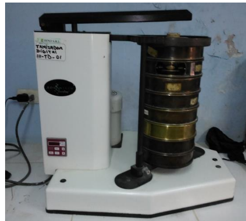
Figura 4.14. Luego del tamizado se retiran los tamices y se procede a pesar el agregado retenido en cada
