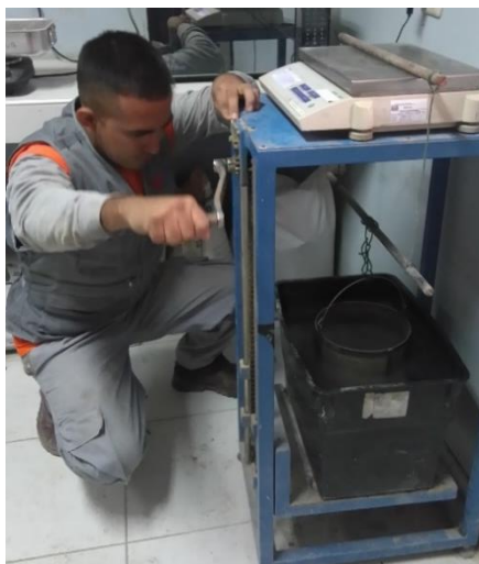
Figura 4.27. Se sumerge la canastilla junto con el material SSS en el agua, hasta cubrirlo
