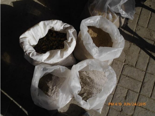
Figura 4.48. Dosificación y obtención de la masa de los materiales.
