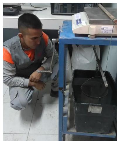
Figura 4.28. Se obtiene y registra la masa de la canastilla junto con el material SSS sumergido en agua.
