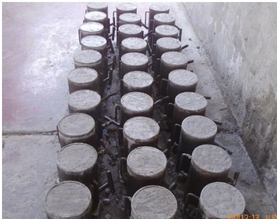
Figura 4.71. Al día siguiente, luego de alcanzar el estado endurecido, las probetas ya están listas para su desencofrado.
