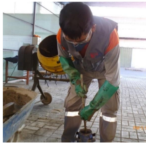
Figura 4.57. Varillado en forma de espiral, compactando 25 veces cada capa..
