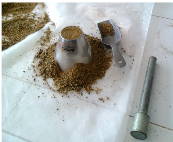
Figura 4.33. Se obtiene la condición SSS a través del ensayo con el cono de absorción
