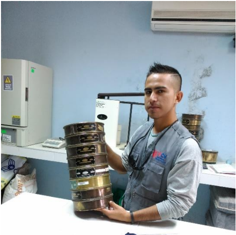
Figura 4.10. Tamices listos para recibir la muestra del agregado a
