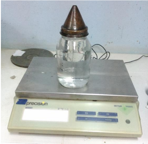
Figura 4.35. Se obtiene la masa del picnómetro junto con el agua en su
