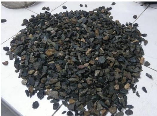
Figura 4.21. Después de cumplir el tiempo de saturación, el agregado es retirado del recipiente con agua
