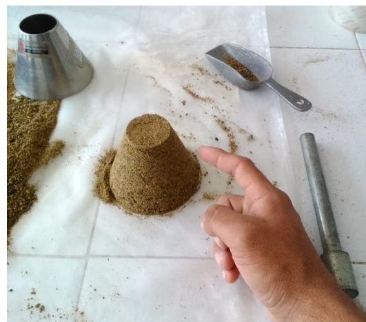
Figura 4.34. Una vez obtenida la condición SSS, se procede a obtener la masa mínima
