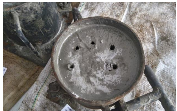
Figura 4.79. Vista del mortero mostrando en su superficie los agujeros que indican que han sido sometidos a ensayos de penetración.
