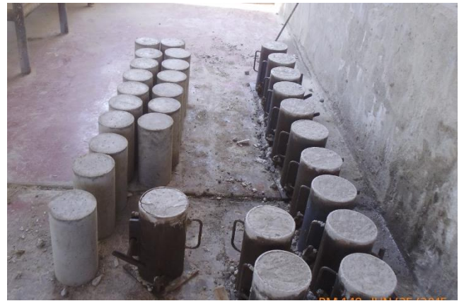
Figura 4.72. Vista del desencofrado de las probetas.
