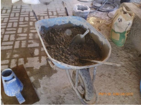
Figura 4.54. Obtención de la muestra del concreto fresco.
