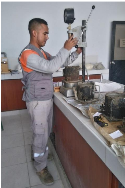
Figura 4.76. Ensayo resistencia a la penetración para determinar el tiempo de fraguado inicial y final.
