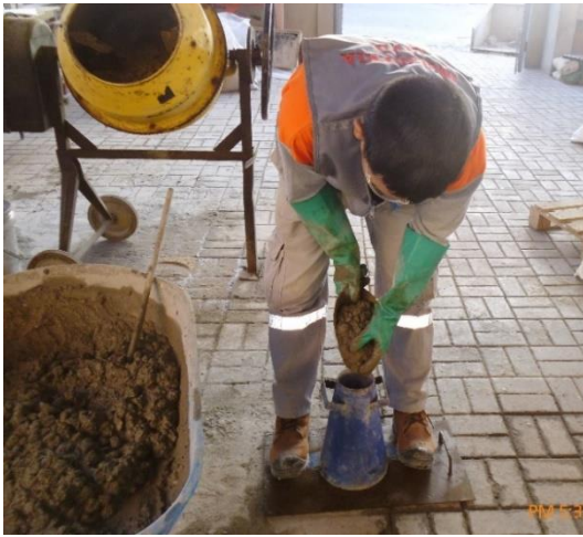
Figura 4.56. Inicio del ensayo de asentamiento.
