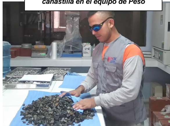
Figura 4.22. El agregado es secado superficialmente, hasta quitar el brillo superficial a
