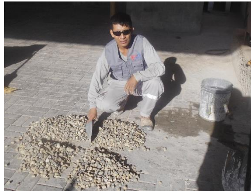
Figura 4.5. Vistas del método del cuarteo realizado
