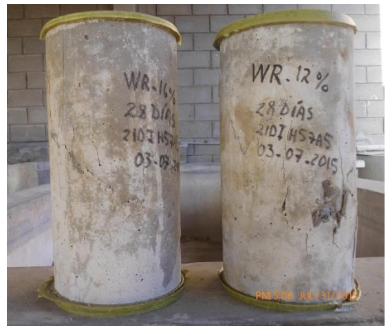
Figura 4.85. Vistas de las fracturas de las probetas ensayadas.
