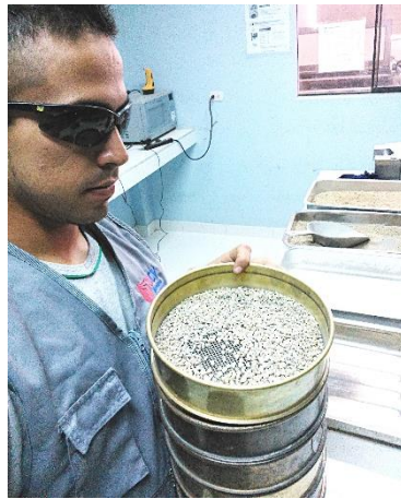
Figura 4.13. Se procede a colocar la tapa protectora para evitar derrames y/o pérdidas de material.
