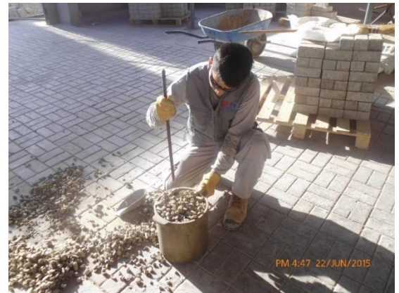
Figura 4.46. Varillado de la última capa
