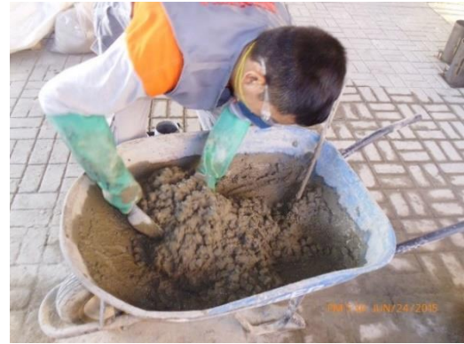
Figura 4.55. Remezclado y homogenización del concreto antes de iniciar el ensayo.
