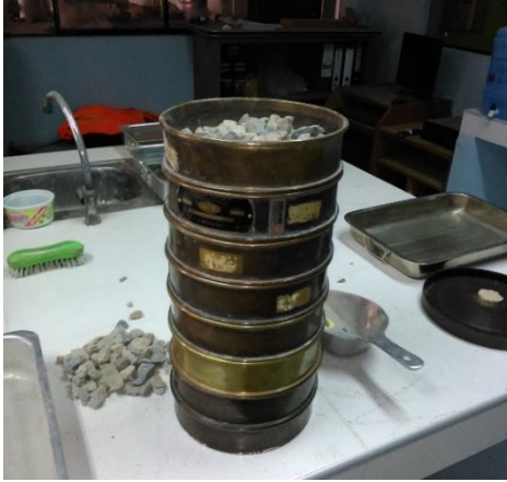
Figura 4.11. Muestras en el interior de los tamices, listo para el respectivo
