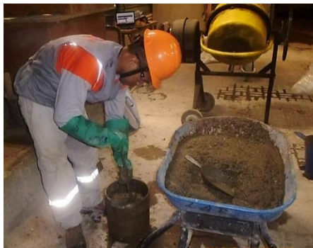
Figura 4.60. Ejecución Del ensayo de peso unitario del concreto fresco.
