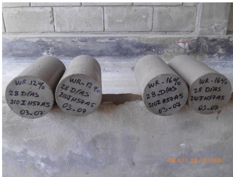
Figura 4.80. Extracción de las probetas de la poza de curado.
