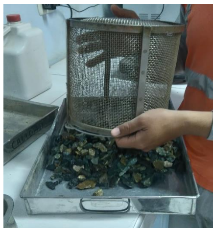
Figura 4.23. Se procede a obtener la masa de la muestra SSS.
