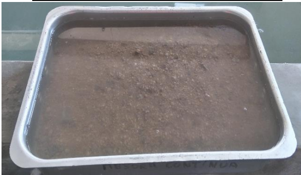
Figura 4.31. Después de ser tamizado, el agregado es sumergido en agua durante 24
