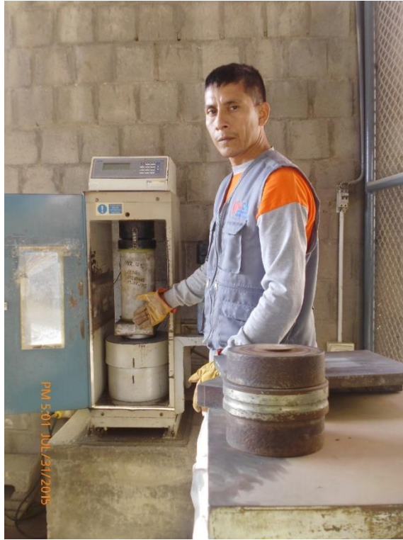
Figura 4.83. Ingreso de la probeta al interior de la prensa
