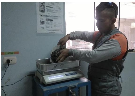
Figura 4.29. Se extrae la muestra de la canastilla en una bandeja.
