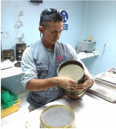
Figura 4.18. Peso retenido de un tamiz de agregado fino.
