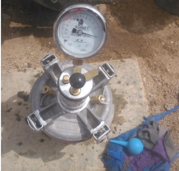
Figura 4.63. Ensayo del contenido de aire, a través del método de presión.
