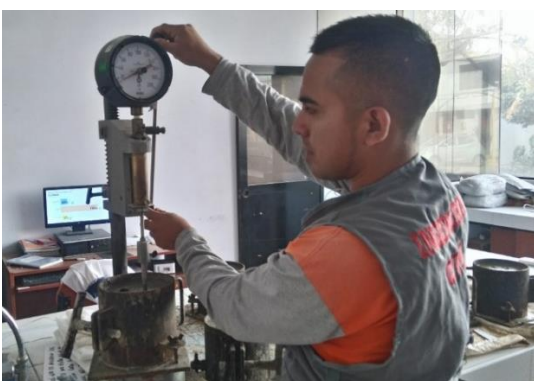
Figura 4.78. Vista del penetrómetro y la aplicación de carga en la muestra de mortero
