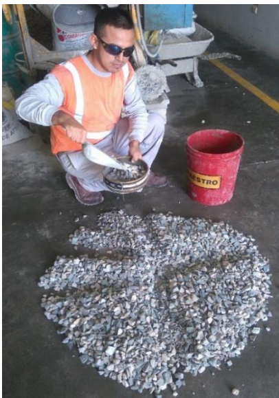
Figura 4.20. Después de ser tamizado, el agregado es sumergido en agua durante 24
