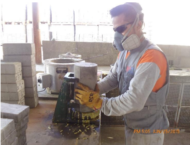
Figura 4.88. Ejecución del refrentado, manteniendo la perpendicularidad del espécimen.
