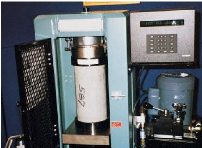
Ensayo a compresión de cilindro de concreto de 150 x 300 mm (6 x 12 pulg.); la carga en el ensayo es registrada en la
