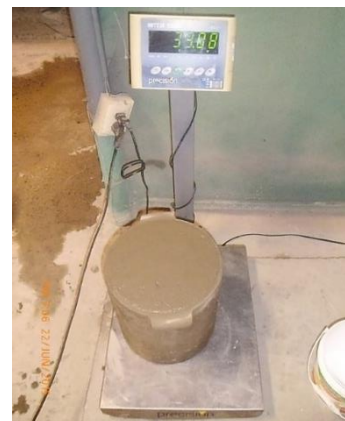
Figura 4.62. Obtención de la masa del concreto fresco, para ser usado en el cálculo del peso
