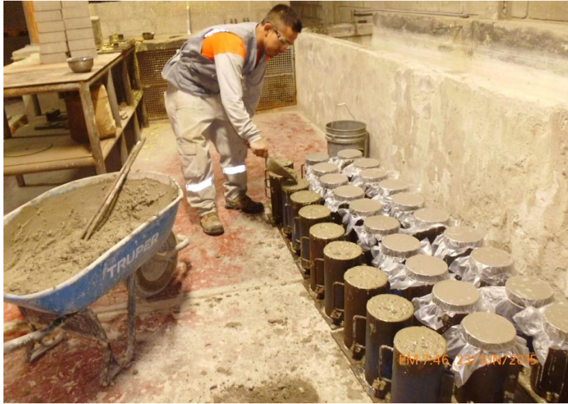
Figura 4.68. Vista de la elaboración de probetas, llenado de la
