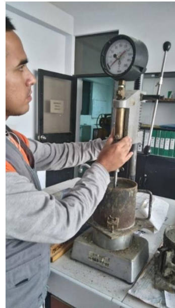
Figura 4.77. Vista de la colocación de la muestra para ser ensayada.
