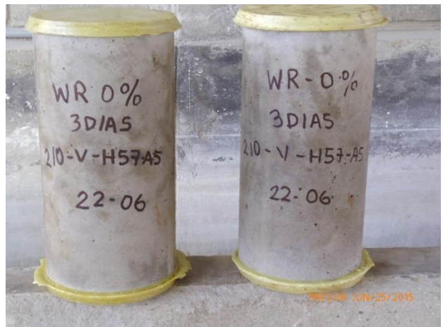
Figura 4.89. Vistas de las probetas luego de ser refrentadas.
