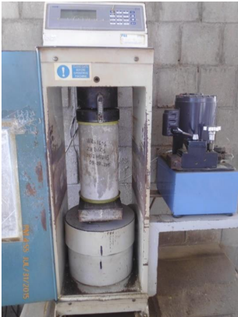
Figura 4.84. Ensayo de resistencia a la compresión.
