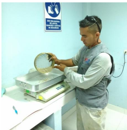
Figura 4.15. El peso retenido de cada tamiz es pesado en la balanza de aproximación 0.1 aramos.
