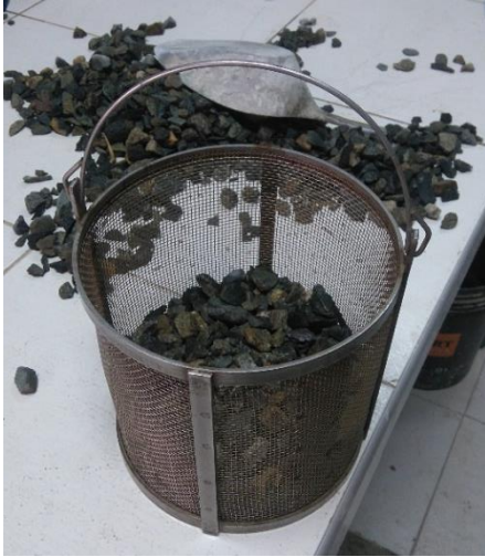
Figura 4.25. Se ingresa el material SSS en la
