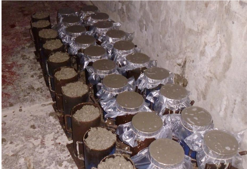
Figura 4.70. Después del acabado se protege con una bolsa plástica, para evitar la pronta evaporación y pérdida de agua del concreto.
