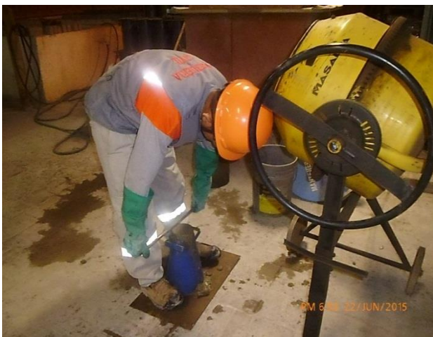
Figura 4.58. Enrasado de la última capa, se procede a levantar de forma vertical respetando los tiempos
