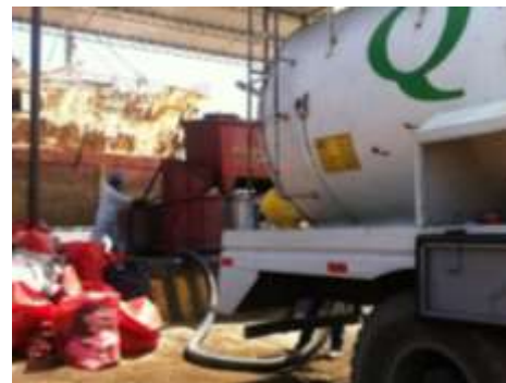
Figura 05: Evacuación de líquidos peligrosos Fuente: PAP SIMA Chimbote
