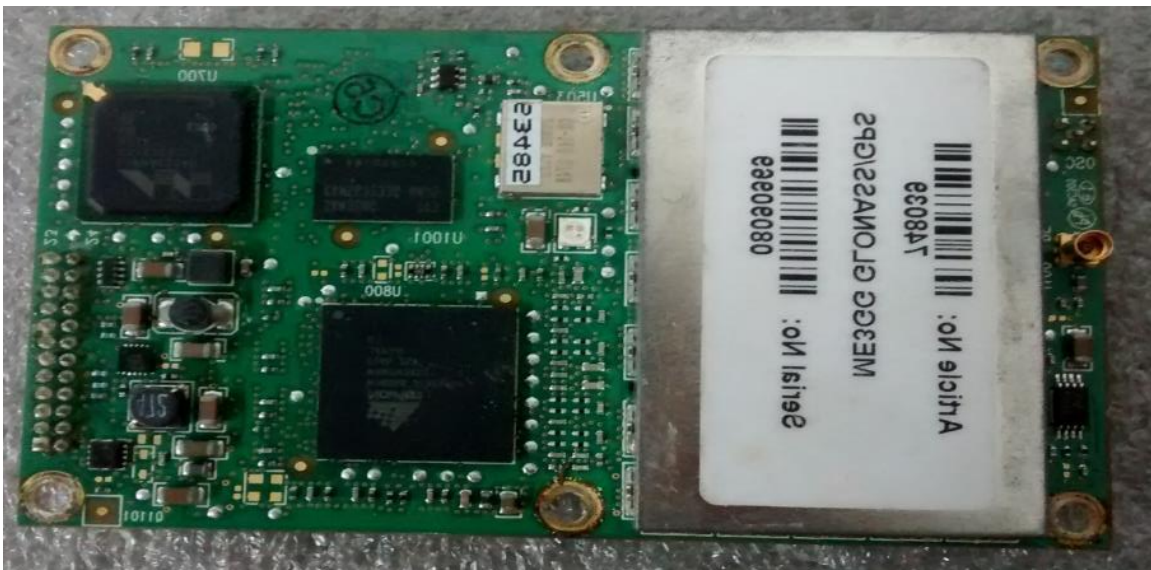
Tarjeta GPS alta precisión del Sistema de control de flotas Leica Geosystems averiada por la soldadura de arco eléctrico en el taller de Mina Yanacocha.
