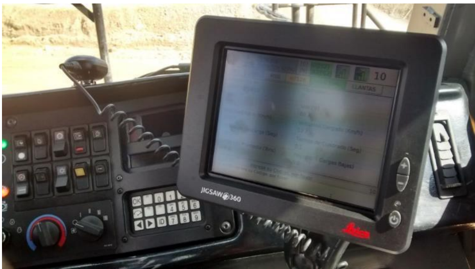
Instalación de pantalla del sistema de control de flotas Leica Geosystems en el interior de la cabina de un camión 793C.
