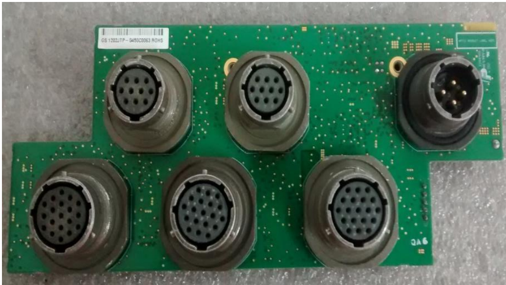
Tarjeta de conectores del Sistema de control de flotas Leica Geosystems vista frontal averiada por efectos de la soldadura de arco eléctrico en Mina Yanacocha.
