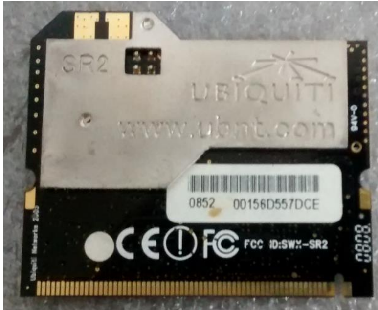
Tarjeta Wifi del Sistema de control de flotas Leica Geosystems.
