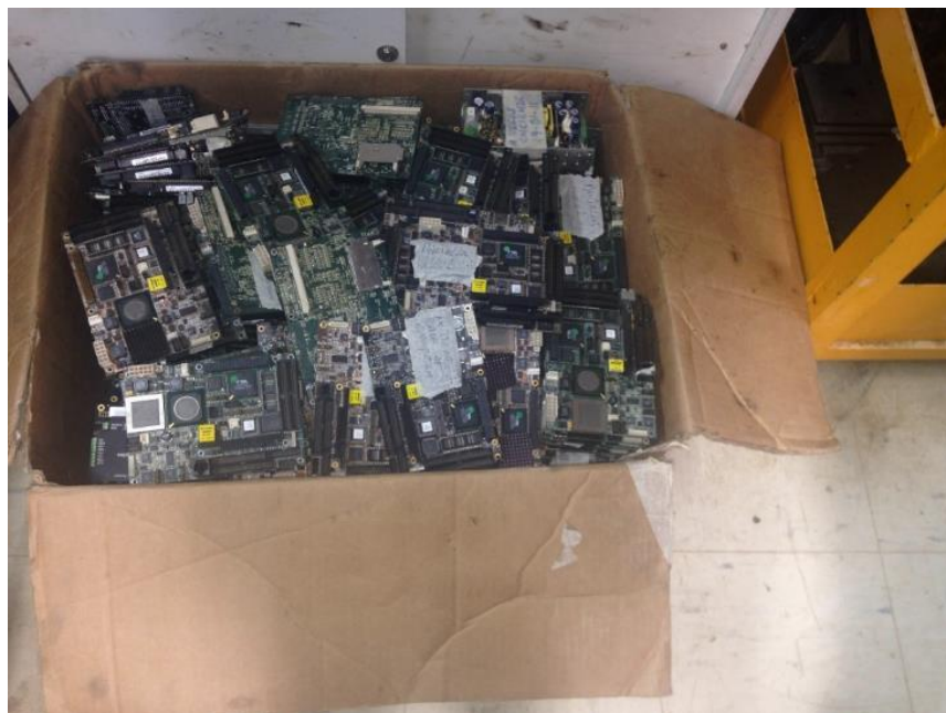
Tarjetas madre inoperativas del Sistema de control de flotas Leica Geosystems la cual fueron desechados.
