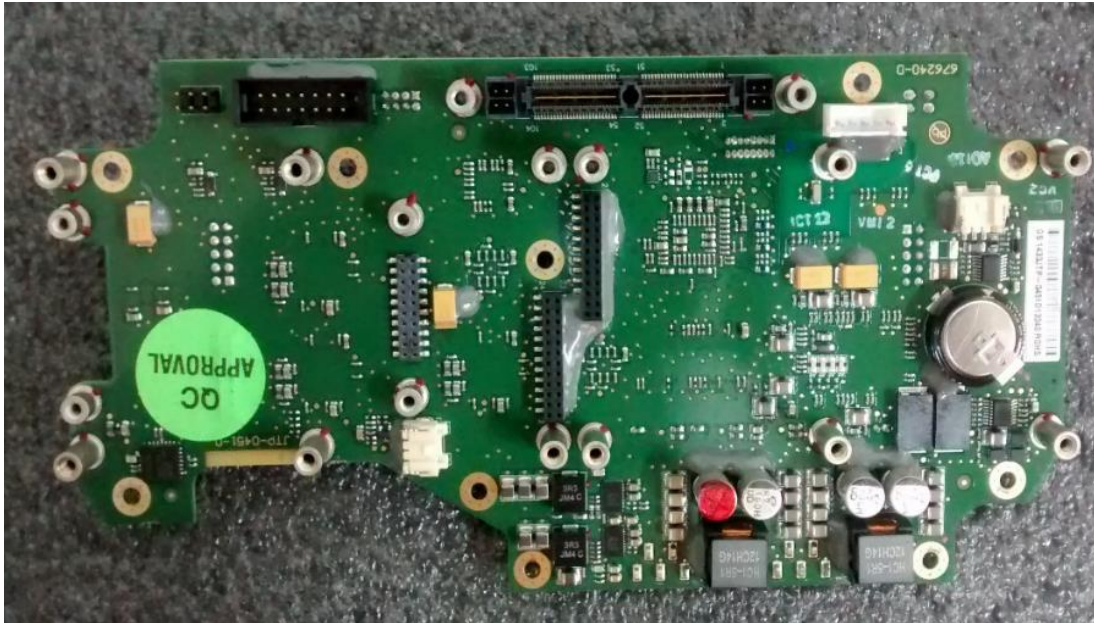
Tarjeta madre del Sistema de control de flotas Leica Geosystems averiada por la soldadura de arco eléctrico en el taller de Mina Yanacocha.
