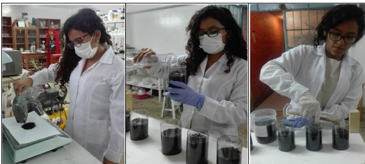
FUENTE: ELABORACIÓN PROPIA FIGURA N° 24 A) PESAJE DEL CARBÓN ACTIVADO (100G), B) APLICACIÓN DEL AGUA DE MAR (250ML), C) APLICACIÓN DEL LICOR NEGRO
