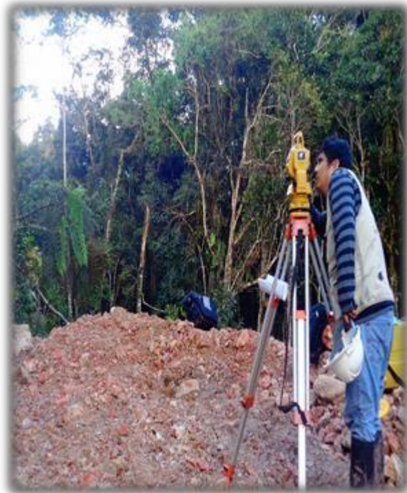
FOTO N° 02: Personal tomando datos de la poligonal de apoyo.
