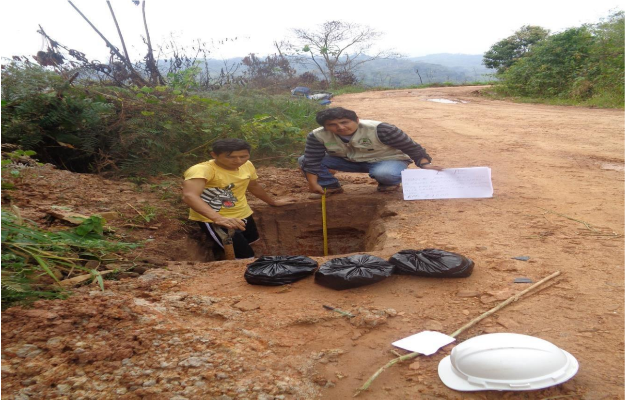
FOTO N° 05: Apreciamos las muestras y la profundidad (1.50) de la calicata 5 para los ensayos correspondientes en el laboratorio de suelos.
