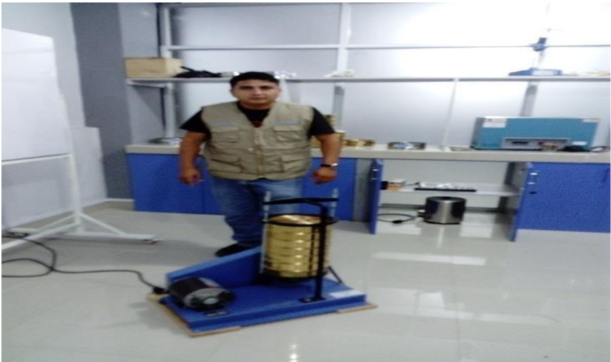
FOTO N° 08: Apreciamos en el laboratorio de mecánica de suelos realizando el ensayo de granulometría.
