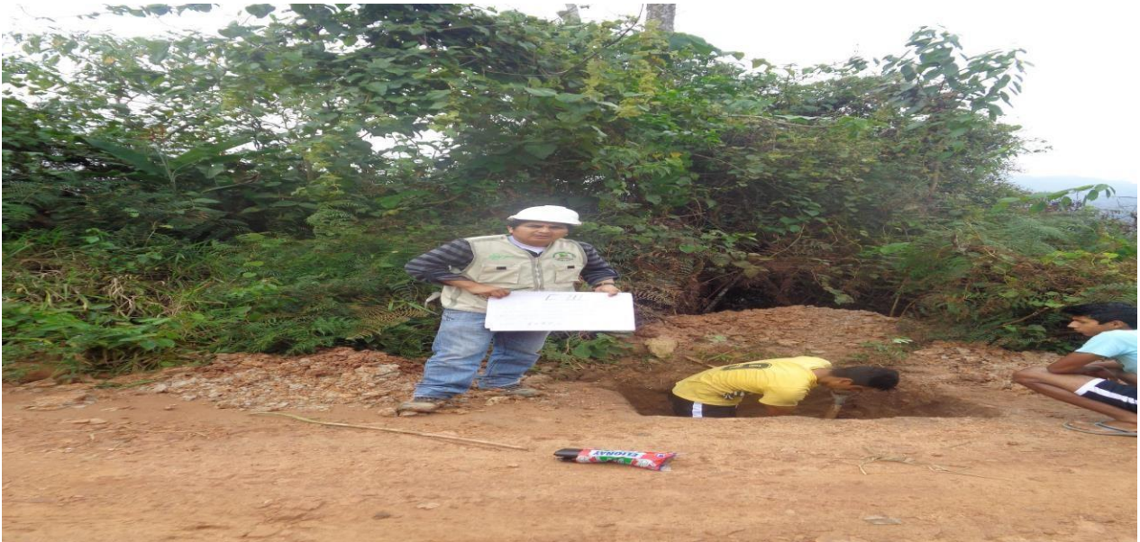
FOTO N° 06: Apreciamos las muestras y la profundidad (1.50) de la calicata 7 para los ensayos correspondientes en el laboratorio de suelos.
