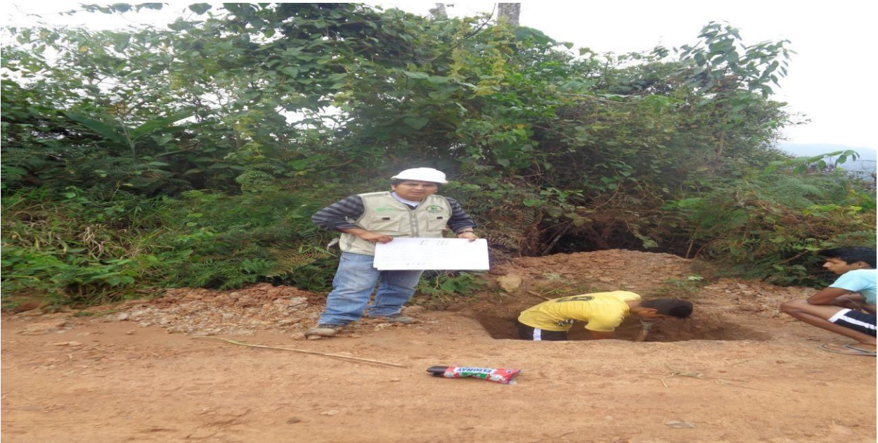
FOTO N° 01: realizando trabajos de extracción de muestras de calicatas para realizar los ensayos correspondientes.
