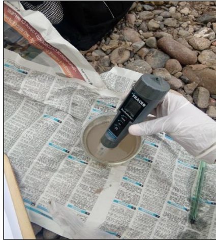
Figura 13. Mediciones de temperatura y pH in situ.
