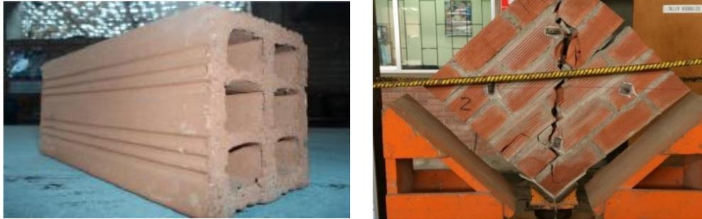
Figura 0-7: Unidades de albañilería pandereta típicas. Fuente: Arquñigo (2011).
