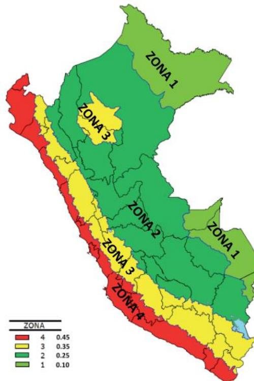
Figura 0-1: Zonificación del peligro sísmico en el Perú, de acuerdo con la norma E030 (E030, 2016:p.2).
