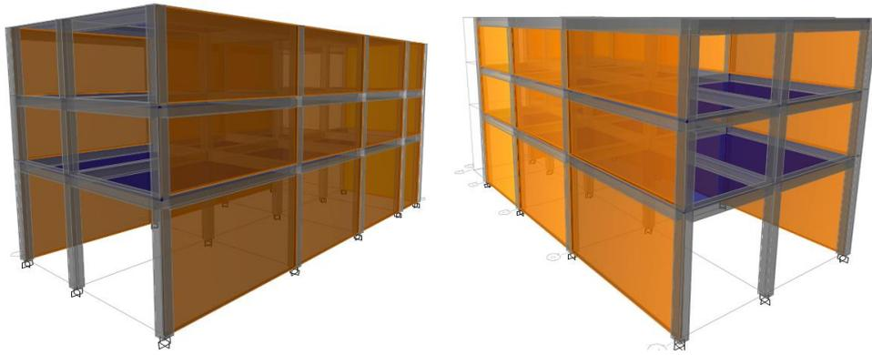
Figura 3-13: Modelo tridimensional generado en ETABS. Fuente: Elaboración propia.
