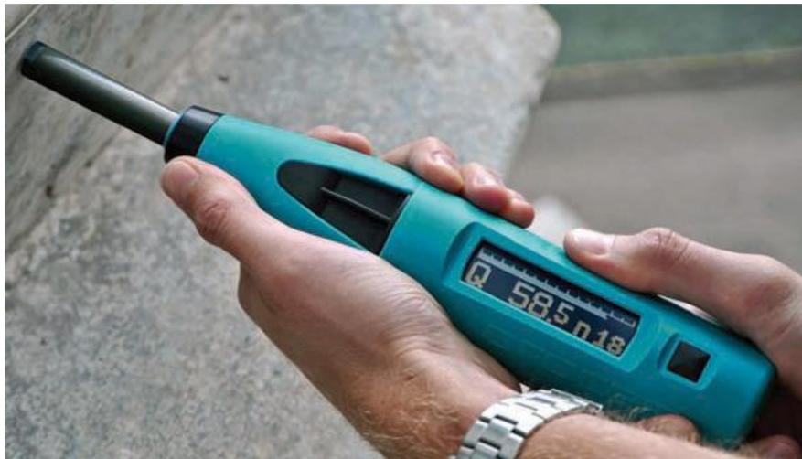
Figura 3-7: Esclerómetro y su aplicación en la técnica de la esclerometría.
