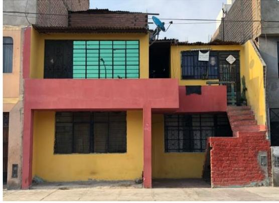
Figura 2-2: Vivienda autoconstruida de dos niveles de albañilería confinada, ubicada en la Av. El Parral, Comas. Fuente: Elaboración propia.
