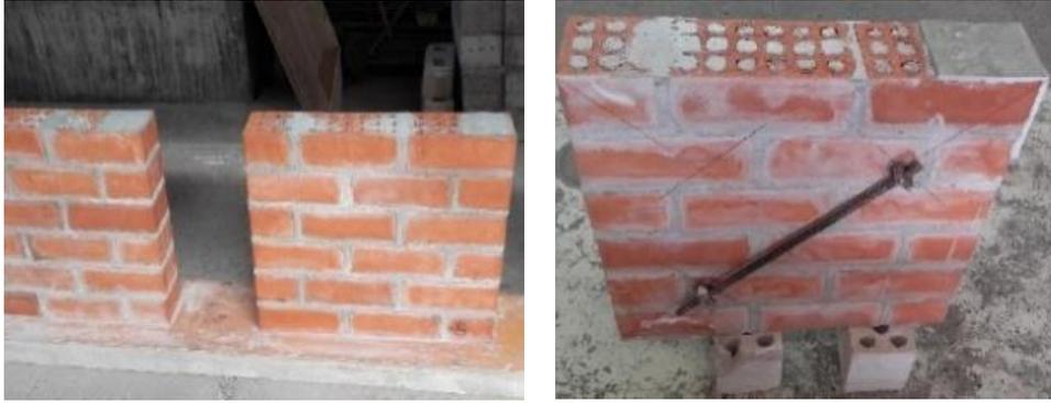
Figura 3-11: Muretes de albañilería de 60cmx60cm y muretes instrumentados. Fuente: Macromodelación numérica de ensayos de pilas y muretes de albañilería de arcilla, Salinas (2017).
