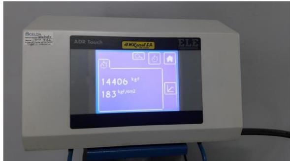
**Concreto reforzado con fibra de acero al 40kg/m<sup>3</sup> (3.2kg/m<sup>3</sup>) a la compresión en cilindro a la edad de 14 días.**
