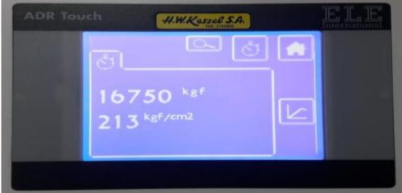
**Concreto reforzado con fibra de acero al 40kg/m<sup>3</sup> (3.2kg/m<sup>3</sup>) a la compresión en cilindro a la edad de 28 días.**
