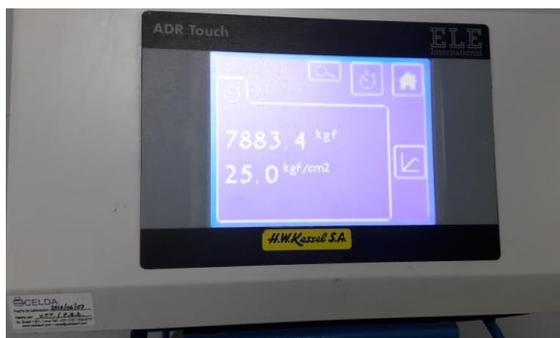
**Concreto reforzado con fibra de acero al 60kg/m<sup>3</sup> (4.8kg/m<sup>3</sup>) a la resistencia a la tracción por flexión a la edad de 7 días**
