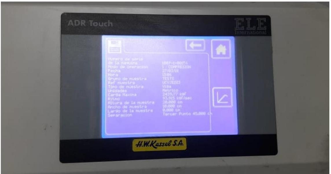
**Concreto reforzado con fibra de acero al 80kg/m<sup>3</sup> (6.4kg/m<sup>3</sup>) del módulo de rotura a la edad de 14 días**
