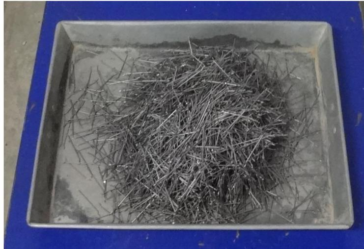
Figura 3-7: Fibras de acero Wirand, usadas en la fabricación de concreto.
