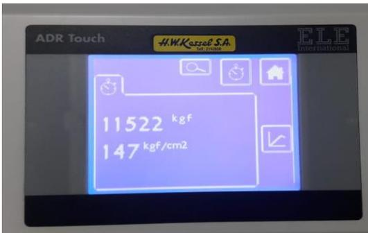
**Concreto reforzado con fibra de acero al 80kg/m<sup>3</sup> (6.4kg/m<sup>3</sup>) a la compresión en cilindro a la edad de 14 días.**
