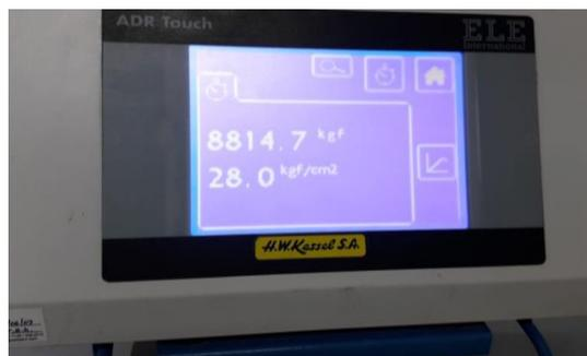
**Concreto reforzado con fibra de acero al 60kg/m<sup>3</sup> (4.8kg/m<sup>3</sup>) a la resistencia a la tracción por flexión a la edad de 28 días**
