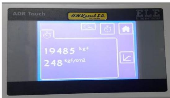
**Concreto reforzado con fibra de acero al 60kg/m<sup>3</sup> (4.8kg/m<sup>3</sup>) a la compresión en cilindro a la edad de 7 días.**
