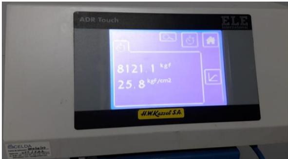
Concreto reforzado con fibra de acero al  $40\text{kg/m}^3$  ( $3.2\text{kg/m}^3$ ) a la resistencia a la tracción por flexión a la edad de 28 días.
