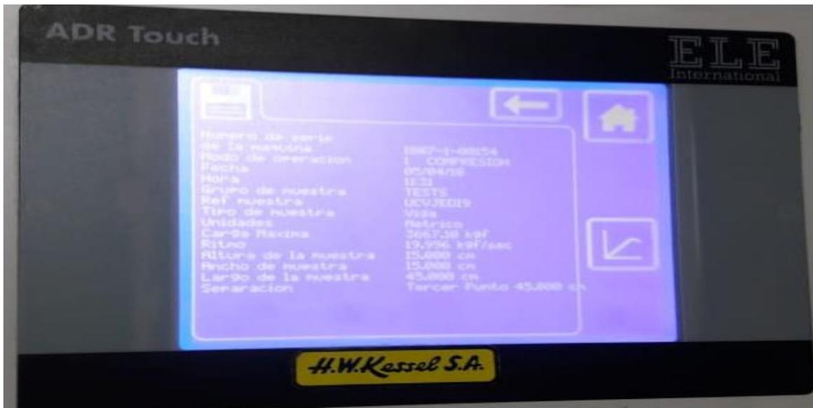
**Concreto reforzado con fibra de acero al 80kg/m<sup>3</sup> (6.4kg/m<sup>3</sup>) del módulo de rotura a la edad de 7 días**
