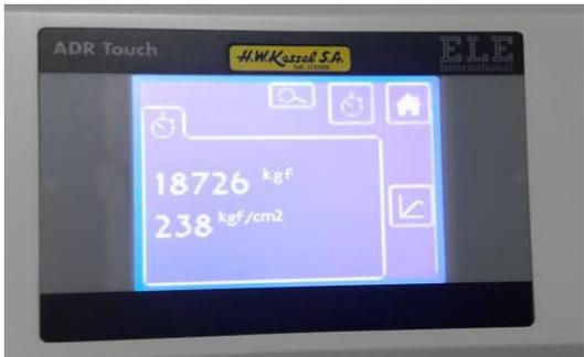
**Concreto reforzado con fibra de acero al 80kg/m<sup>3</sup> (6.4kg/m<sup>3</sup>) a la compresión en cilindro a la edad de 7 días.**
