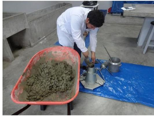
Figura 3-11: Mezclado y medida del slump. Fuente: Elaboración propia.
