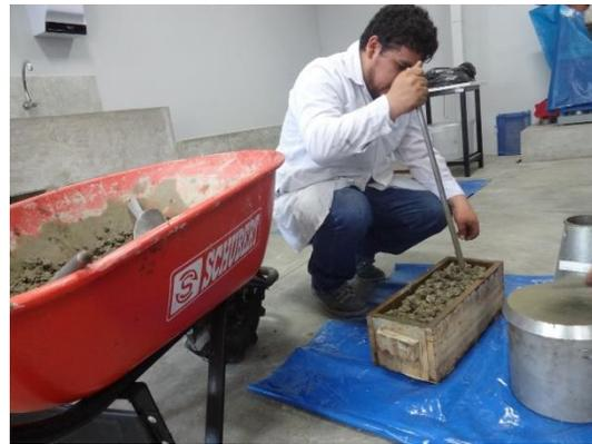
Figura 3-12: Medida del Slump y preparación de vigas. Fuente: Elaboración propia.
