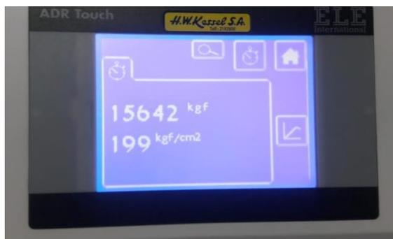
**Concreto reforzado con fibra de acero al 80kg/m<sup>3</sup> (6.4kg/m<sup>3</sup>) a la compresión en cilindro a la edad de 28 días.**
