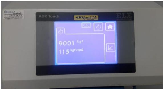
**Concreto reforzado con fibra de acero al 60kg/m<sup>3</sup> (4.8kg/m<sup>3</sup>) a la compresión en cilindro a la edad de 14 días.**
