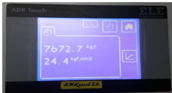
**Concreto reforzado con fibra de acero al 80kg/m<sup>3</sup> (6.4kg/m<sup>3</sup>) a la resistencia a la tracción por flexión a la edad de 14 días**
