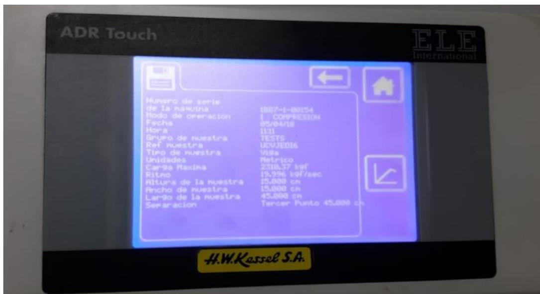
**Concreto reforzado con fibra de acero al 40kg/m<sup>3</sup> (3.2kg/m<sup>3</sup>) del módulo de rotura a la edad de 7 días**
