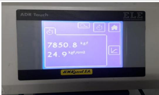
**Concreto reforzado con fibra de acero al 60kg/m<sup>3</sup> (4.8kg/m<sup>3</sup>) a la resistencia a la tracción por flexión a la edad de 14 días**
