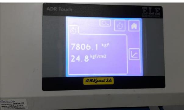
**Concreto simple a la resistencia a la tracción por flexión a la edad de 28 días.**
