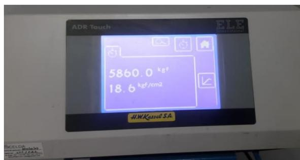
**Concreto reforzado con fibra de acero al 40kg/m<sup>3</sup> (3.2kg/m<sup>3</sup>) a la resistencia a la tracción por flexión a la edad de 14 días.**
