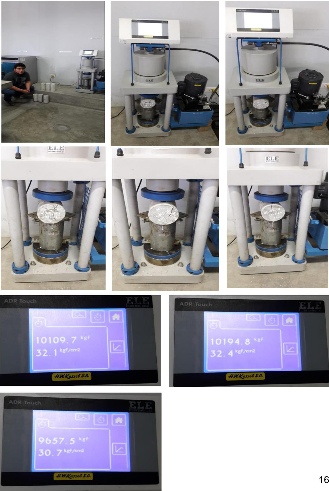
**Concreto reforzado con fibra de acero al 80kg/m<sup>3</sup> (6.4kg/m<sup>3</sup>) a la resistencia a la tracción por flexión a la edad de 28 días**
