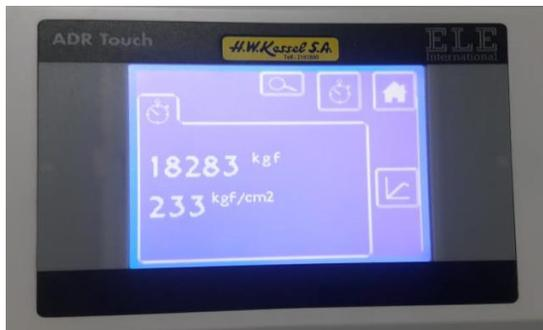
**Concreto reforzado con fibra de acero al 60kg/m<sup>3</sup> (4.8kg/m<sup>3</sup>) a la compresión en cilindro a la edad de 28 días.**
