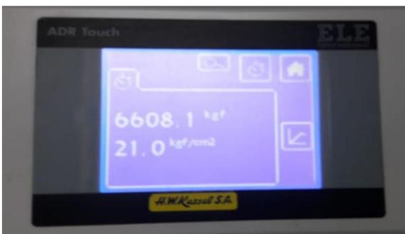
Concreto reforzado con fibra de acero al 40kg/m<sup>3</sup> (3.2kg/m<sup>3</sup>) a la resistencia a la tracción por flexión a la edad de 7 días.
