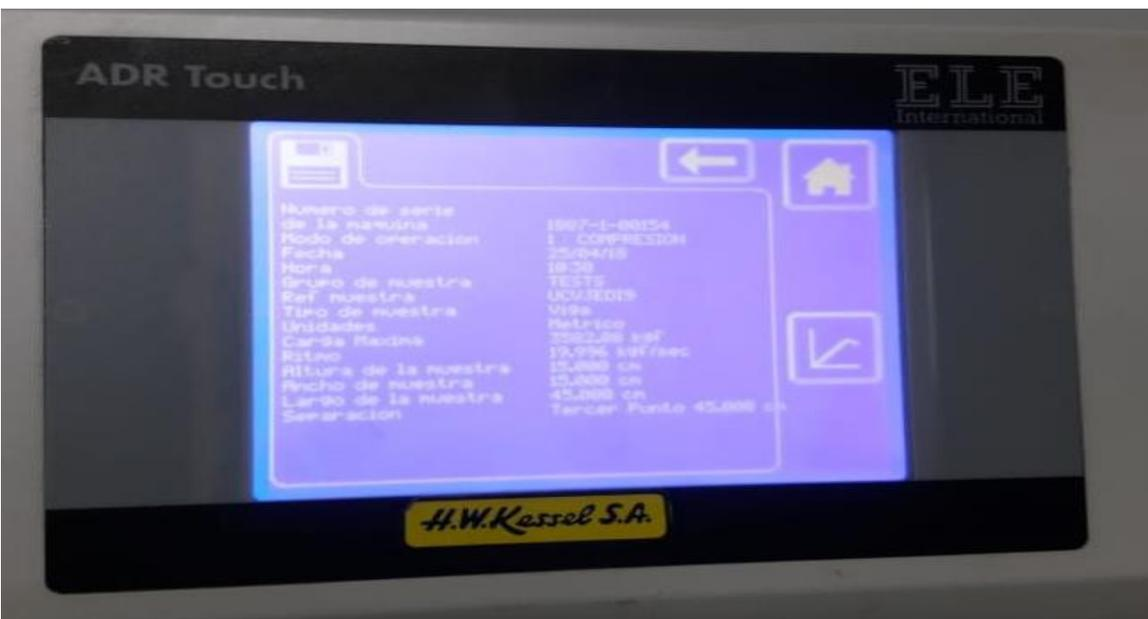
**Concreto reforzado con fibra de acero al 60kg/m<sup>3</sup> (4.8kg/m<sup>3</sup>) del módulo de rotura a la edad de 28 días**
