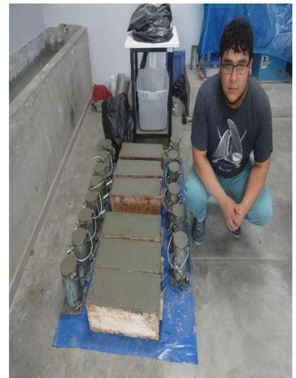
**DISEÑO MUESTRA: CRF3 – 80kg/m<sup>3</sup> (6.4kg/m<sup>3</sup>)**
