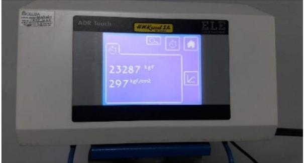
**Concreto reforzado con fibra de acero al 40kg/m<sup>3</sup> (3.2kg/m<sup>3</sup>) a la compresión en cilindro a la edad de 7 días.**
