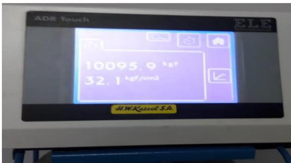
**Concreto reforzado con fibra de acero al 80kg/m<sup>3</sup> (6.4kg/m<sup>3</sup>) a la resistencia a la tracción por flexión a la edad de 7 días**
