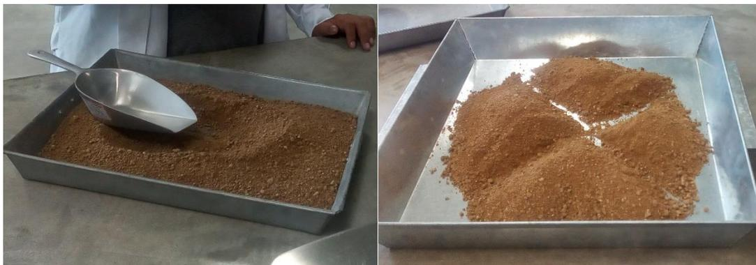
Figura 3-4: Agregado fino usado para el diseño de mezclas. Fuente: Elaboración propia.
