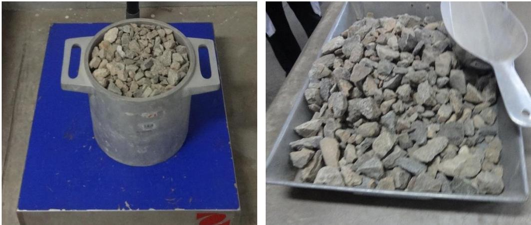
Figura 3-1: Agregado grueso usado en el diseño de mezclas. Fuente:
