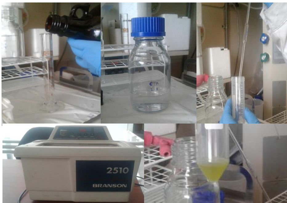
Figura N° 9. Preparación de la mezcla Cloroformo: metanol (2:1). Fuente: Elaboración propia
