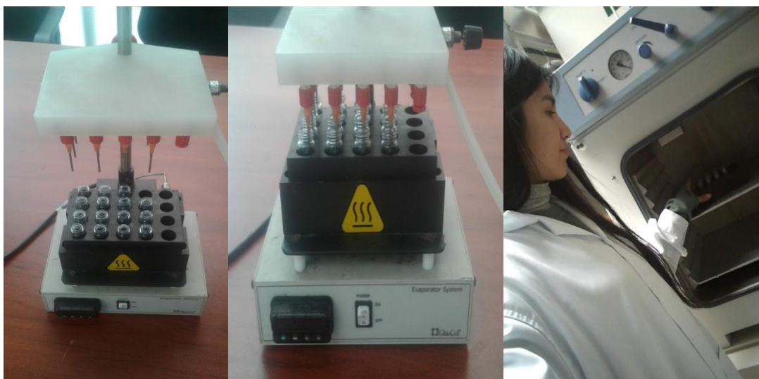
Figura N° 13. Secado con evaporador/concentrador y estufa de vacío. Fuente: Elaboración propia
