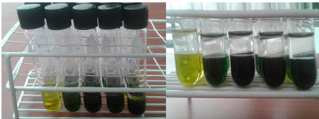
Figura N° 12. Separación de fases Cloroformo: metanol. Fuente: Elaboración propia.
