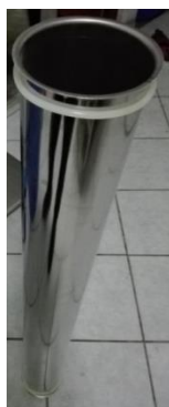
Figura 4. Protector de la membrana de Nanofiltración capa de acero inoxidable de forma tubular
