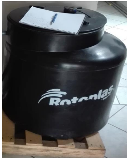
Figura 8. Tanque para recolección del agua residual de 250 L
