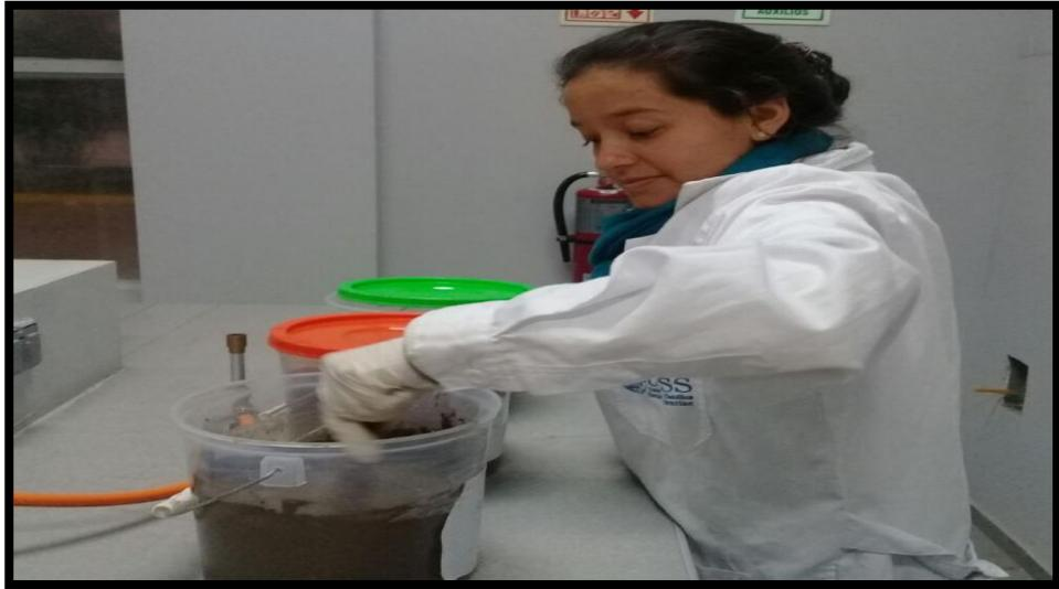
**Figura N°12. Mezcla homogénea de la muestra con nanopartículas.**
