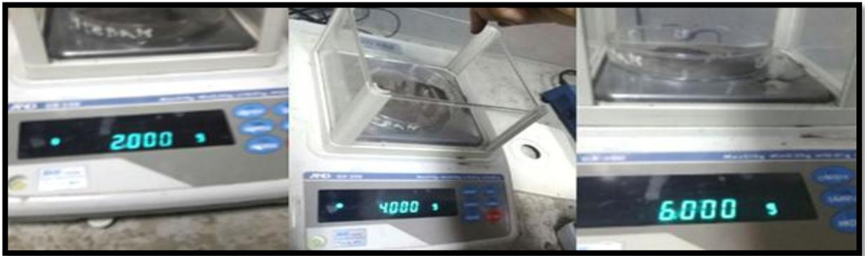
Figura N°09: Peso inicial de las nanoparticulas de hierro en concentraciones de 2mg, 4mg y 6mg.
