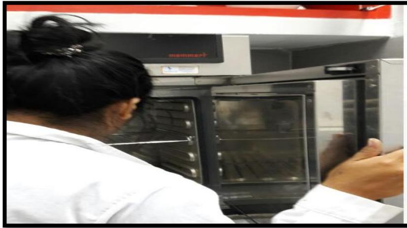
Figura N° 13. Introdujimos a la estufa de secado la muestra.
