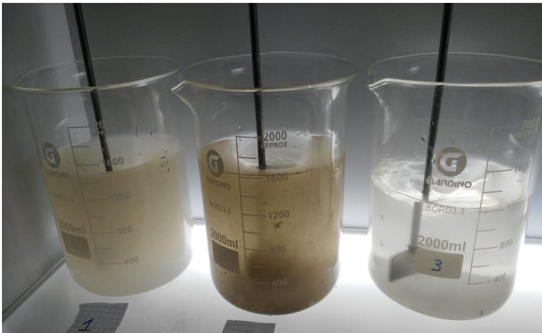
Figura N° 9: Prueba de Jarras para el tratamiento
