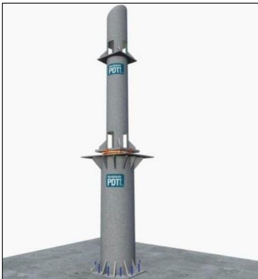
Ilustración 85. Columna tubular circular rellena de concreto.
