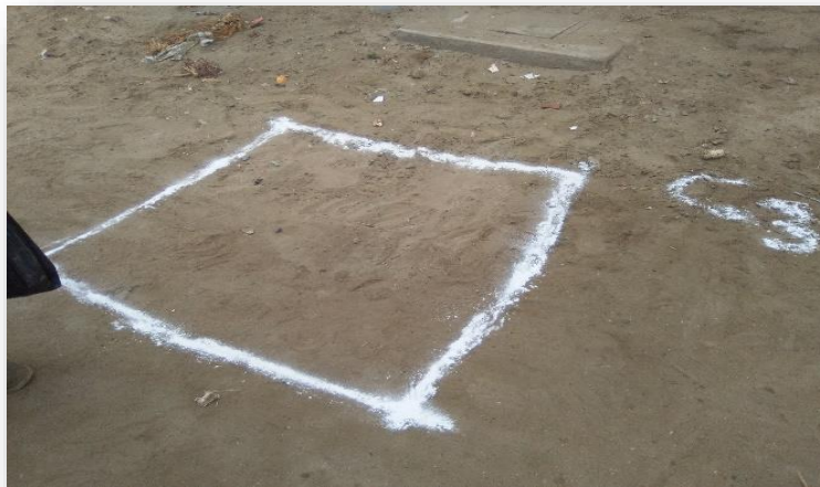
Foto N°138: Marcando el área de la calicata N°3 ubicado en la Calle Los Laureles del Sector II, para la extracción de muestra.
