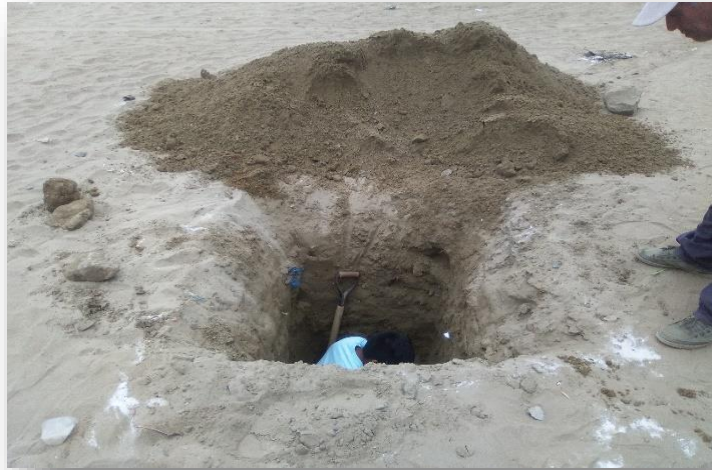
Foto N°141: Sacando la muestra de la Calicata N°2 ubicado en la Calle Los Laureles del Sector I.
