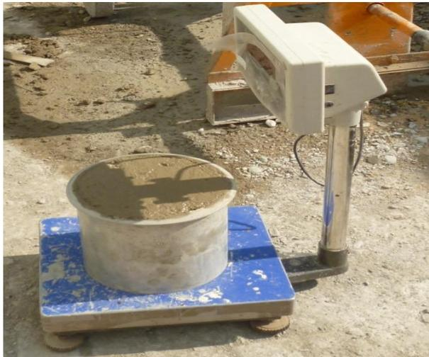
6 Figura 6. Ensayo de peso unitario
