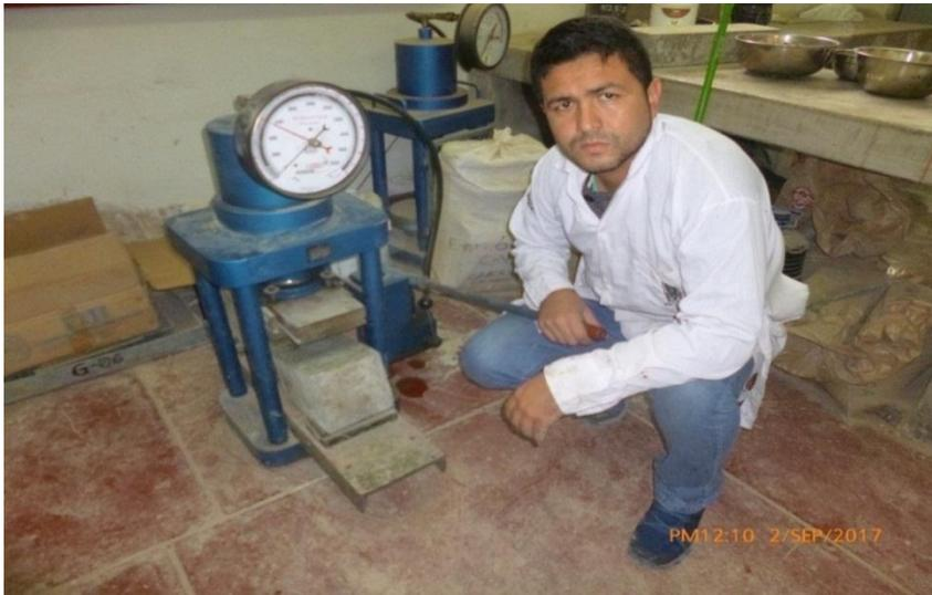
29 Figura 29. Ensayo de la viga patrón de 28 MPa
