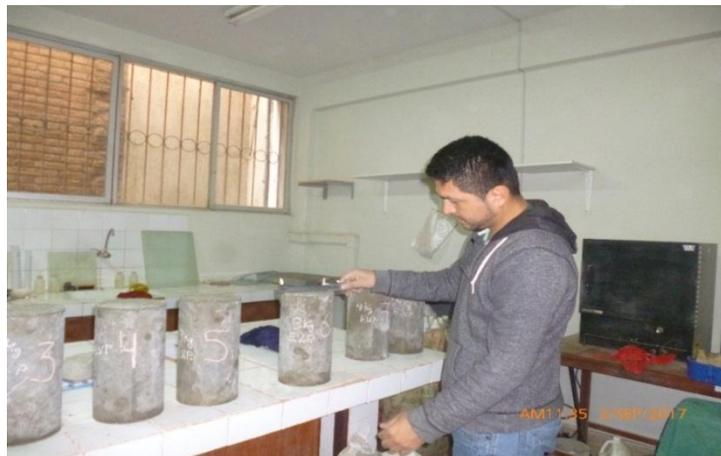
8 Figura 8. Probetas 28 MPa con adición de fibras de polipropileno listas para ensayar.
