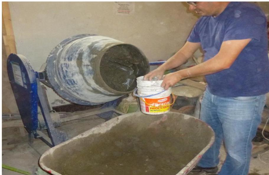
**Ensayo de asentamiento de 28 MPa con adición de 3 kg/m<sup>3</sup> de fibra**
