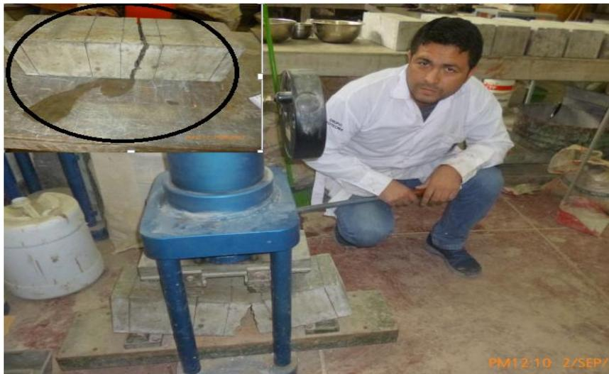
30 Figura 30. Resistencia a la flexión o módulo de rotura del concreto patrón
