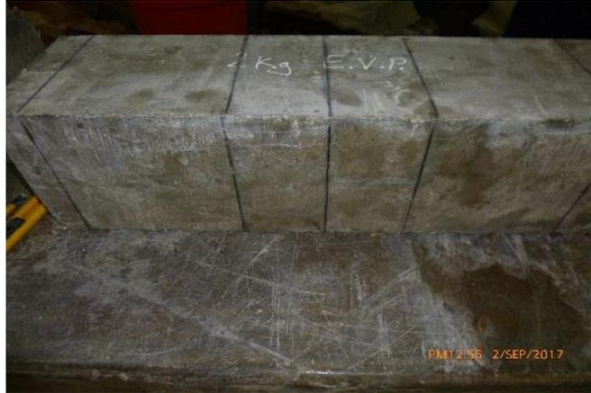
12 Figura 12. Viga de concreto con resistencia a la compresión de 28 MPa con 2 kg/m<sup>3</sup> de: 6 x 6 x 21”.
