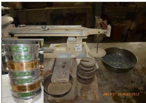
19 Figura 19. Tamices, n° 2 hasta la malla N° 4 para el agregado grueso.
