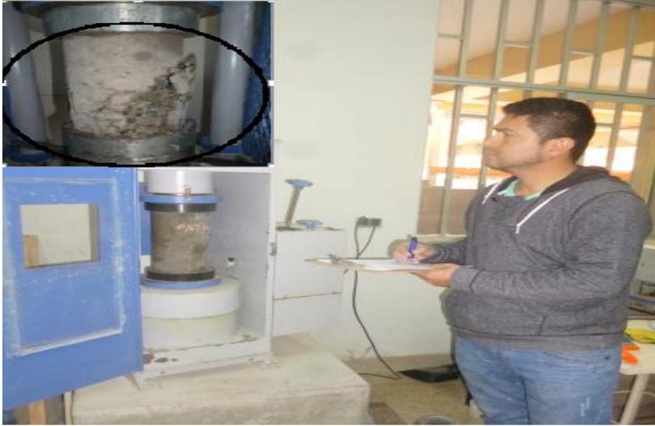
27 *Figura 27.* Fractura de espécimen patrón de 28 MPa, fractura tipo 1 tal como se muestra en la figura N° 9.
