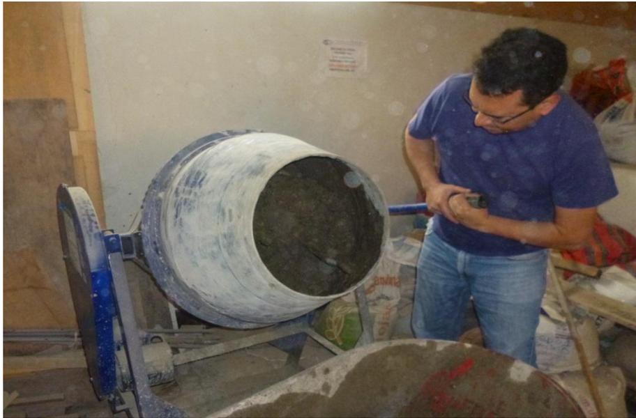
**Diseño de mezcla de concreto 28 MPa con adición de 3 k/m3 de fibra**
