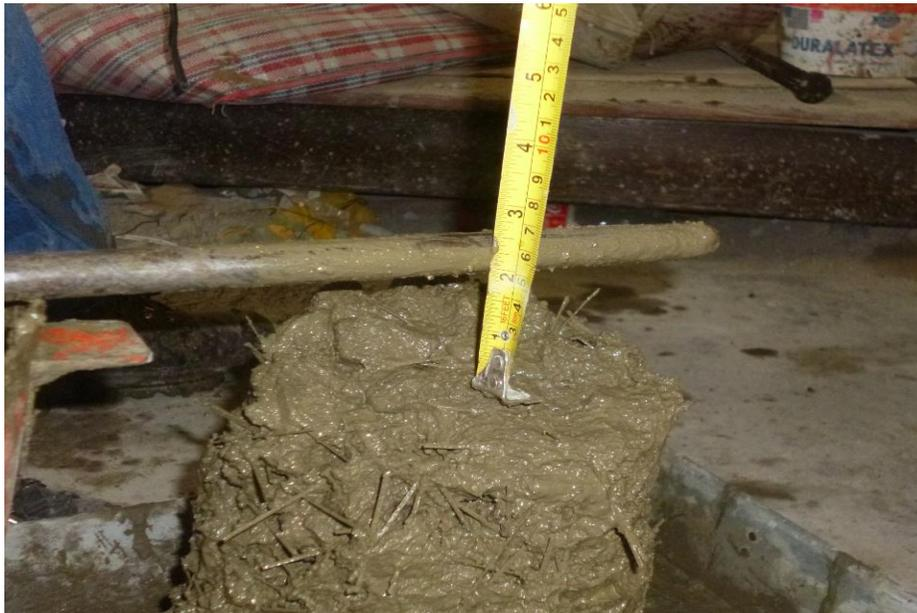
**Especímen de 28 MPa con adición de 3 kg/m<sup>3</sup> de fibra**
