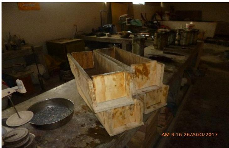
11 Figura 11. Moldes de madera para vigas de: 6 x 6 x 21”
