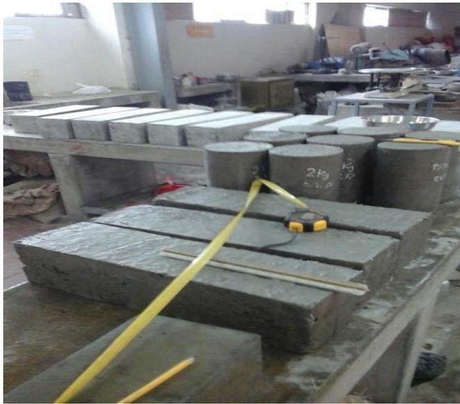
14 *Figura 14.* Vigas de 28 MPa con fibra de polipropileno.
