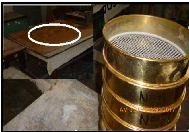
17 Figura 17. Tamices, n° 4 hasta la malla N° 100 para el agregado fino.
