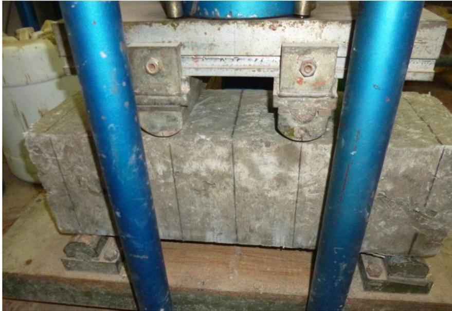
**Resultado obtenido en el equipo de ensayo a flexión por tracción en los tercios de la luz para viga con 4 kg/m<sup>3</sup> de concreto.**
