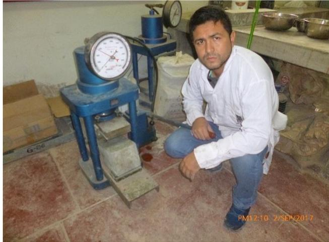
16 Figura 16. Equipo para ensayo a la flexión.
