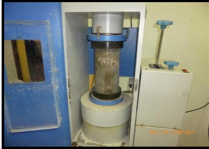
7 Figura 7. Prensa hidráulica (Especimen patrón 28 MPa)
