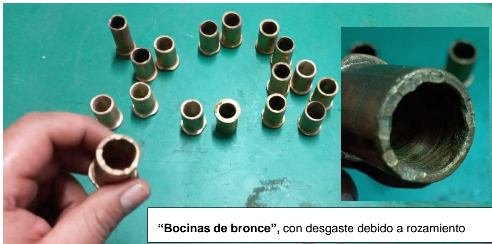
Figura 57. Revisión de bocinas de bronce en cuchara cosechadora Fuente: Elaboración propia
