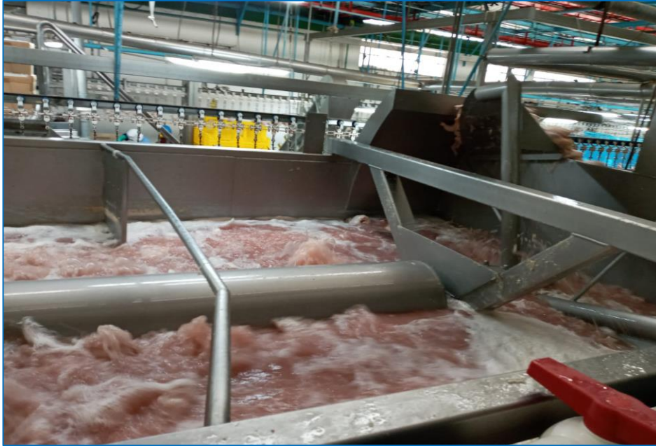
Figura. 18: Pre chiller Fuente: Elaboración propia.
