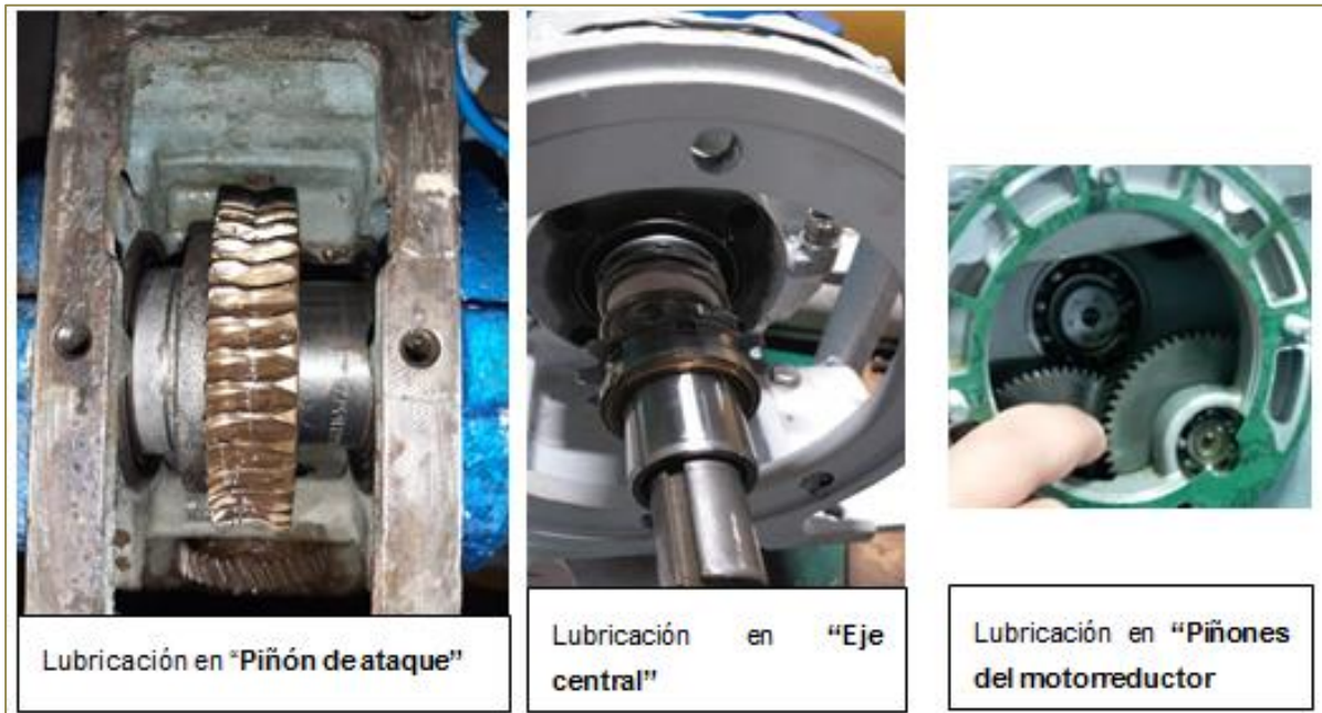
Figura 55. Lubricación del sistema de transmisión Fuente: Elaboración propia
