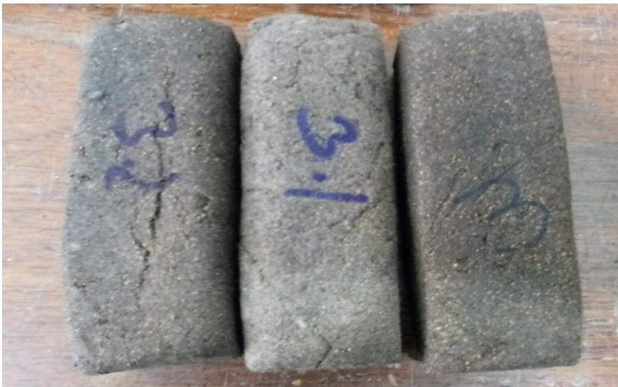
Figura 13: Madera ecológica (80 % de cascaras de castaña y 20% de periódico reciclado), 3 muestras para Ensayo de Resistencia a la Compresión Perpendicular Fuente: Foto tomada el 29/06/2018, por el autor.
