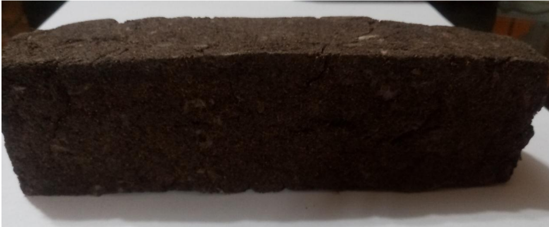
Figura 3: Madera ecológica (pre- tratamiento)-(50% de cascara de castaña y 50% de periódico reciclado)
