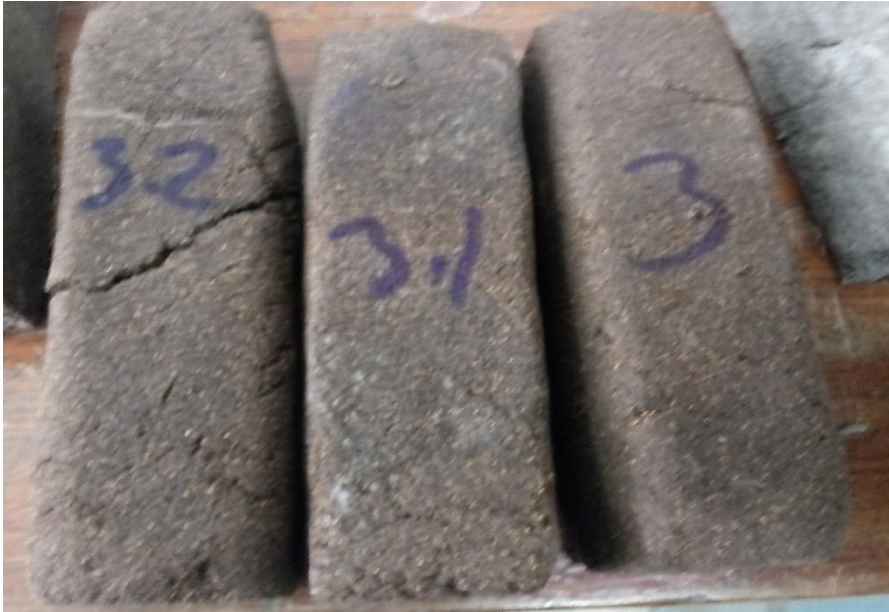
Figura 12: Madera ecológica (80 % de cascaras de castaña y 20% de periódico reciclado) ,3 muestras para Ensayo de Flexión en Vigas de Madera. Fuente: Foto tomada el 29/06/2018, por el autor.
