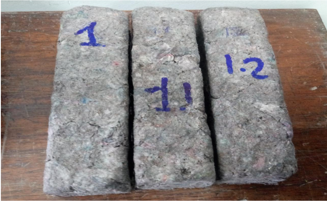
Figura 15: Madera ecológica (20 % de cascavas de castaña y 80% de periódico reciclado) ,3 muestras para Ensayo de Flexión en Vigas de Madera. Fuente: Foto tomada el 29/06/2018, por el autor.
