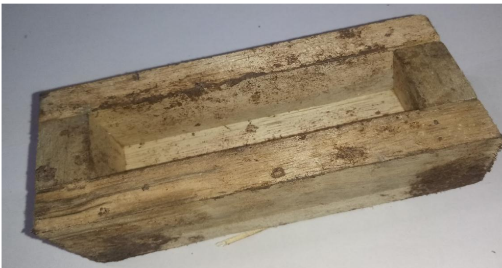
Figura 8: Molde de madera de 13.5 x 6.5 x 4.5 cm. Fuente: Foto tomada el 01/06/2018, por el autor.
