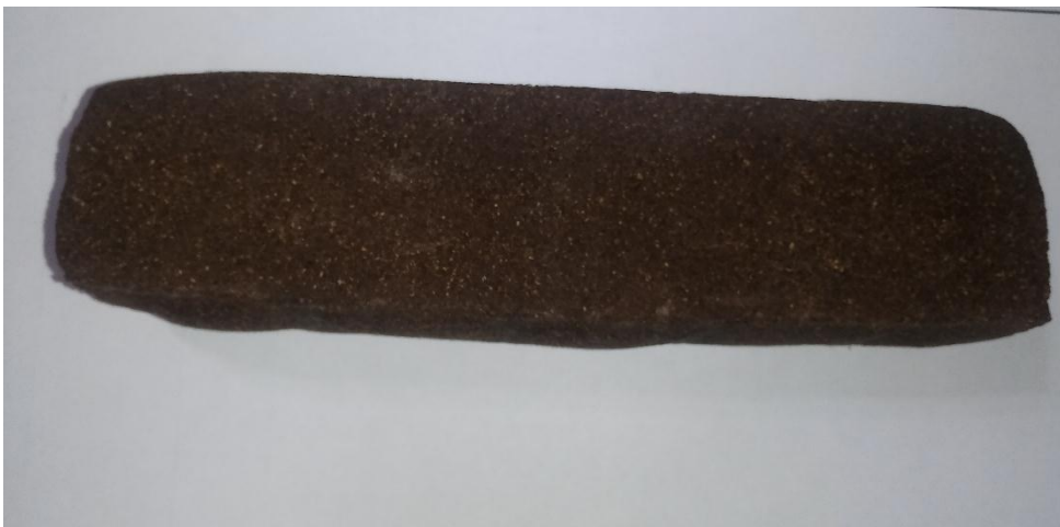
Figura 4: Madera ecológica (pre tratamiento)- (80 % de cascara de castaña y 20 % de periódico reciclado)
