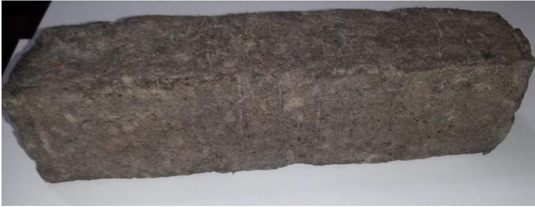
Figura 5: Madera ecológica (pre tratamiento)- (20 % de cascara de castaña y 80% de periódico reciclado)
