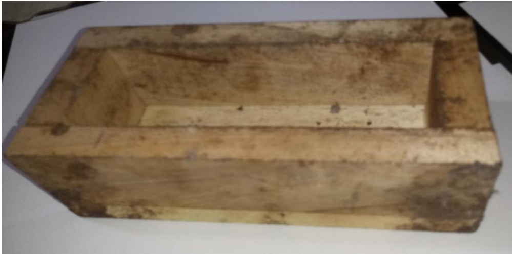
Figura 7: Molde de madera de 19 x 9 x 6.5 cm Fuente: Foto tomada el 01/06/2018, por el autor.
