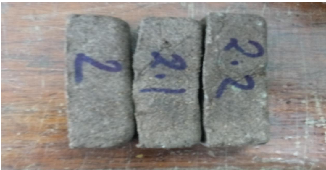
Figura 9: Madera ecológica (50 % de cascara de castaña y 50% de periódico reciclado) ,3 muestras para Ensayo de Flexión en Vigas de Madera. Fuente: Foto tomada el 29/06/2018, por el autor.
