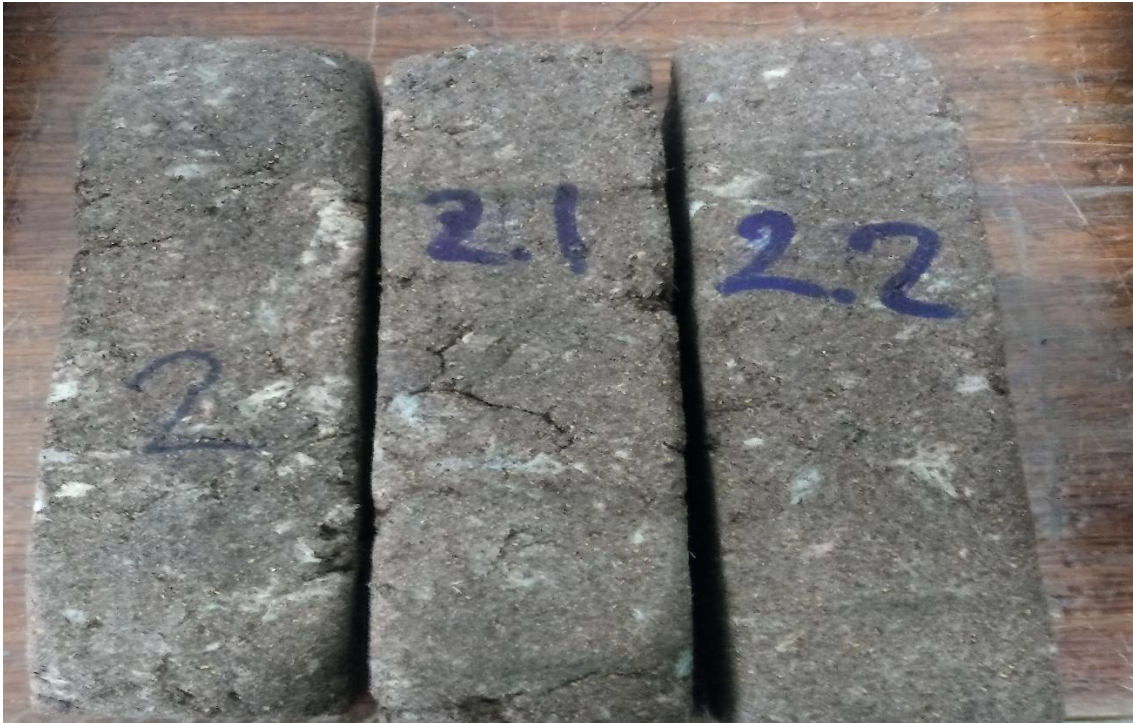
Figura 9: Madera ecológica (50 % de cascara de castaña y 50% de periódico reciclado) ,3 muestras para Ensayo de Flexión en Vigas de Madera. Fuente: Foto tomada el 29/06/2018, por el autor.
