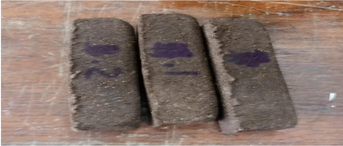
Figura 14: Madera ecológica (80 % de cascaras de castaña y 20% de periódico reciclado) ,3 muestras para Ensayo de Densidad de Maderas.
