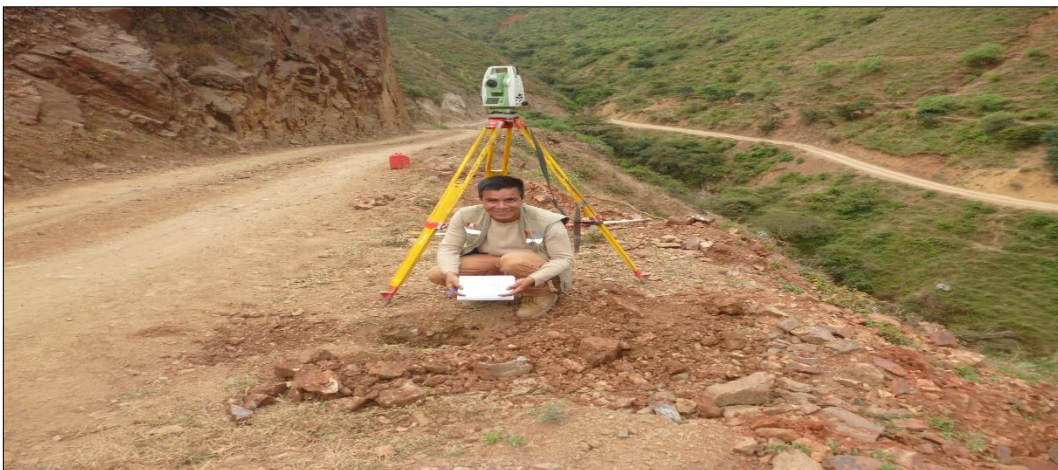
Levantamiento topográfico con estación total
