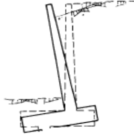
Figura 17: Giro excesivo del muro
