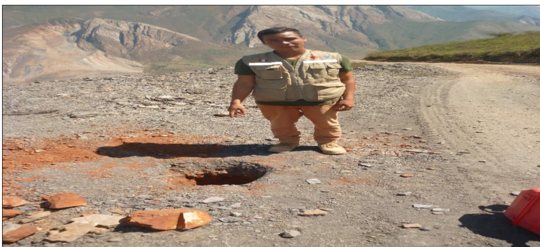
Extracción de estratos para el estudio de suelos
