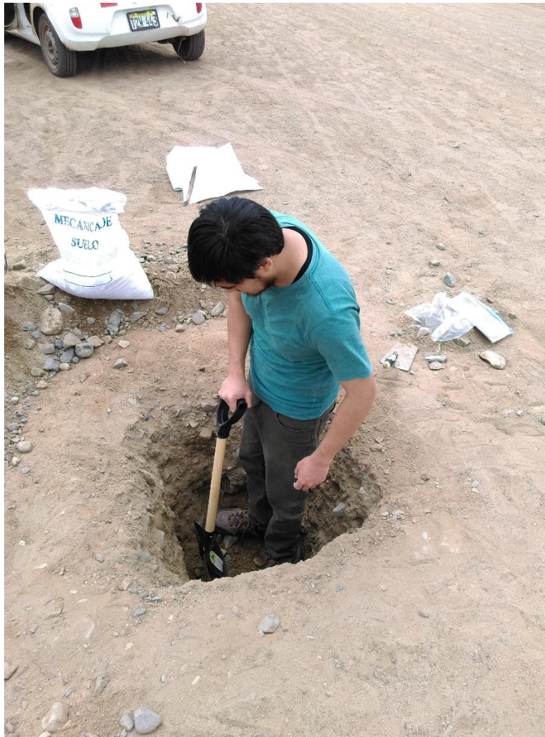
Excavación de calicatas
