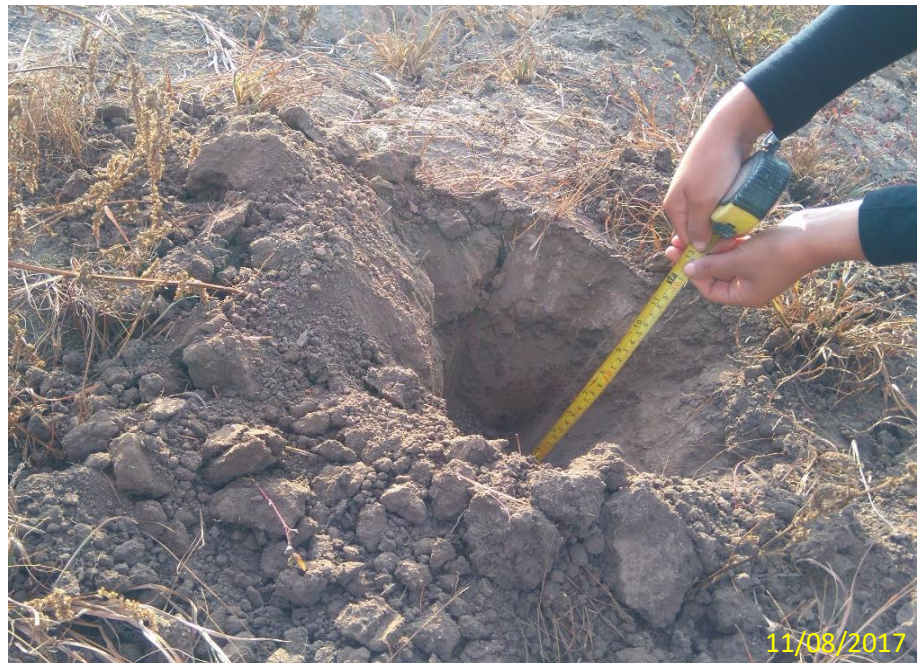
Foto 4. Calicata de 30 x 30 y 30 cm de profundidad.
