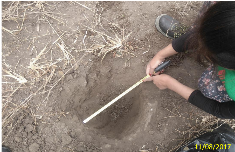
Foto 3. Calicata de 30 x 30 y 30 cm de profundidad.
